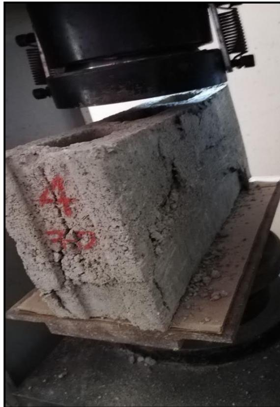
**Figura 34.**Rotura del bloque MP.
