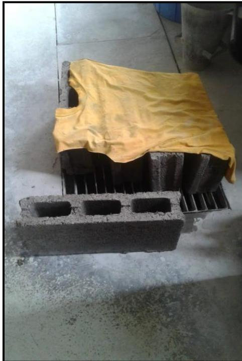
**Figura 37.** Ecurrimiento y secado superficial de la muestra.
