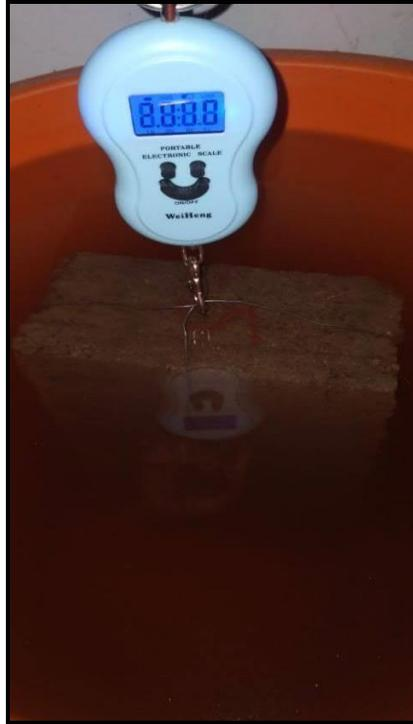
**Figura 36.** Masa de la muestra sumergida.
