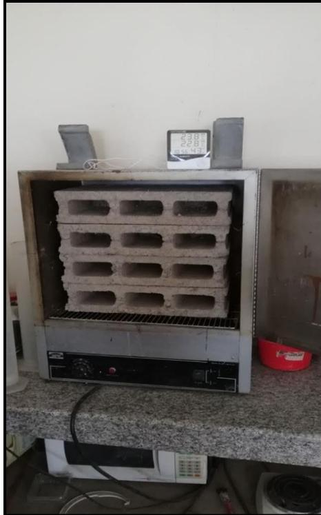
**Figura 38.** Muestra seca al horno.
