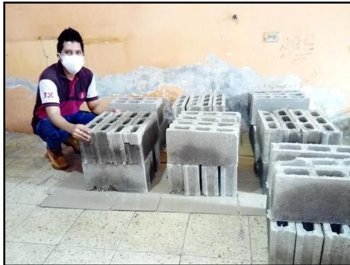
**Figura 30.**Elaboración de 40 bloques de cemento con madera pulpable.
