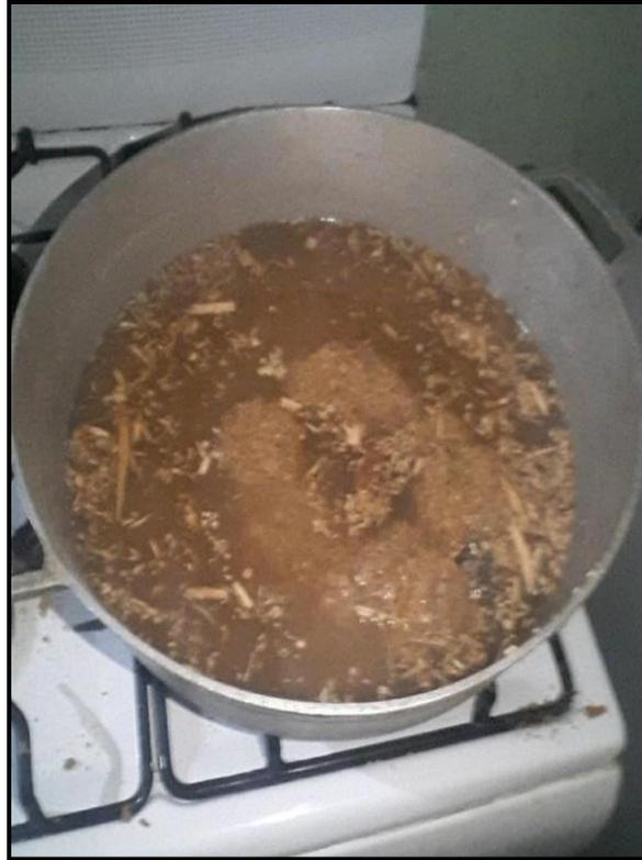
**Figura 13.**Cocción de residuos de madera para librarlos de impurezas.
