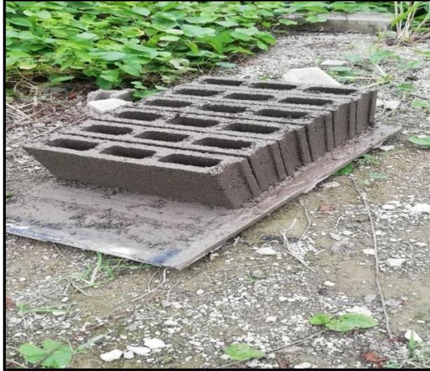
**Figura 27.**Desmolde y transporte del bloque.
