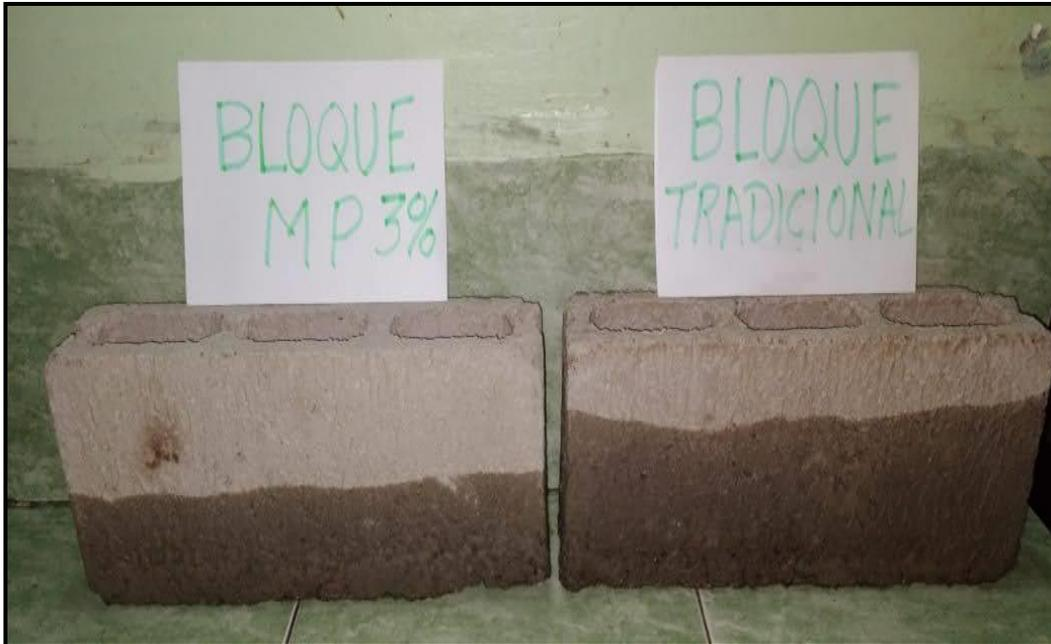
**Figura 40.** Comparación de absorción capilar entre bloque MP 3% y el bloque tradicional.
