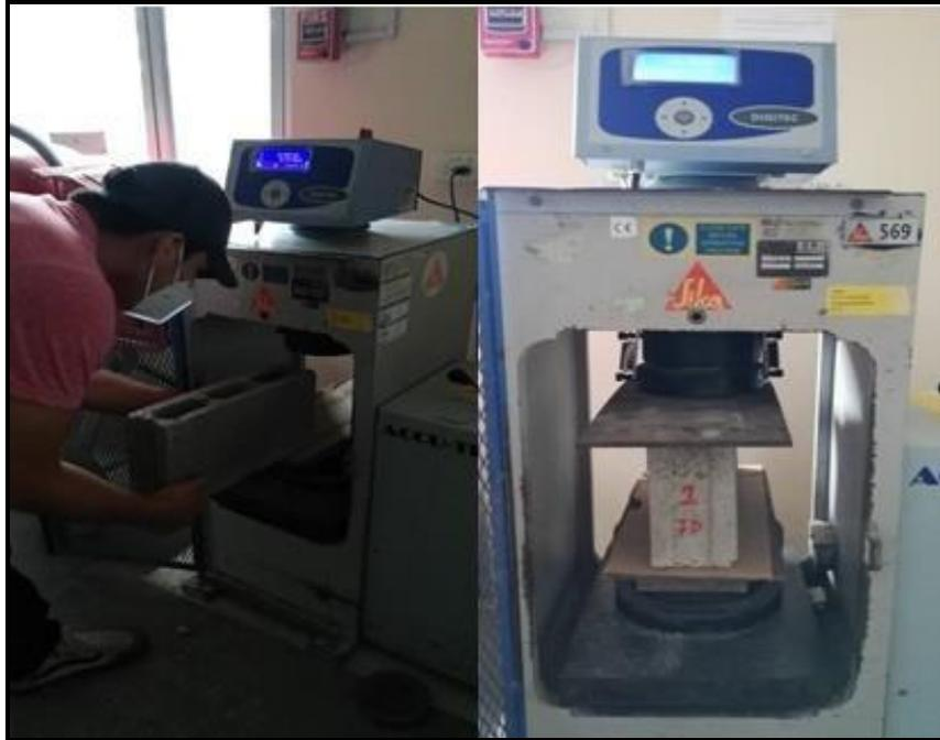
**Figura 33.**Colocación del bloque MP entre las 2 placas antes de su rotura.
