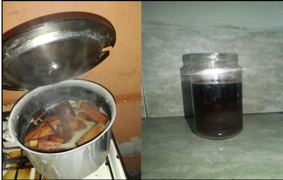
**Figura 15.**Cocción de la mezcla de hidróxido de sodio con agua y los residuos de madera / la sustancia oscura (lignina resultante).
