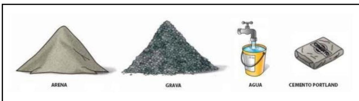
**Figura 2.** Materiales para fabricación de bloques.
