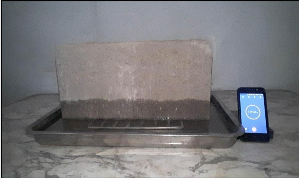
**Figura 39.**Ensayo de absorción capilar aplicado a bloques MP.
