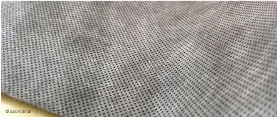
Figura 7: Lámina impermeable transpirable Fuente: EcoHabitat (2019)
