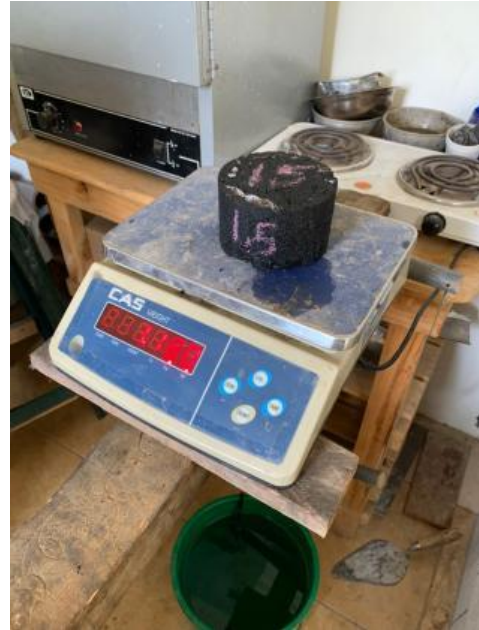
Figura 37. Determinando el peso superficialmente saturado seco de las briquetas para determinar Densidad Bulk.
