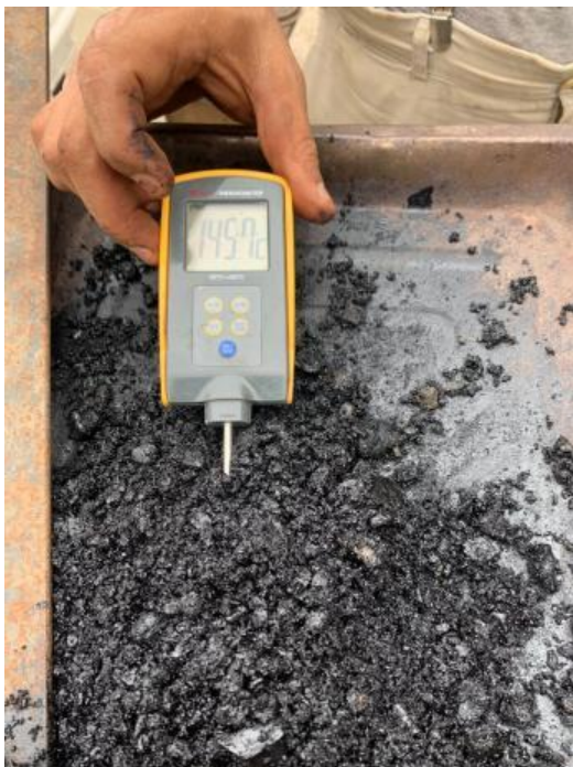
Figura 27. Medición de temperatura de la combinación entre mezcla asfáltica reciclada con el porcentaje de cemento asfáltico nuevo. Elaborado por: Castillo & Yamasqui (2022)
