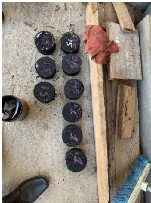
Figura 35. Briquetas elaboradas por la mezcla asfáltica reciclada con el aceite de motor reciclado Elaborado por: Castillo & Yamasqui (2022)
