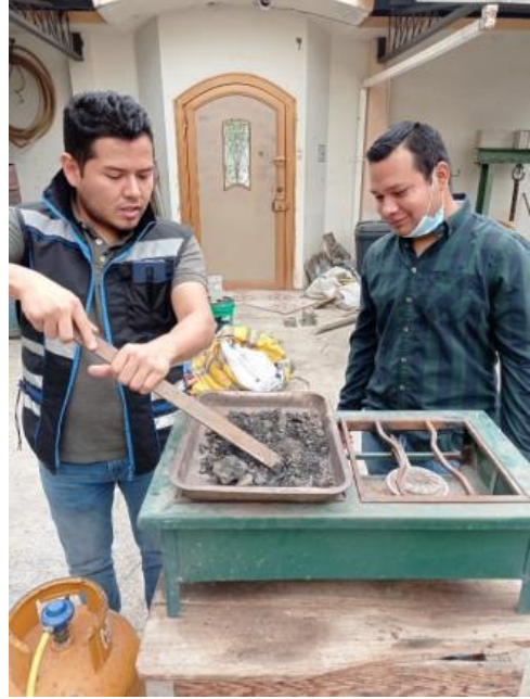
Figura 26. Combinación entre la mezcla asfáltica reciclada con el porcentaje de cemento asfáltico nuevo a temperatura de diseño Elaborado por: Castillo & Yamasqui (2022)
