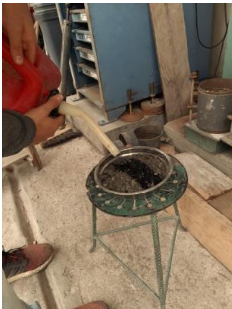
Figura 23. Añadiendo gasolina a la mezcla asfáltica reciclada Elaborado por: Castillo & Yamasqui (2022)
