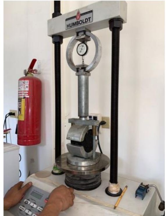
Figura 39. Colocación de la briqueta en las mordazas de la Prensa Marshall
