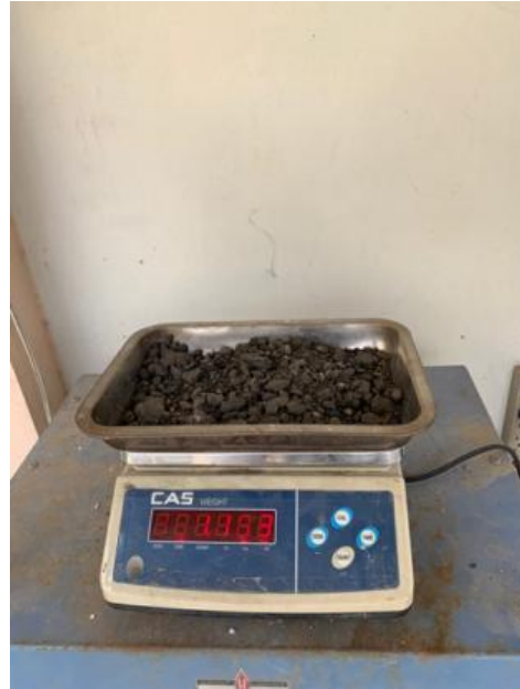
Figura 31. Pesaje de la mezcla asfáltica reciclada
