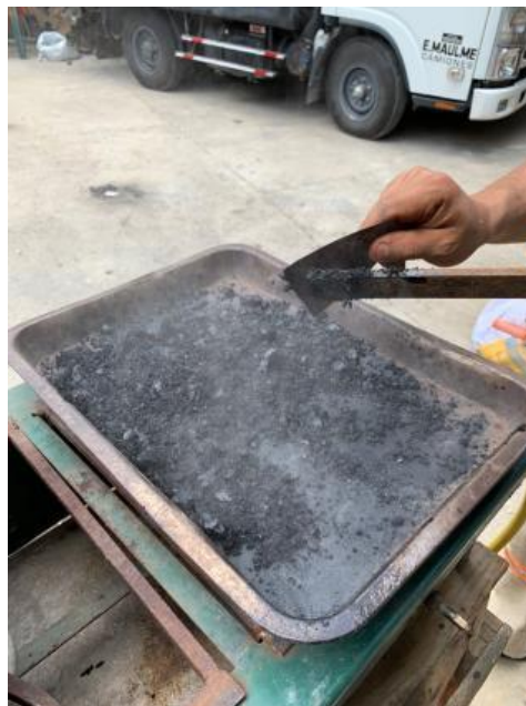
Figura 34. Combinación entre la mezcla asfáltica reciclada con el aceite de motor reciclado. Elaborado por: Castillo & Yamasqui (2022)
