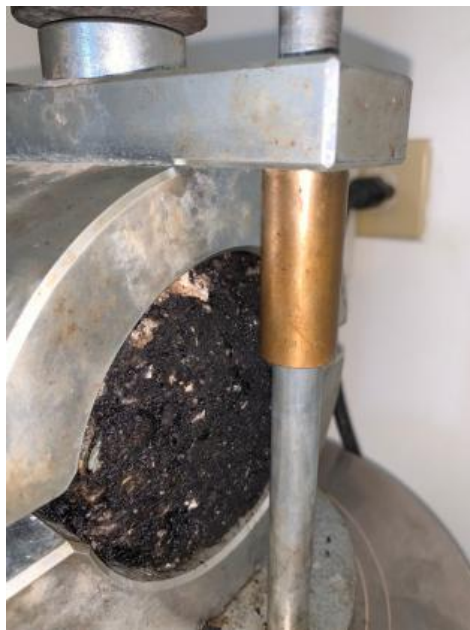
Figura 40. Briqueta siendo deformada por la Prensa Mecánica Marshall
