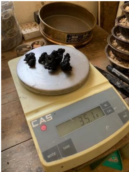
Figura 30. Pesaje del cemento asfáltico nuevo.
