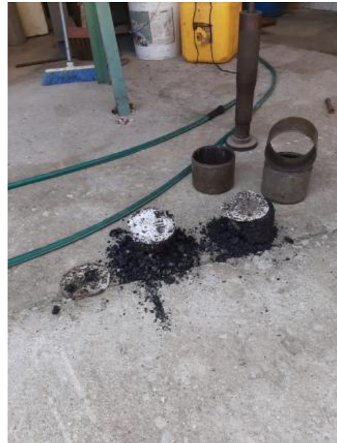
Figura 22. Briquetas de la mezcla asfáltica reciclada se evidencia falta de cohesión Elaborado por: Castillo & Yamasqui (2022)
