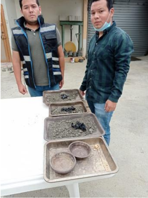
Figura 25. Dosificación base para realizar la mezcla asfáltica reciclada con el cemento asfáltico nuevo. Elaborado por: Castillo & Yamasqui (2022)
