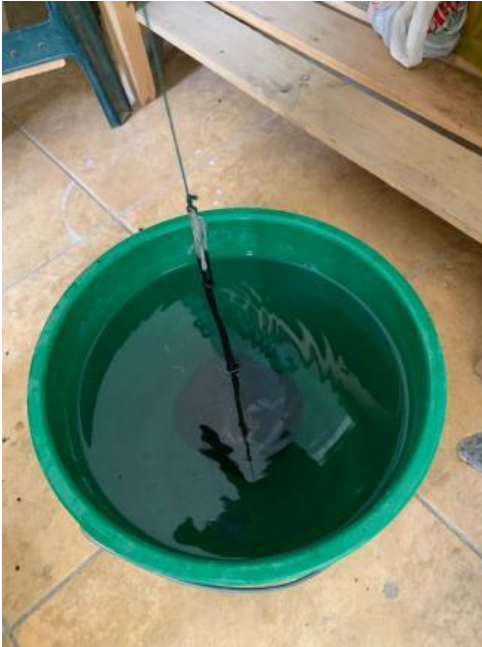
Figura 36. Determinando el peso en el agua de las briquetas para determinar Densidad Bulk.
