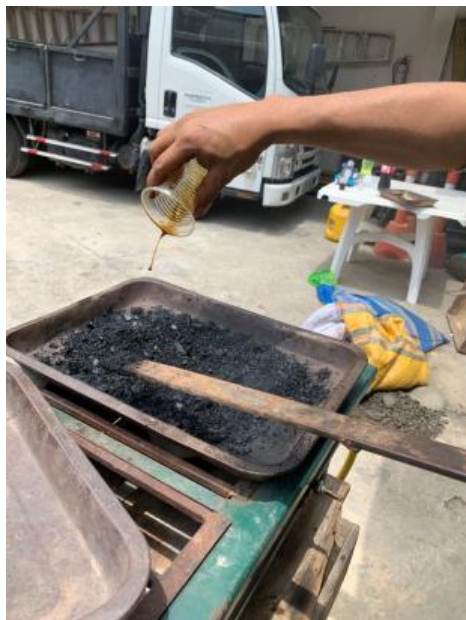
Figura 33. Incorporación del aceite de motor reciclado en la mezcla asfáltica reciclada. Elaborado por: Castillo & Yamasqui (2022)
