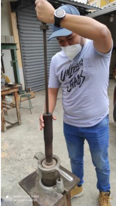
Figura 21. Compactación de la mezcla asfáltica reciclada Elaborado por: Castillo & Yamasqui (2022)
