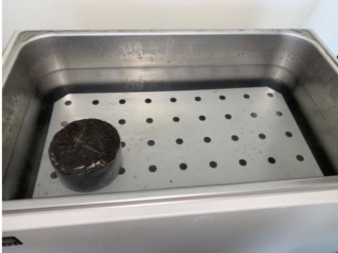
Figura 38. Reposo de las briquetas en el baño maría dentro de un lapso de 35 minutos
