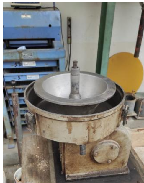
Figura 24. Extractor centrifugo de asfalto Elaborado por: Castillo & Yamasqui (2022)
