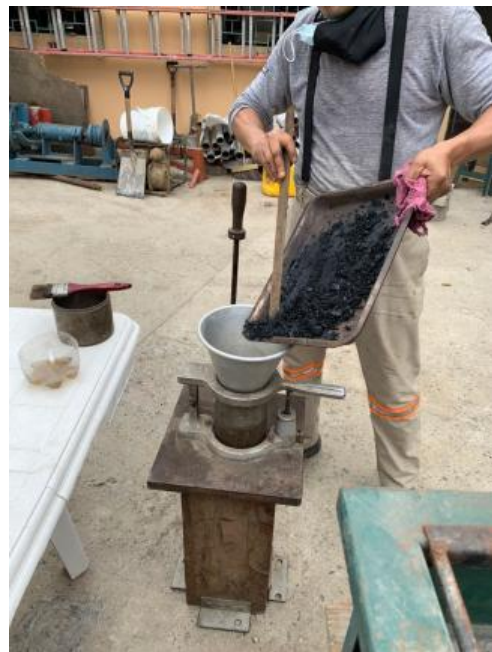
Figura 28. Colocación de la combinación entre mezcla asfáltica reciclada con el porcentaje de cemento asfáltico nuevo en el molde para realizar la compactación. Elaborado por: Castillo & Yamasqui (2022)
