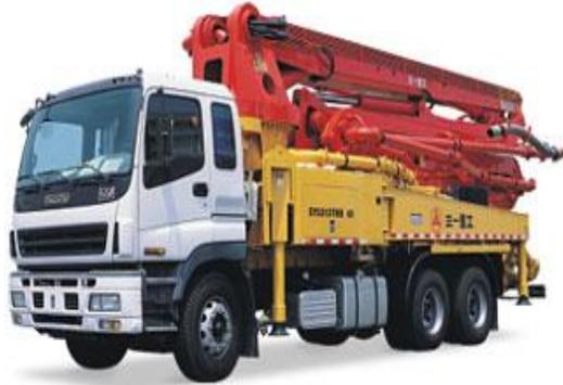
Figura 44. Camión bomba y pluma.
