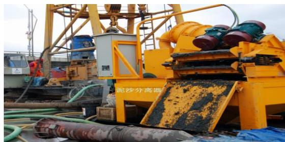
Figura 26. cicladora para el desalajo del lodo de perforación.
