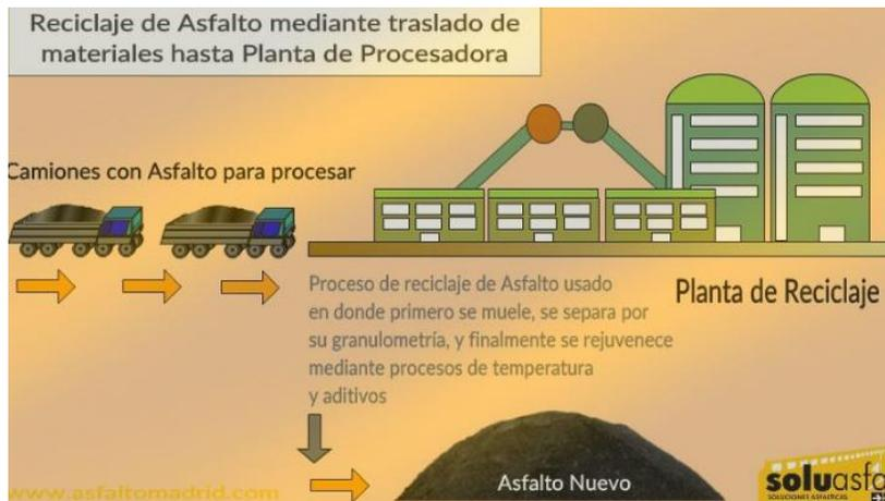
**Figura 52:** Asfalto Reciclado en planta
