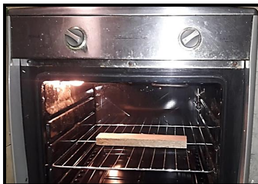
Figura 78. Muestra en el horno a 200° Celsius Elaborado por: Borja F (2021)
