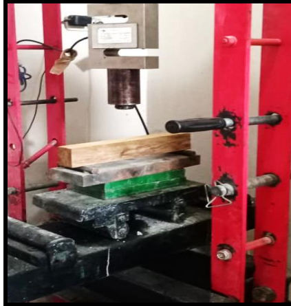
Figura 85. Muestra antes de la prueba de flexión Elaborado por: Borja F (2021)
