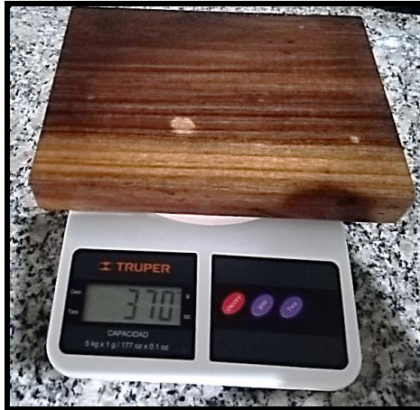
Figura 67. Quinta etapa de la prueba de humedad Elaborado por: Borja F (2021)
