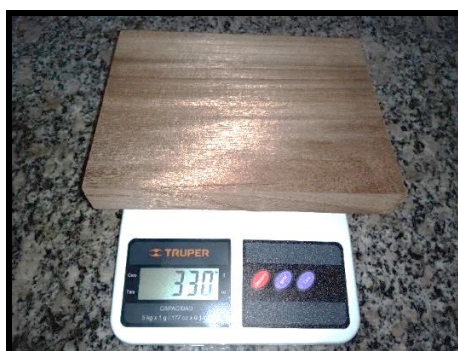
Figura 66. Peso de la muestra después de 24 horas en el agua Elaborado por: Borja F (2021)
