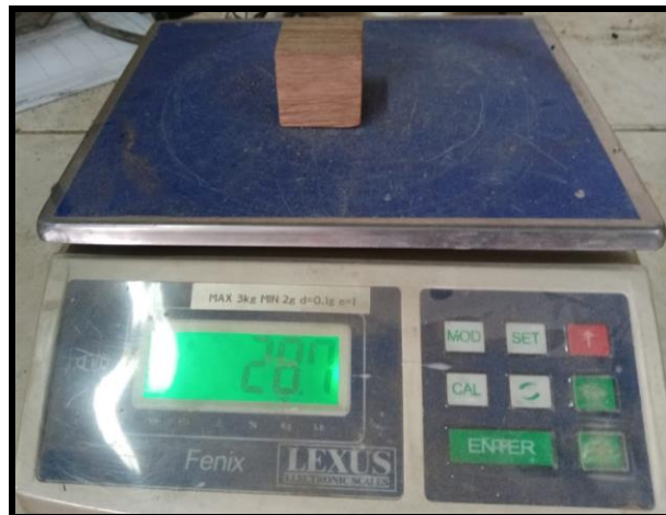
Figura 80. Toma del peso de la muestra Elaborado por: Borja F (2021)
