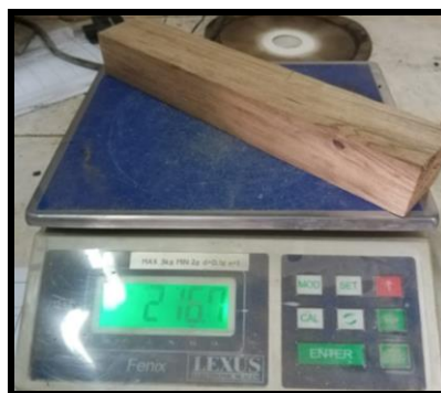
Figura 84. Toma del peso de la muestra Elaborado por: Borja F (2021)
