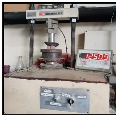
Figura 82. Muestra después de la compresión Elaborado por: Borja F (2021)
