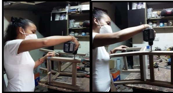
Figura 59. Colocación de los travesaños del respaldar y el apoya pies Elaborado por: Borja F (2021)
