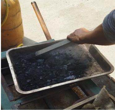
**Figura 12:** *Mezcla en caliente dosificada*
