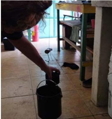
**Figura 19:** *Peso de probetas en agua.*
