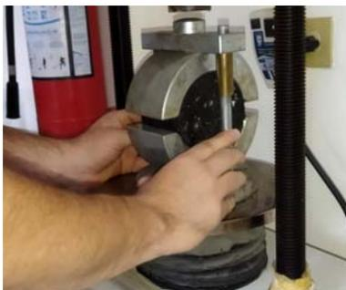
**Figura 21:** *Colocación de probeta en la mordaza para su respectivo ensayo.*
