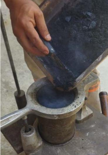
**Figura 14:** *Vertiendo la mezcla en el molde*
