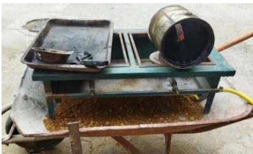
**Figura 7:** Equipos para la elaboración de briqueta (ensayo Marshall)
