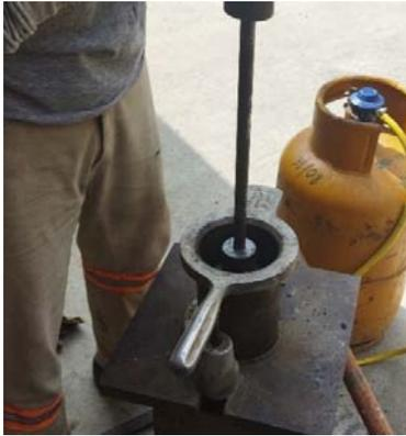
**Figura 16:** *Compactación a 75 golpes por cada cara de la probeta.*
