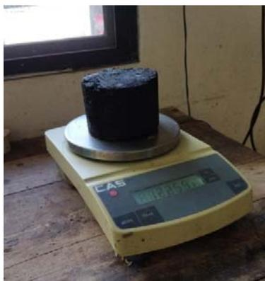
**Figura 18:** *Peso de probetas secas en aire luego de 2 horas desde su fabricación.*
