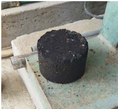
**Figura 17:** *Probetas secas en aire luego de 2 horas desde su fabricación.*
