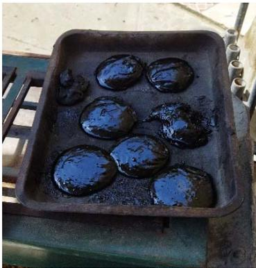
**Figura 9:** *Asfalto en caliente dosificada*
