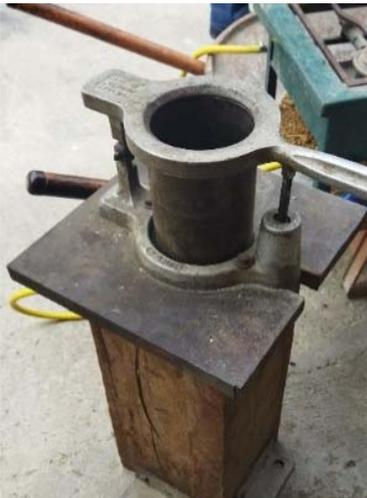
**Figura 13:** *Base de compactación, molde y sujetador.*
