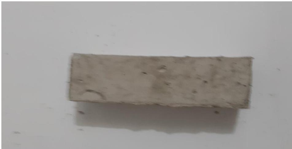
Figura 23 Adoquín con 15% de Pasta Residual de Cartón
