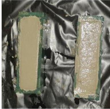
Figura 29 Colocación de mezcla en moldes de adoquines
