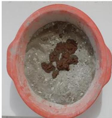
Figura 26 Mezcla de arena, grava, cemento y pasta residual de cartón
