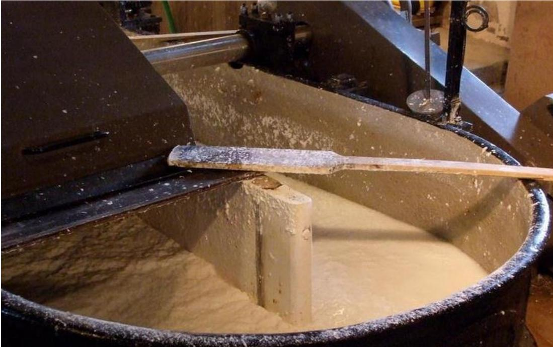
Figura 6 Pata residual de cartón en maquina Pulper
