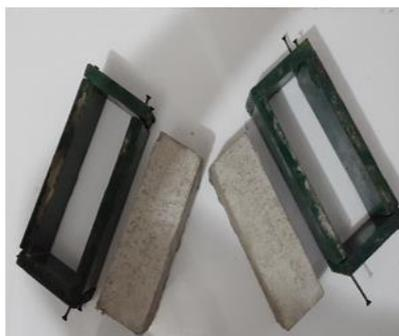
Figura 30 Desmoldado de adoquines
