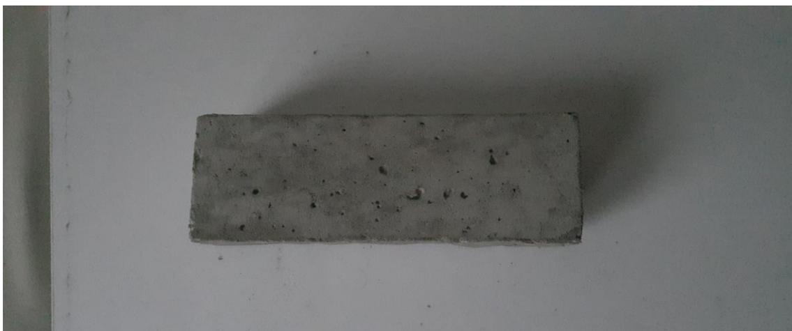
Figura 22 Adoquín con 12% de pasta residual de cartón
