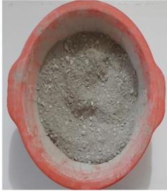
Figura 35 Mezcla de arena, grava y cemento
