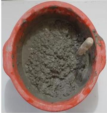
Figura 27 Mezcla de arena, grava, cemento, pasta residual de cartón y agua
