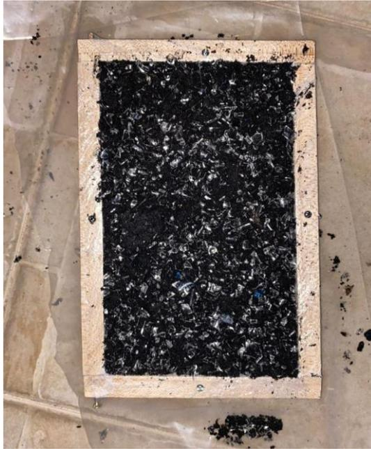
**Figura 39.** Mezcla colocada en el nuevo molde de madera de 2 cm de espesor
