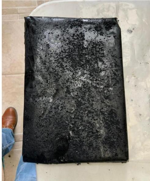
**Figura 45.** Muestra final de caucho en polvo y pet reciclado del ensayo CPR-05
