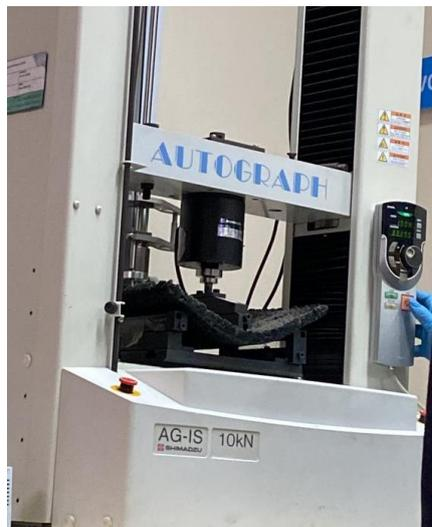
**Figura 52.** Prueba de flexión a la teja de caucho granulado y pet reciclado
