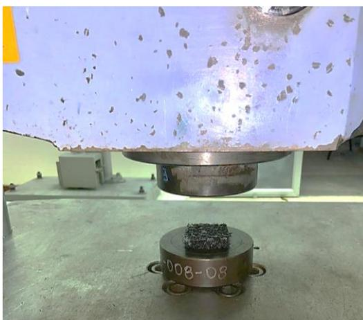
**Figura 55.** Muestra de teja de 50mm x 50mm para prueba de compresión
