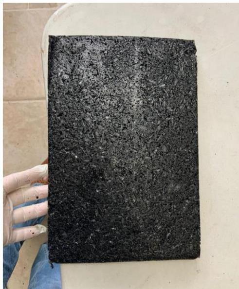
**Figura 46.** Muestra final de caucho granulado y pet reciclado del ensayo CPR-05
