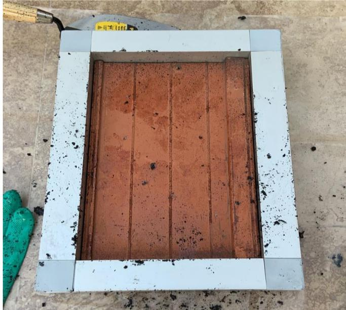
**Figura 28.** Encofrado en molde de aluminio de primera muestra de tejas
