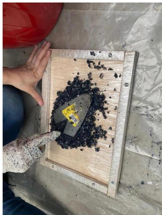
*Anexo 5. Prototipos CPR-01, CPR-02 y CPR-03 de tejas de caucho y pet reciclado*
