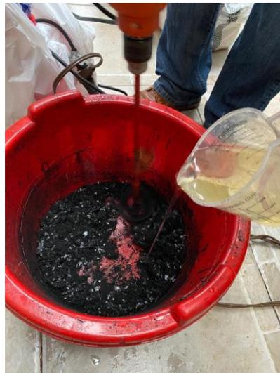
**Figura 34.** Mezcla de materiales caucho, pet y resina con el taladro y mezcladora.
