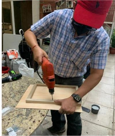
**Figura 33.** Fabricación de nuevos moldes de madera con espesor de 1,2 cm
