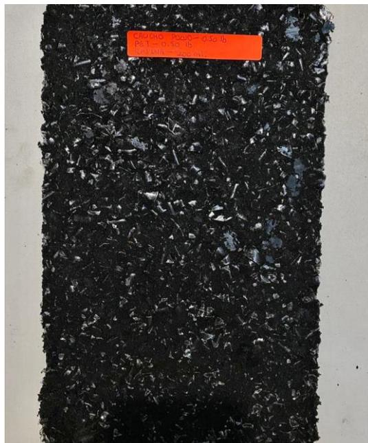
**Figura 37.** Muestra final de teja de la segunda proporción del ensayo CPR-03
