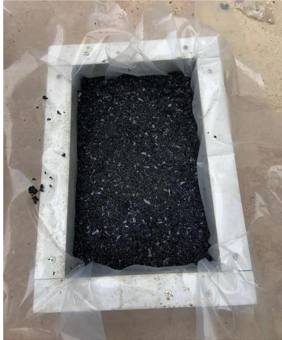
**Figura 30.** Encofrado en molde de aluminio recubierto con plástico
