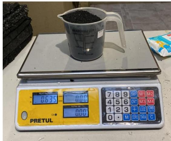
**Figura 43.** Pesaje del caucho granulado CPR-05
