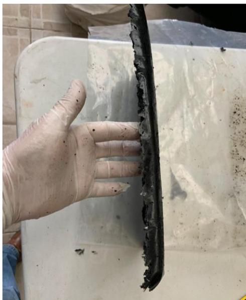
**Figura 47.** Muestra de bordes irregulares de la teja por el desbordamiento de la resina
