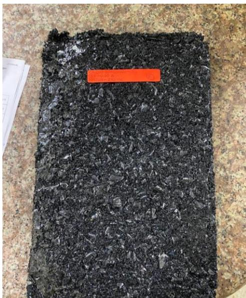
**Figura 54.** Muestra de la teja CPR-03 después de la prueba de flexión
