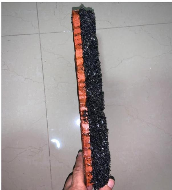
**Figura 29.** Muestra final de primeras tejas del ensayo CPR-01
