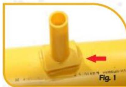
**Figura 91:** Fallas comunes en la termofusión con silletas
