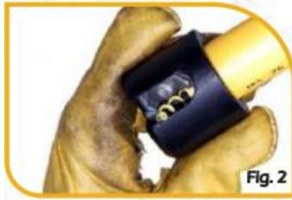
**Figura 61:** Procedimiento para la soldadura de termofusión a socket
