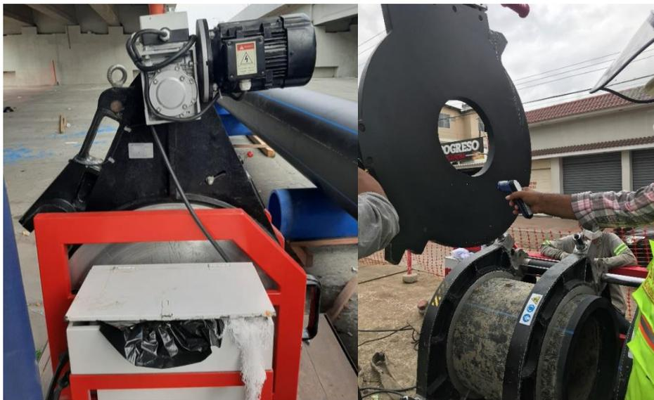
**Figura 128:** Colocación de la plancha de calentamiento
