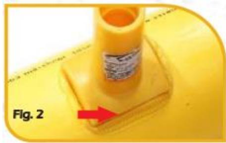
**Figura 92:** Fallas comunes en la termofusión con silletas
