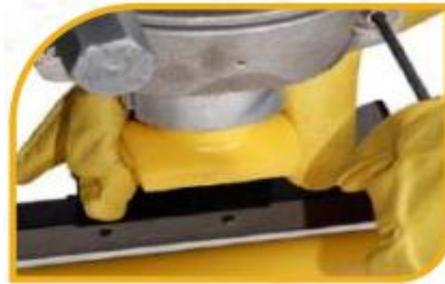
**Figura 84:** Procedimiento para soldadura de termofusión de siletas
