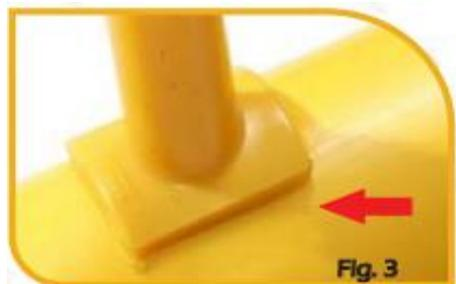
**Figura 93:** Fallas comunes en la termofusión con silletas
