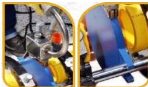
*Figura 43: Fase para la soldadura de termofusión a tope*
