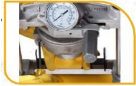
**Figura 81:** Procedimiento para soldadura de termofusión de silletas
