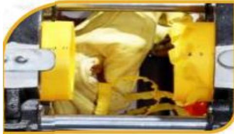
**Figura 40:** Procedimiento para la soldadura de termofusión a tope
