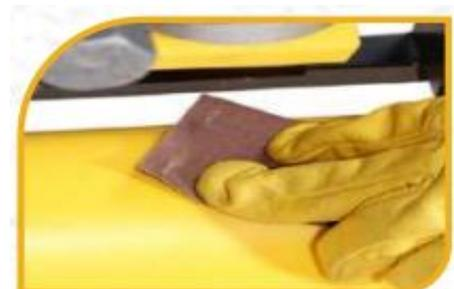
**Figura 83:** Procedimiento para soldadura de termofusión de silletas
