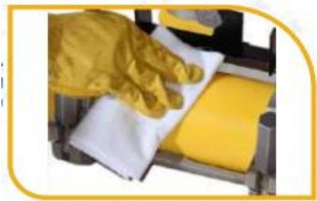
**Figura 82:** Procedimiento para soldadura de termofusión de silletas
