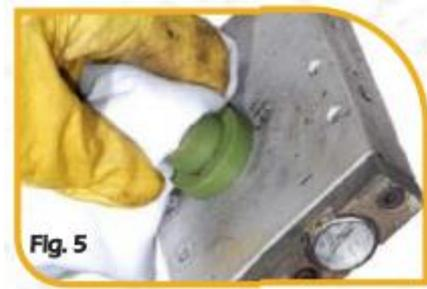
**Figura 64:** Procedimiento para la soldadura de termofusión a socket
