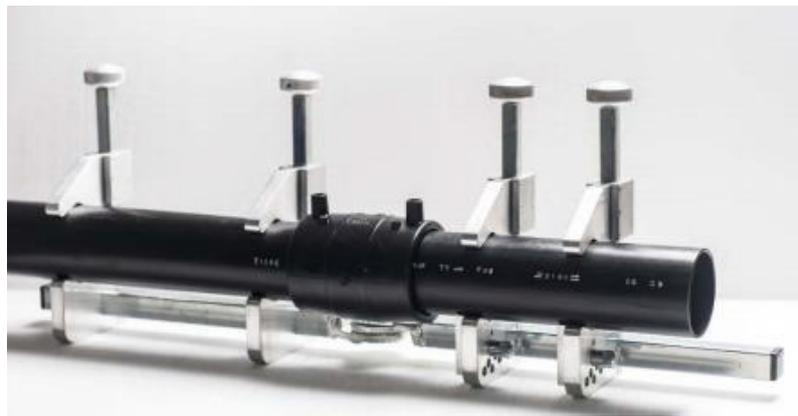
**Figura 21:** Realice los pasos anteriores para el tubo opuesto, retire el accesorio del paquete e inserte el tubo hasta la línea creada. La zona a soldar debe permanecer estable e inmóvil, para ello se puede utilizar un alineador Plasson.
