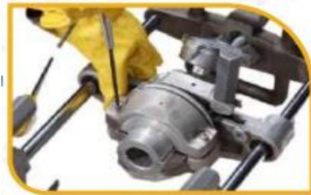
*Figura 80: Procedimiento para soldadura de termofusión de silletas*
