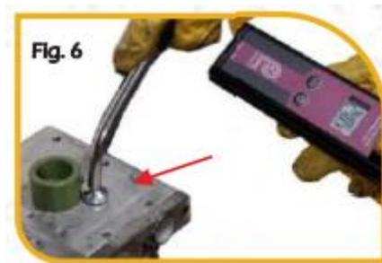
**Figura 65:** Procedimiento para la soldadura de termofusión a socket
