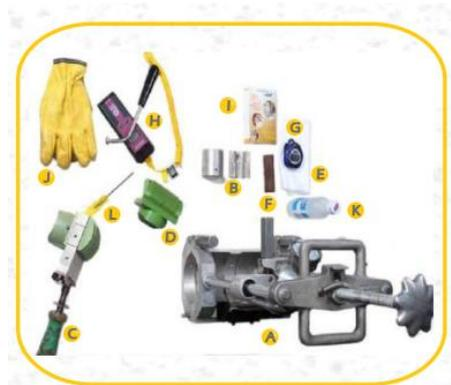
*Figura 79: Herramientas para soldadura de termofusión*
