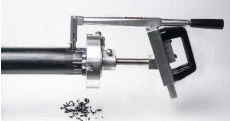
**Figura 20:** Afeite a mano o con un raspador hasta un grosor de aproximadamente 0,3 mm desde la superficie exterior. No toque la superficie rayada con las manos.
