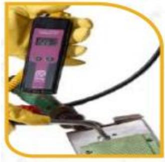
**Figura 86:** Procedimiento para soldadura de termofusión de silletas
