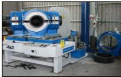
**Figura 24:** Máquina de soldar a tope de taller para fabricar accesorios manipulados.
