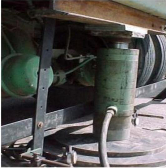
*Figura 4.* Equipo para la prueba de placa de carga
