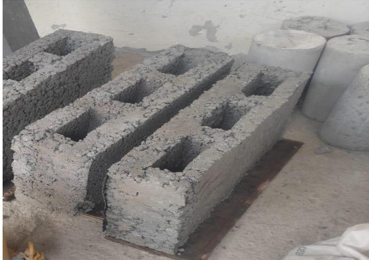
***Figura 12: Bloques elaborados con materiales propuestos.***
