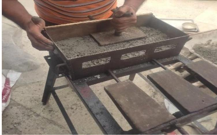
***Figura 10: Elaboración de bloque con material propuesto***
