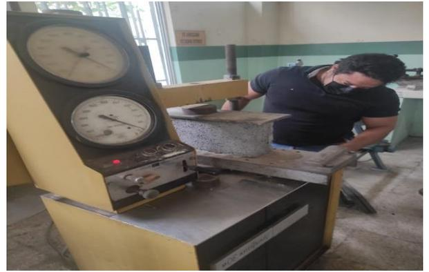
***Figura 56: Rotura de bloques con materiales propuestos.***
