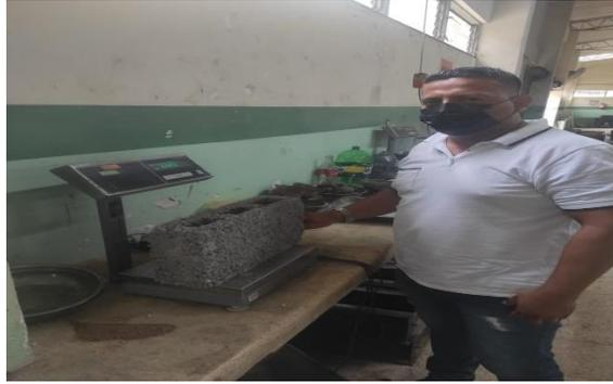
***Figura 19: Control de peso de los bloques***
