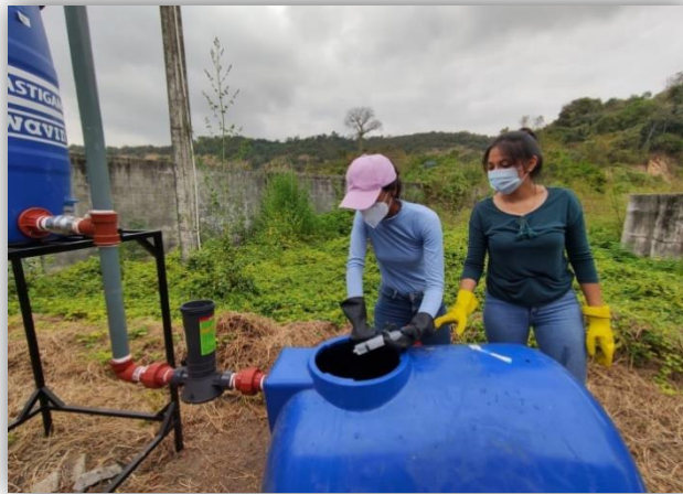
Ilustración 45. Dosificación del agua residual con el ácido peracético
