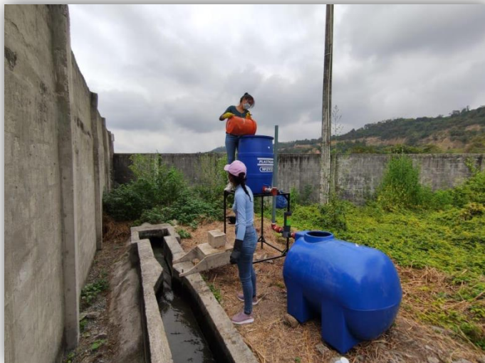
Ilustración 38. Llenado del tanque elevado con 405 litros de agua residual. Elaborado por: Arana & Mancero (2021).
