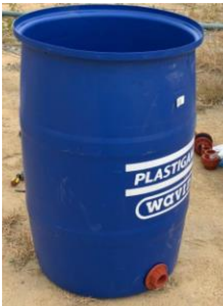
Ilustración 28. Adecuación del tanque de 55 galones para conexión de tubería de 1 ½”.
