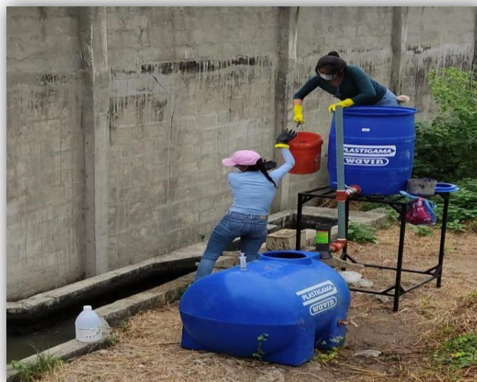
Ilustración 58. Abastecimiento del tanque elevado con 405 lts de agua residual. Elaborado por: Arana & Mancero (2021).
