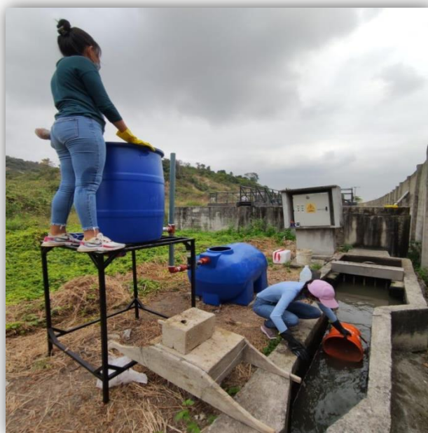
Ilustración 35. Llenado del tanque elevado con agua residual. Elaborado por: Arana & Mancero (2021).
