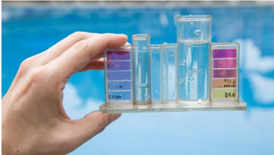
Ilustración 19. Cloro líquido residual. Fuente: ACQUA TECNOLOGIA (s.f.)
