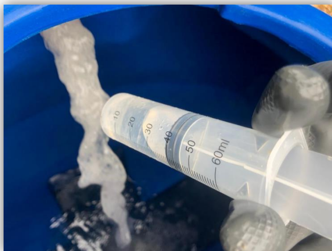
Ilustración 61. Dosificación del agua residual con el ácido peracético. Elaborado por: Arana & Mancero (2021).
