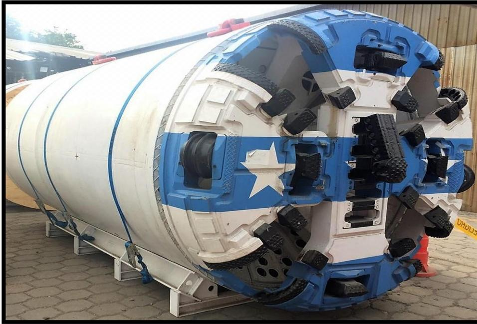
*Ilustración 27.* Microtuneladora usada para la perforación de la línea de impulsión pradera-esclusas.
