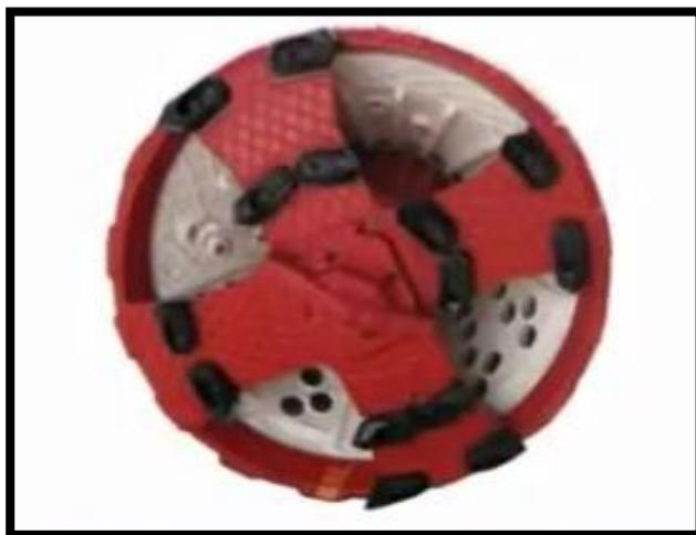
*Ilustración 17.* Cabezal de corte para suelos blandos.
