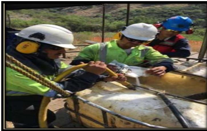
*Ilustración 33.* Aplicación del fluido de perforación biodegradable.
