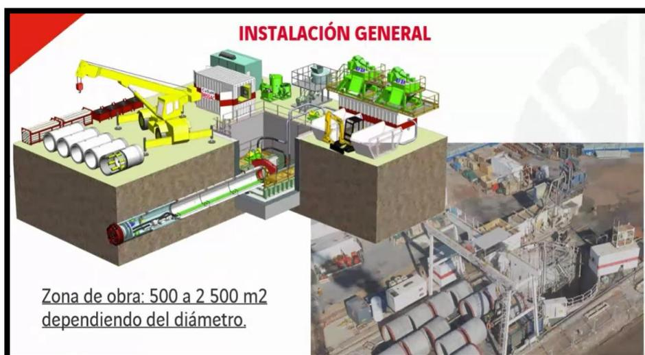
Ilustración 20. Instalación de general del proyecto de microtuneladora.
