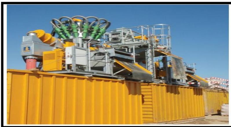
Ilustración 16. Planta de separación de lodos.
