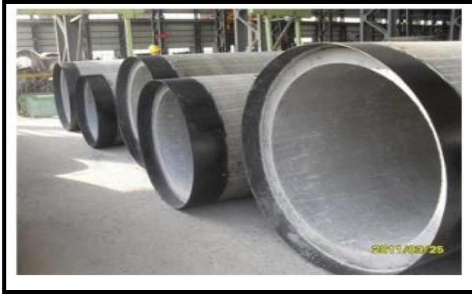
*Ilustración 11.* Tuberías de concreto reforzado.
