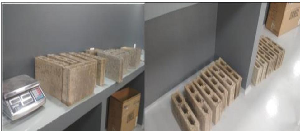
**Figura54.**Medición (peso, masa, volumen) del bloque en laboratorio.
