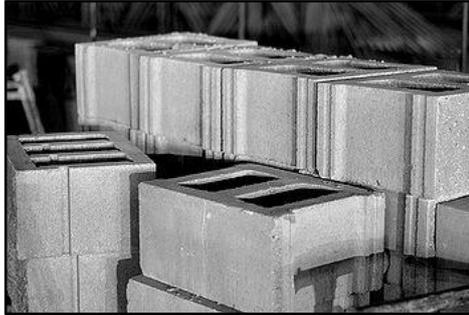
**Figura 11.** Bloque de Hormigón.
