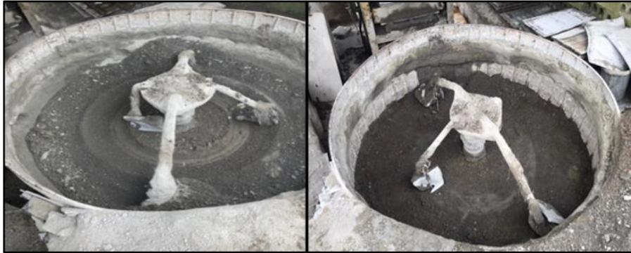
**Figura46.** Colocación de las disociaciones (arena y agua) en la mezcladora
