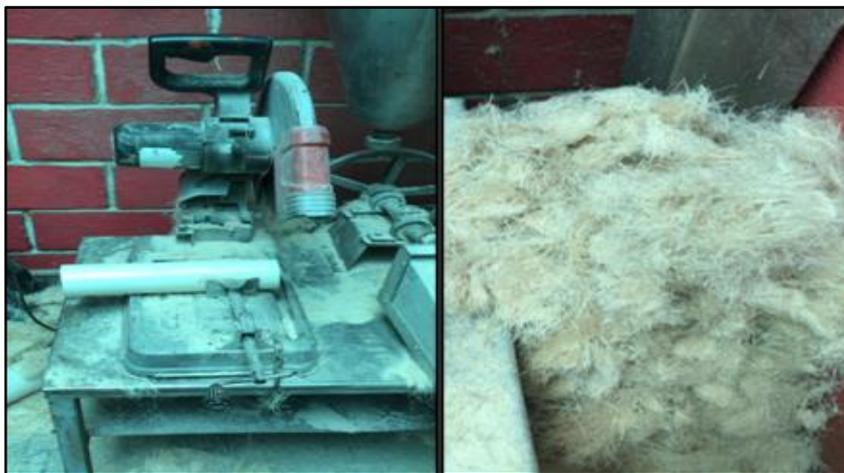
**Figura45.** Proceso de corte de la fibra con una longitud de 2-5 cm
