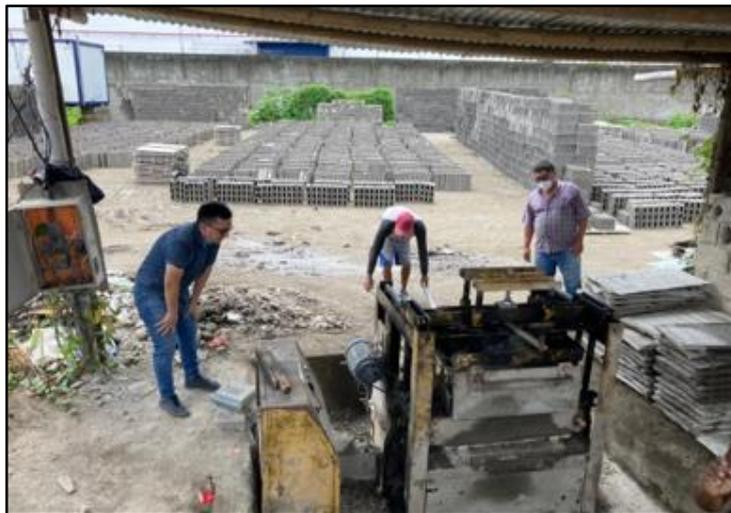
**Figura50.** De la mezcladora a la maquina moldeadora.
