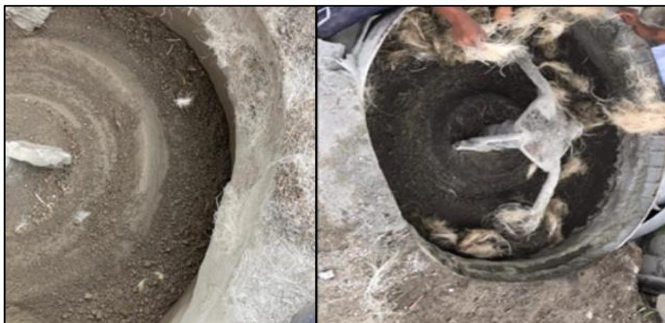
**Figura48.** Colocación de las disociaciones (fibra y cemento) en la mezcladora.
