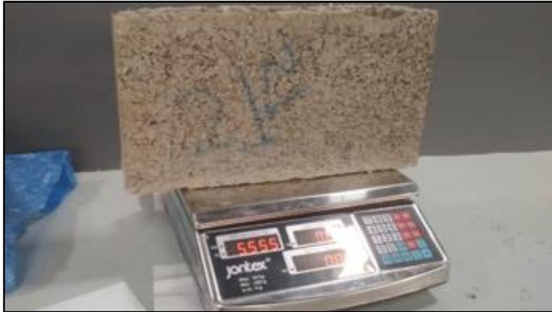
**Figura58.** Se calcula el peso del bloque, secado.
