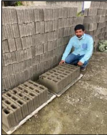
**Figura52.** Al retiro del bloque ecológico se observa el bloque listo para el curado.
