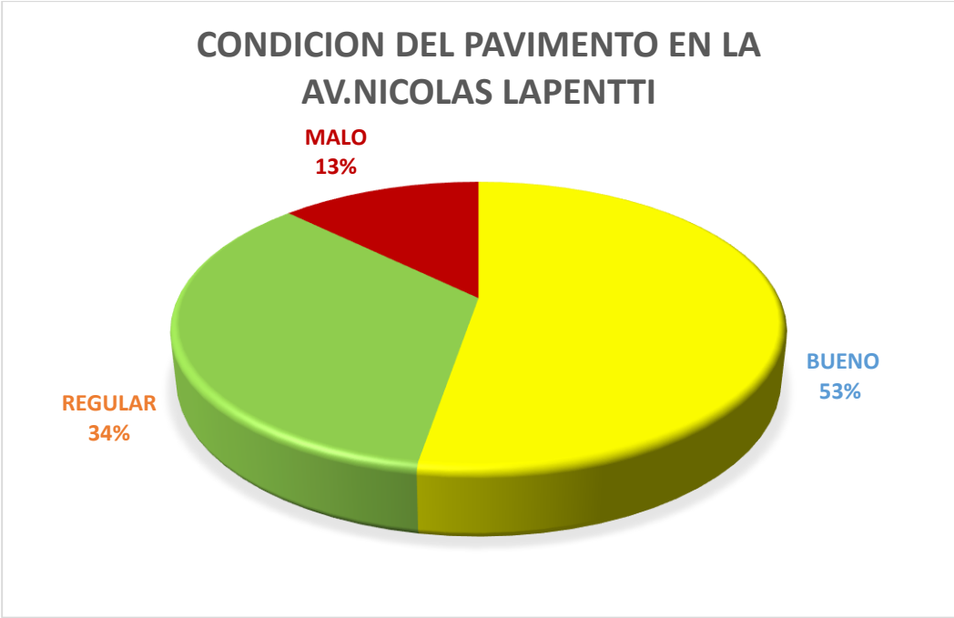
Figura 41 Condición del pavimento en la Av. Nicolás Lapentti Elaborado por: (Espinoza C y Torres W, 2021)
