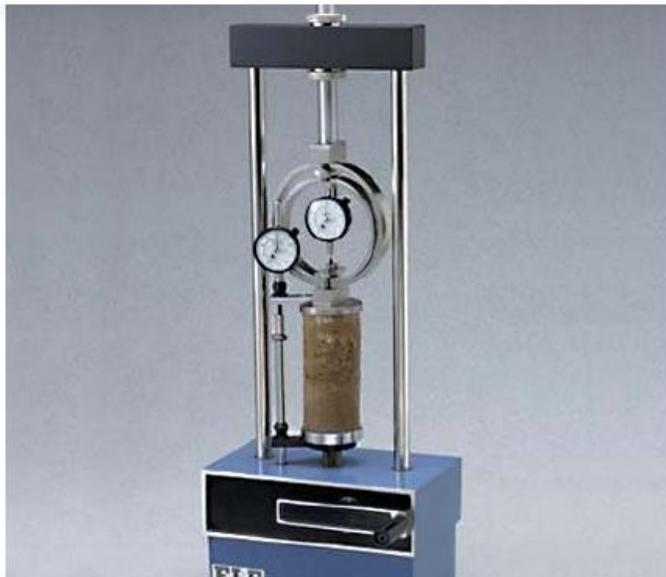
**Figura 19:** ensayo de compresión simple.
