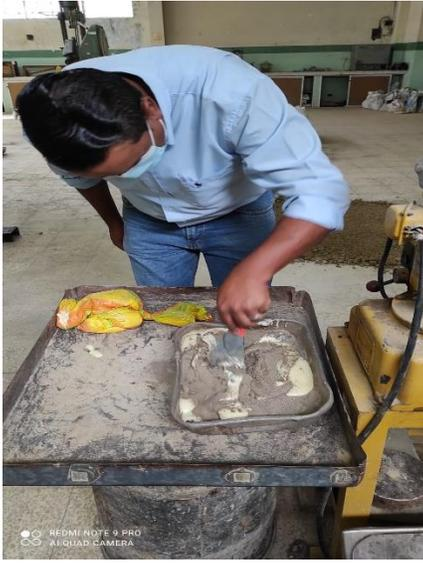
**Figura 21:** Tendida del material arcilloso.
