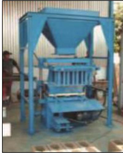
Ilustración 28: Máquina de adoquines semi-manual.
