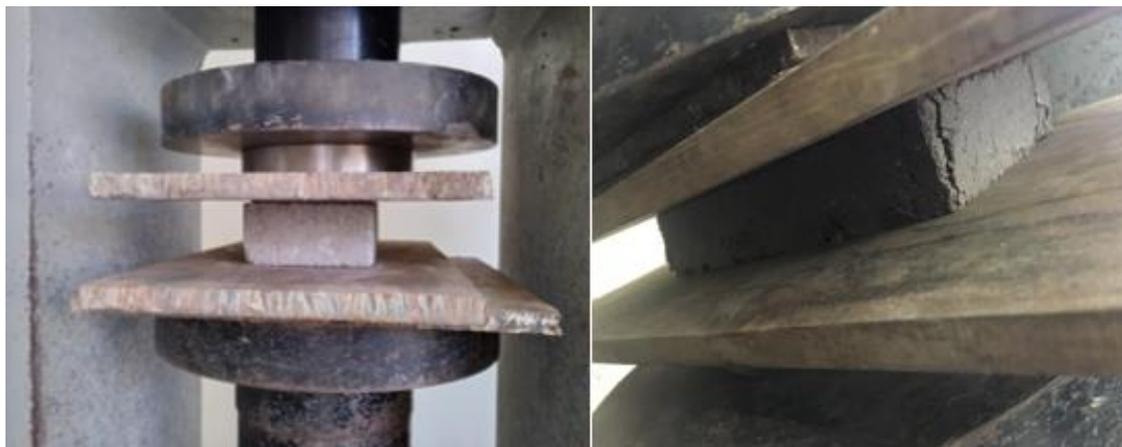
Ilustración 52: Ensayo de Resistencia a la Compresión y rotura.
