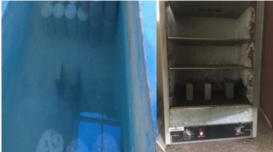
Ilustración 50: proceso del ensayo de absorción de agua.
