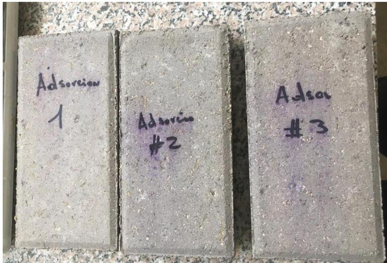
Ilustración 51: Ensayo de absorción.
