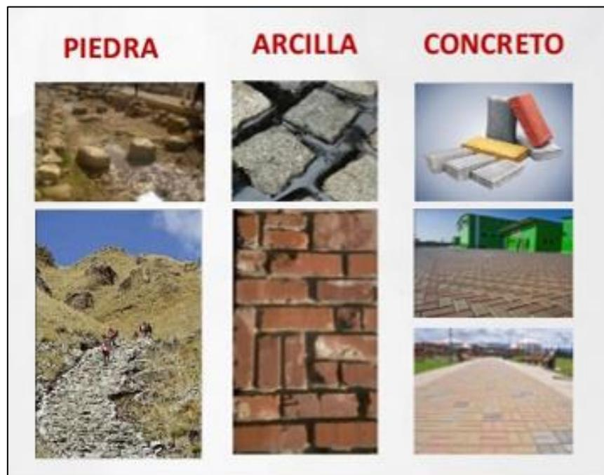
Ilustración 24: Tipos de adoquín según el tipo de material.
