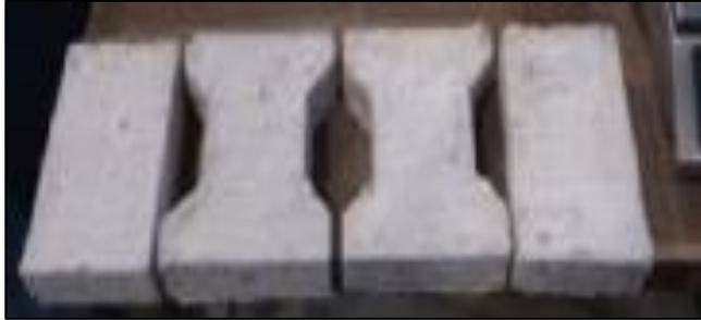
Ilustración 2: Adoquín con Agregados Reciclados.
