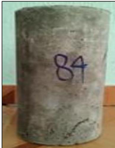
Ilustración 4: Probetas de concretos reforzados con fibras de maíz.
