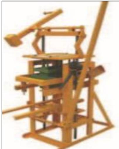
Ilustración 27: Máquina de adoquines Manual.
