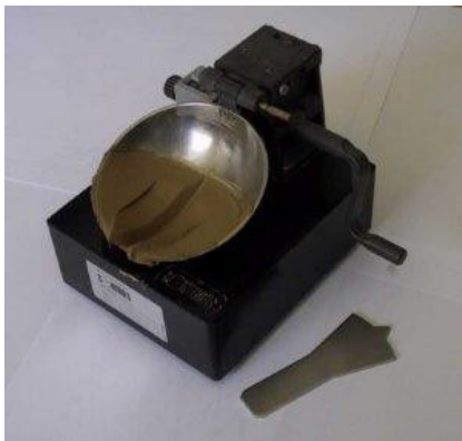
Figura 16 Cuchara de casa grande.. Fuente: (GEOTECNIA FACIAL, 2017) Elaborado por: Herrera y Ortiz (2021)
