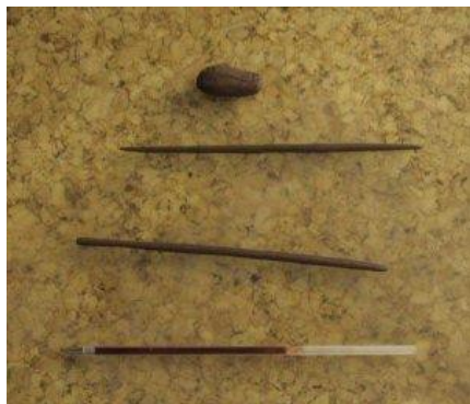
Figura 17: Limite plástico.. Fuente: (GEOTECNIA FACIAL, 2017) Elaborado por: Herrera y Ortiz (2021)
