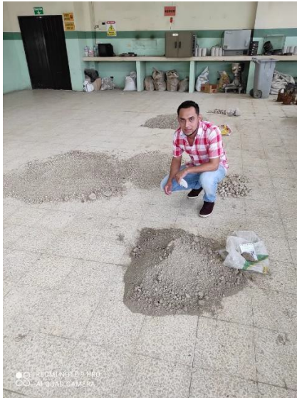
Figura 45: Cuarteo del material arcilloso.. Elaborado por: Herrera y Ortiz (2021)
