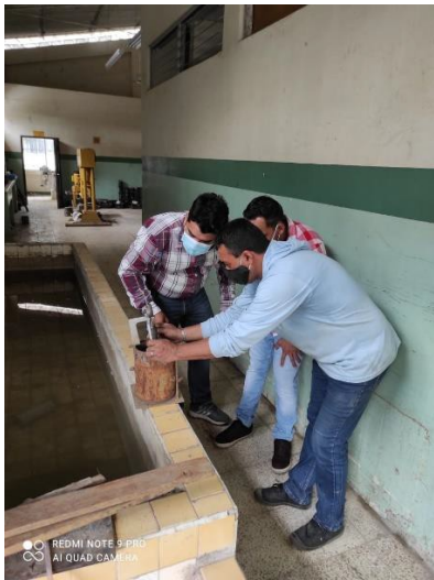
Figura 49: Toma de lectura de la expansión.. Elaborado por: Herrera y Ortiz (2021)
