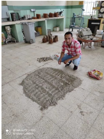
Figura 46: Cuarteo del material arcilloso. Elaborado por: Herrera y Ortiz (2021)
