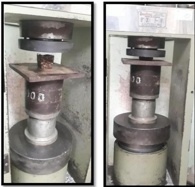
**Imagen 69.** Realización de las pruebas de resistencia a la compresión
