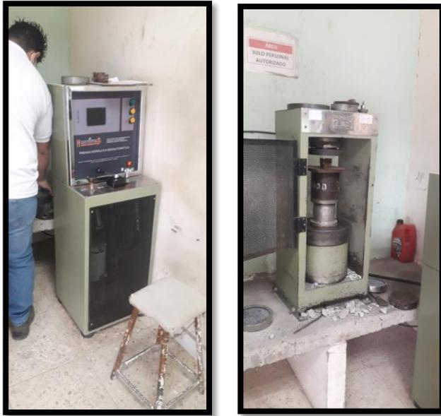
**Imagen 68.** Realización de las pruebas de resistencia a la compresión
