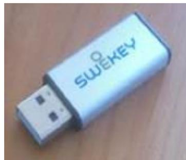
El Token de seguridad es un dispositivo electrónico (similar a un pen-drive) de tamaño pequeño que se le da a un usuario autorizado de un servicio computarizado para facilitar el proceso de autenticación. Se usan para almacenar claves criptográficas como firmas digitaleso datos biométricos, como las huellas digitales.
