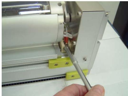
Fig. 8 Sombrete que fija cables de lámpara
