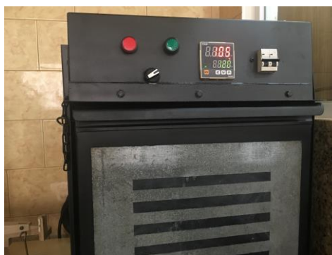
Figura 13. Horno empleado para secado de materiales
