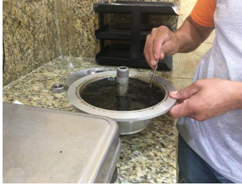
Figura 47. Mezcla de asfalto con gasolina lista para colocar en la centrífuga
