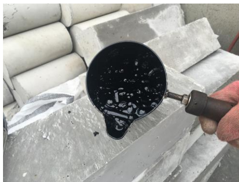
Figura 52. Colillas absorbiendo el asfalto y emergiendo burbujas
