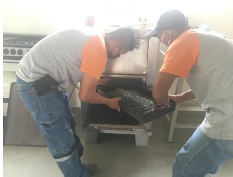
Figura 39. Colocando agregados a calentar en el horno
