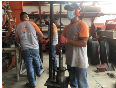
Figura 18. Martillo para compactar la mezcla en el molde
