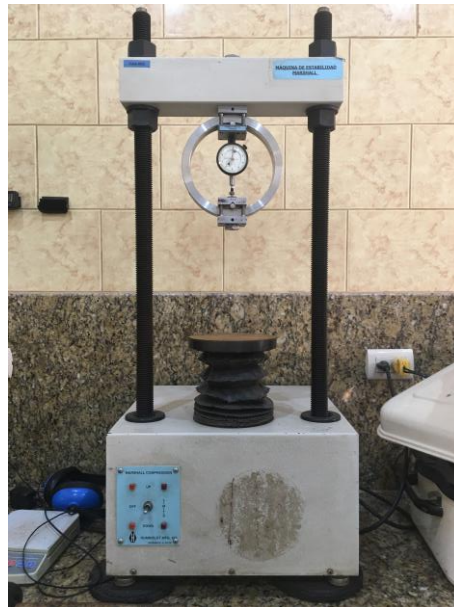
Figura 16. Máquina de estabilidad Marshall marca Humbolt
