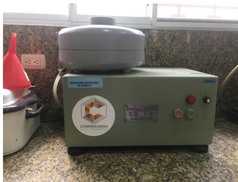
Figura 11. Centrifuga utilizada para extracción de asfalto
