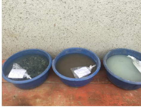
Figura 30. Material saturad con agua para realizar ensayo de Gravedad Específica
