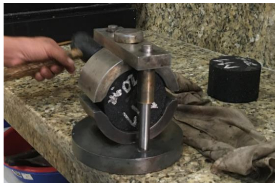
Figura 19. Molde para colocar las briquetas
