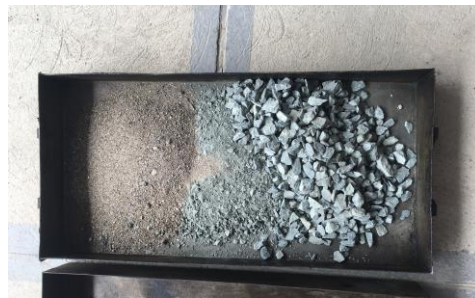
Figura 56. Agregados pesados de acuerdo al diseño listos para el horno
