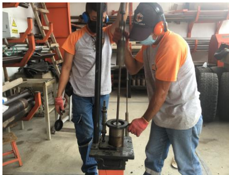
Figura 42. Compactación de mezcla para formar briquetas
