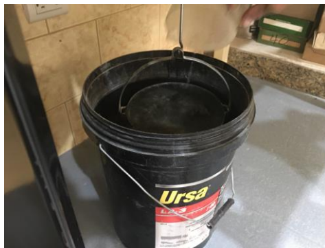
Figura 31. Pesando la canastilla sumergida en agua
