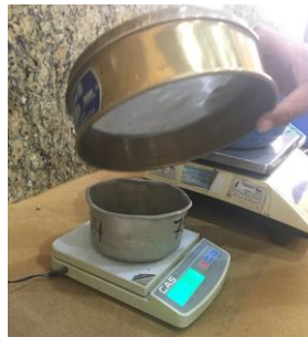
Figura 26. Peso del material retenido en el tamiz 200
