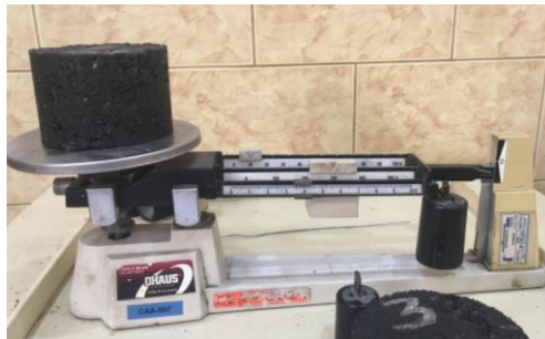
Figura 10. Balanza utilizada para pesar las briquetas
