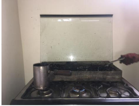
Figura 41. Mezcla de agregados con asfalto
