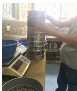
Figura 24. Tamices a utilizar en el ensayo
