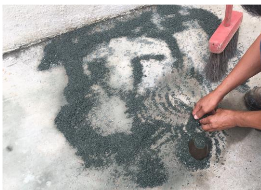
Figura 33. Comprobación se saturación superficial del cisco
