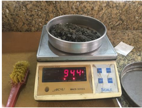
Figura 49. Peso de muestra luego de extraer el asfalto
