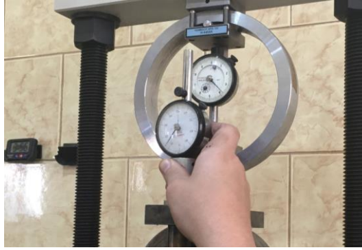
Figura 17. Dial de flujo utilizado en ensayo Marshall
