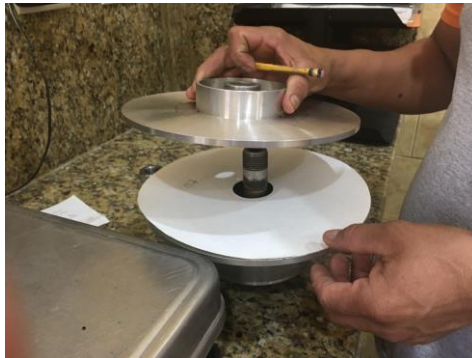
Figura 48. Colocación de filtro
