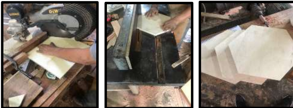
Figura 16 Corte de caras hexagonales Elaborado por: Angulo I. 2021
