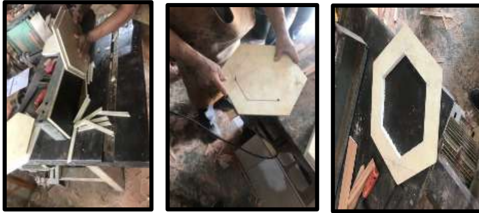
Figura 17 Corte de doble filo exterior, calado interior y lijado Elaborado por: Angulo I. 2021
