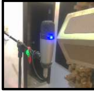
Figura 25 Prueba de frecuencia con fibra de coco micrófono condensador Elaborado por: Angulo I. 2021
