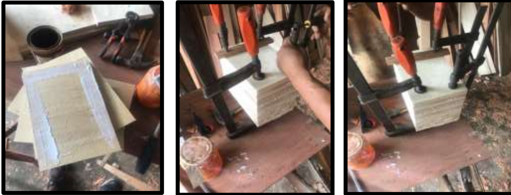
Figura 15 Encolado y presión de piezas Elaborado por: Angulo I. 2021
