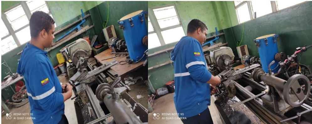
Anexo 9: Maquinado de boquilla de extrusión de 1/2, 5/8, 3/4 y 1 pulgada.
