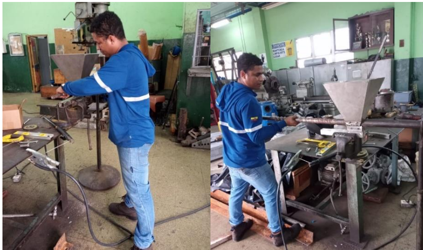
Anexo 16: Montaje del eje extrusor hacia la camisa de calentamiento.
