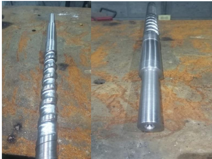
Anexo 3: Acoplamiento del cilindro de calefacción con el tornillo sin fin o Husillo
