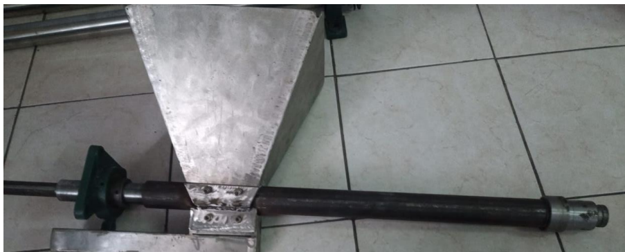
Anexo 17: Ensamblaje total del cuerpo de la maquina Extrusora
