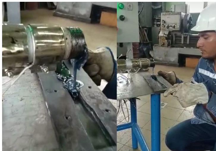
Figura 57: Llenado del molde Fuente: Chalaco & Muñoz (2021)
