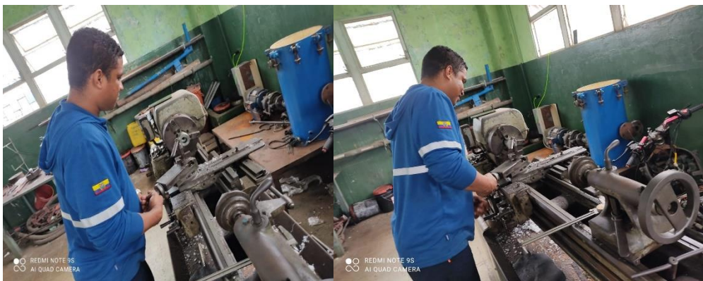
Figura 62: Maquinado de boquilla de extrusión de \frac{1}{2} , \frac{5}{8} , \frac{3}{4} y 1 pulgada. Fuente: Chalaco & Muñoz (2021)
