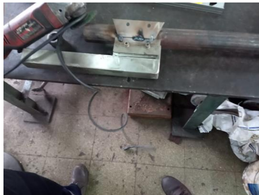
Anexo 15: Nivelación del eje extrusor con respecto a la tolva.
