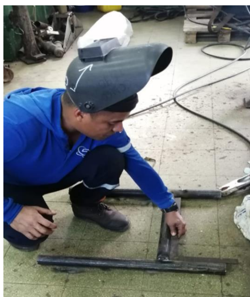
Anexo 18: Soldadura de las patas de la mesa donde se apoyará la maquina extrusora
