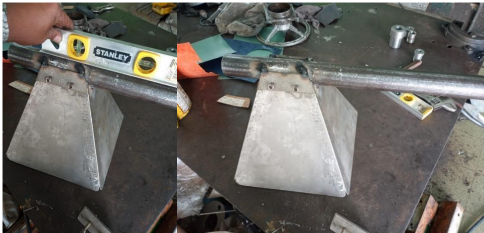
Figura 61: Suelda de las platinas que van fijadas al tubo de calentamiento y tolva. Fuente: Chalaco & Muñoz (2021)
