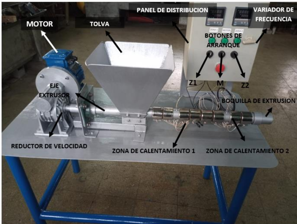
Figura 70: Maquina extrusora y sus partes Fuente: Chalaco & Muñoz (2021)
