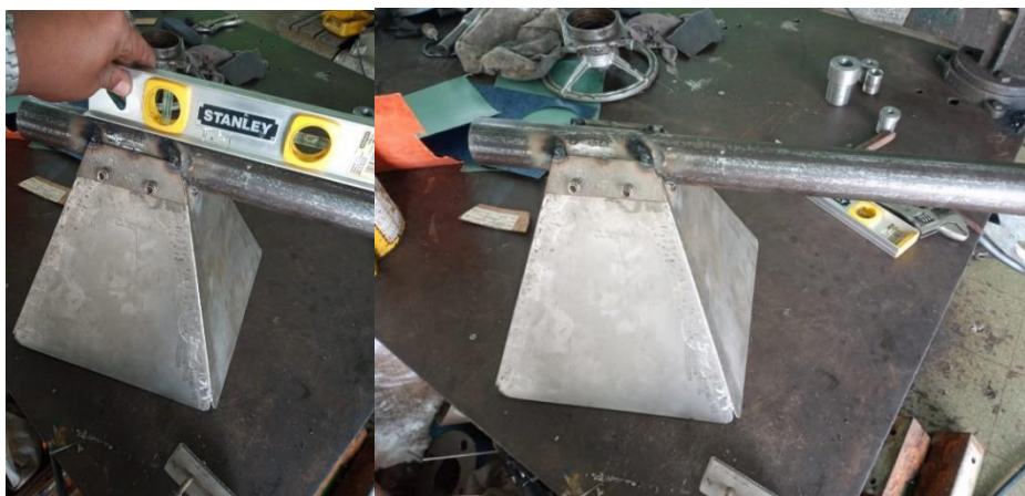
Anexo 6: Suelda de las platinas que van fijadas al tubo de calentamiento y tolva.
