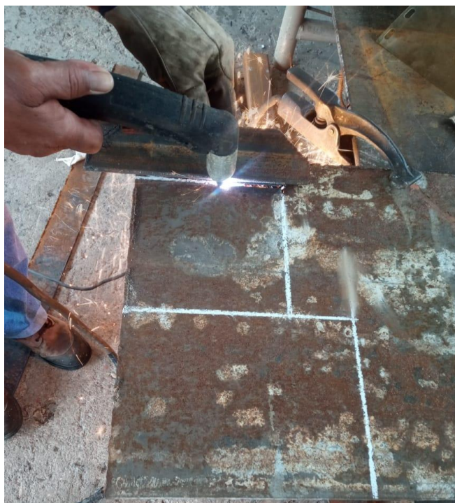
Anexo 25: Corte con plasma de la base del motor
