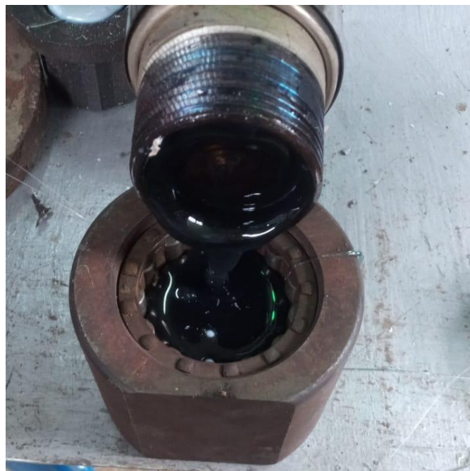
Anexo 42: Llenado del molde con plástico PET.
