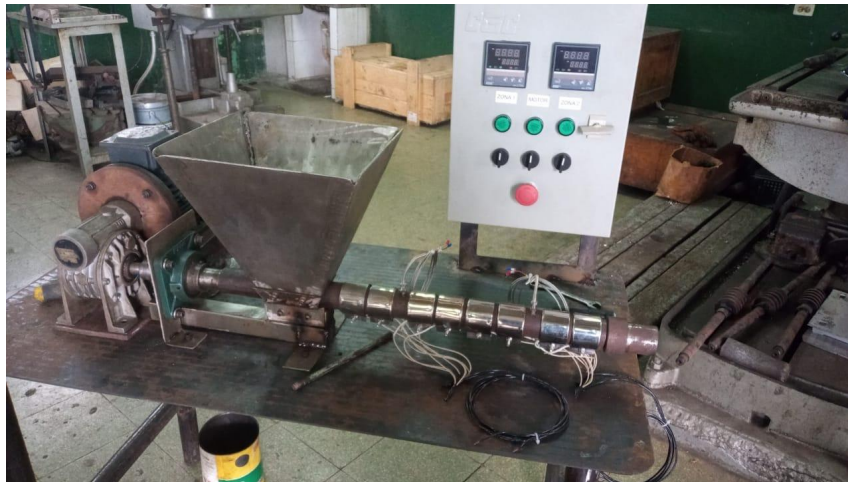
Figura 67: Conexión de los componentes mecánicos de la maquina extrusora Fuente: Chalaco & Muñoz (2021)
