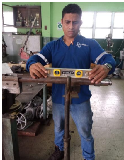
Anexo 15: Nivelación del eje extrusor con respecto a la tolva.
