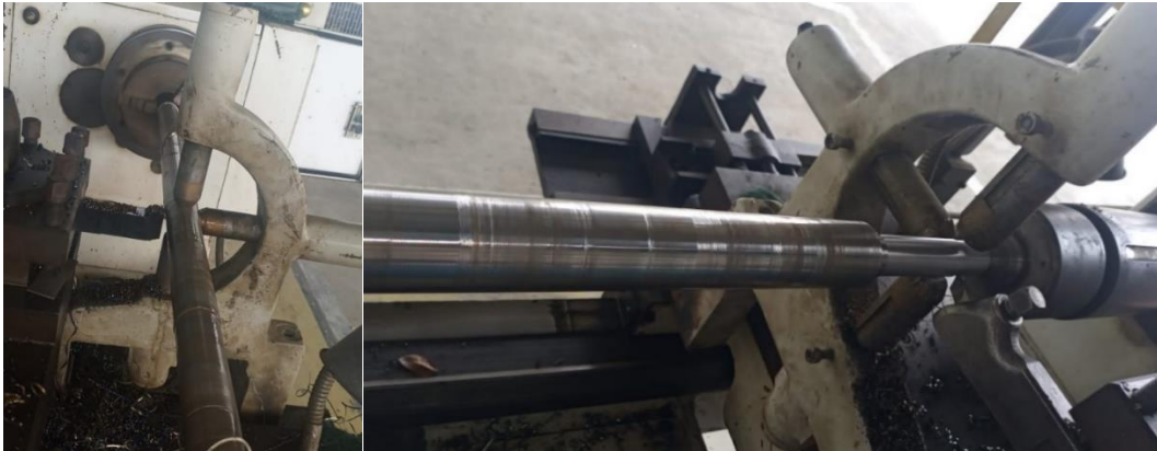
Figura 58: Fabricación del eje extrusor o cilindro de calefacción Fuente: Chalaco & Muñoz (2021)
