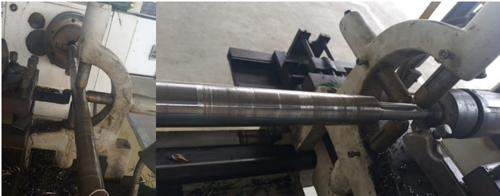
Anexo 2: Maquinado del tornillo extrusor o husillo
