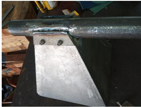
Anexo 8: Ajuste de pernos, centrado y posicionamiento de las piezas donde pasara el material PET triturado.
