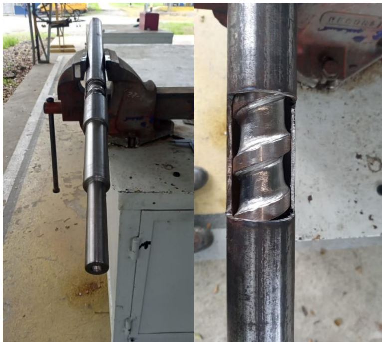
Figura 59: Acoplamiento del cilindro de calefacción con el tornillo sin fin o Husillo Fuente: Chalaco & Muñoz (2021)
