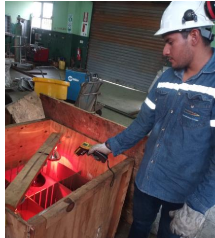
Figura 54: Controlar la temperatura en la cámara de deshumidificación Fuente: Chalaco & Muñoz (2021)
