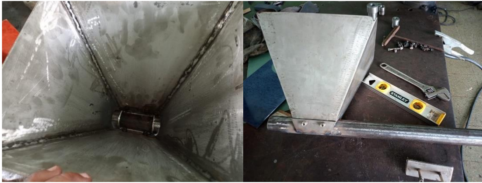
Anexo 8: Ajuste de pernos, centrado y posicionamiento de las piezas donde pasara el material PET triturado.
