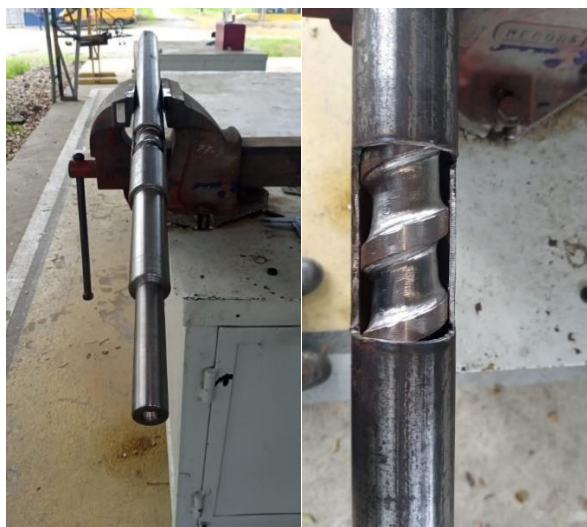
Anexo 3: Acoplamiento del cilindro de calefacción con el tornillo sin fin o Husillo
