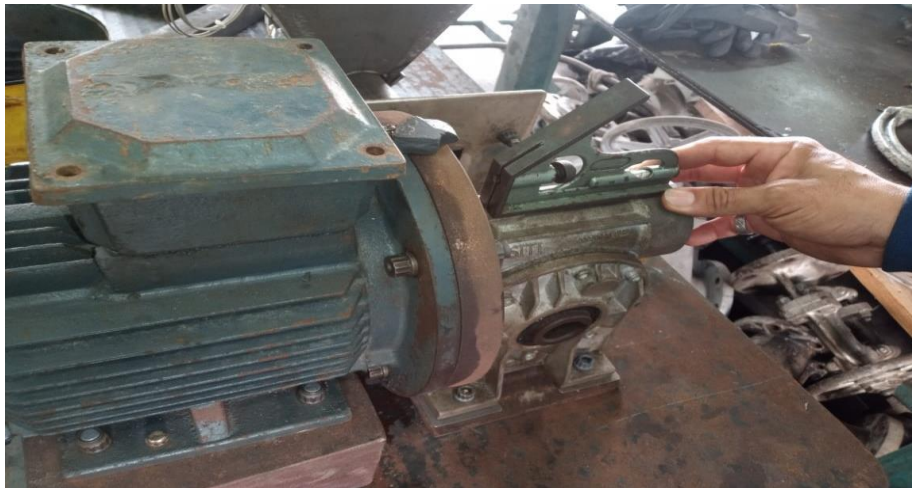
Anexo 34: Conexión de los componentes mecánicos de la maquina extrusora
