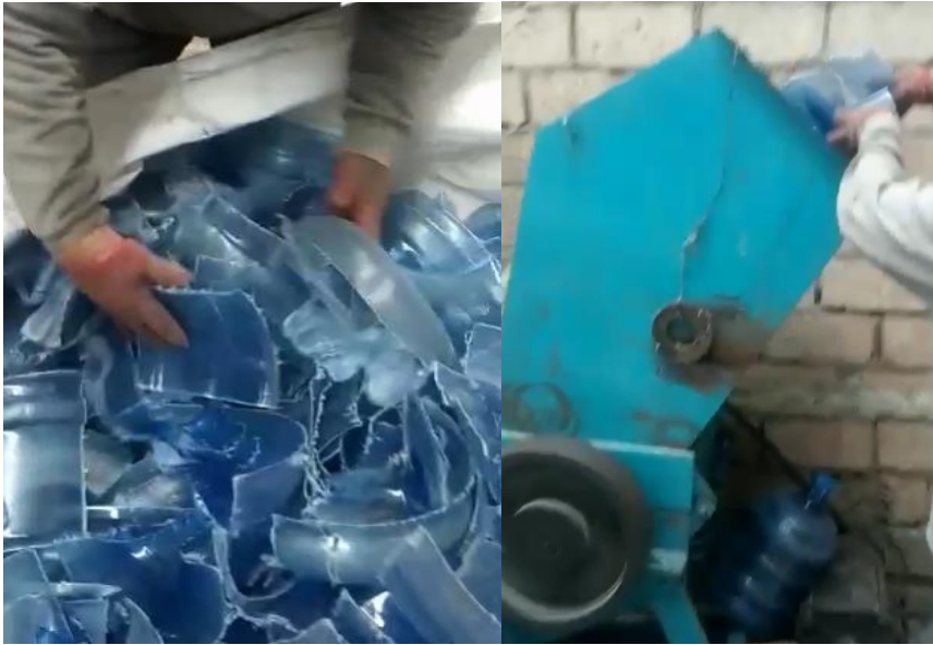
Anexo 46: Obtención de hojuelas de plástico PET
