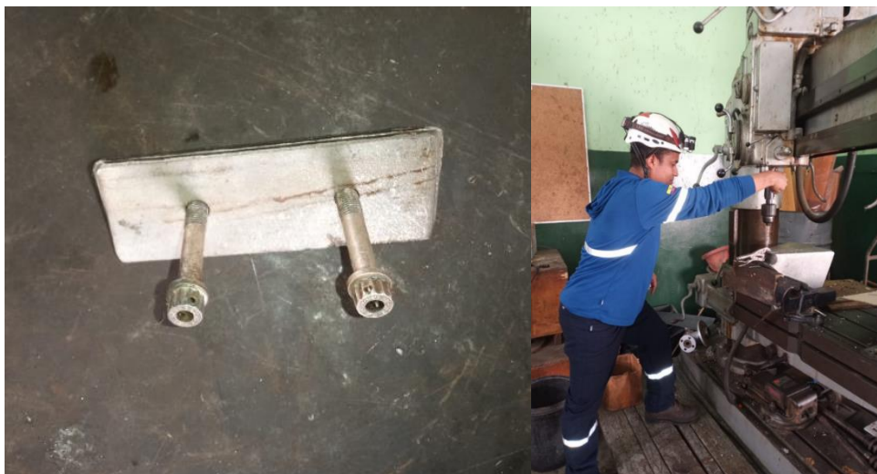
Anexo 6: Suelda de las platinas que van fijadas al tubo de calentamiento y tolva.
