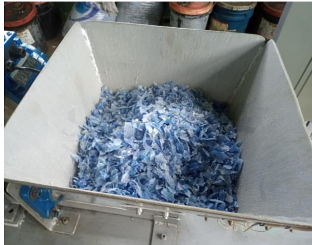
Figura 56: Colocación de material PET triturado en la tolva Fuente: Chalaco & Muñoz (2021)
