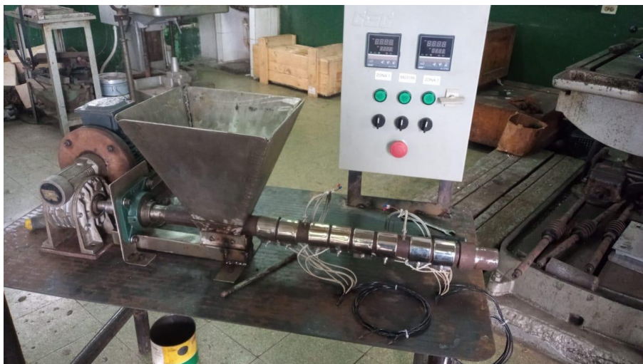
Anexo 34: Conexión de los componentes mecánicos de la maquina extrusora
