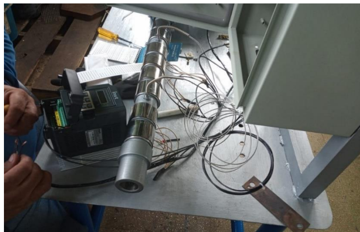
Anexo 37: Instalación de conexiones electrónicas del variador de frecuencias.
