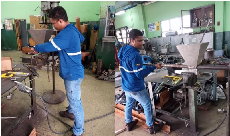
Figura 64: Montaje del eje extrusor hacia la camisa de calentamiento. Fuente: Chalaco & Muñoz (2021)
