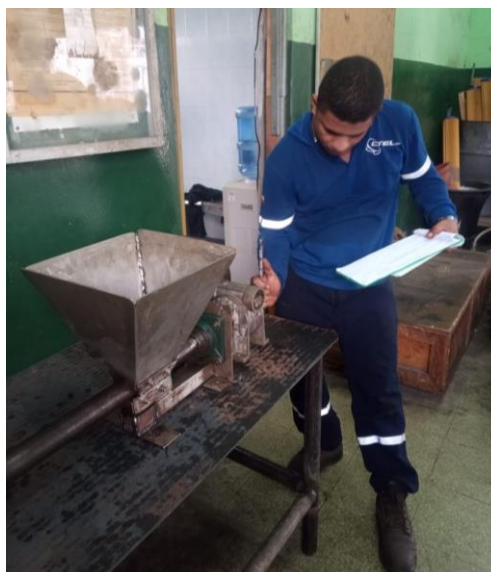
Anexo 21: Verificación de las medidas entre la base del motor y el reductor de velocidad
