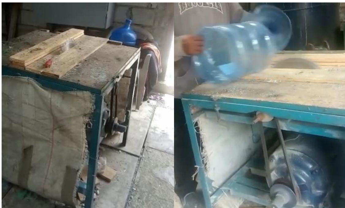
Anexo 44: Corte de botellas en partes por medio de una cortadora eléctrica.
