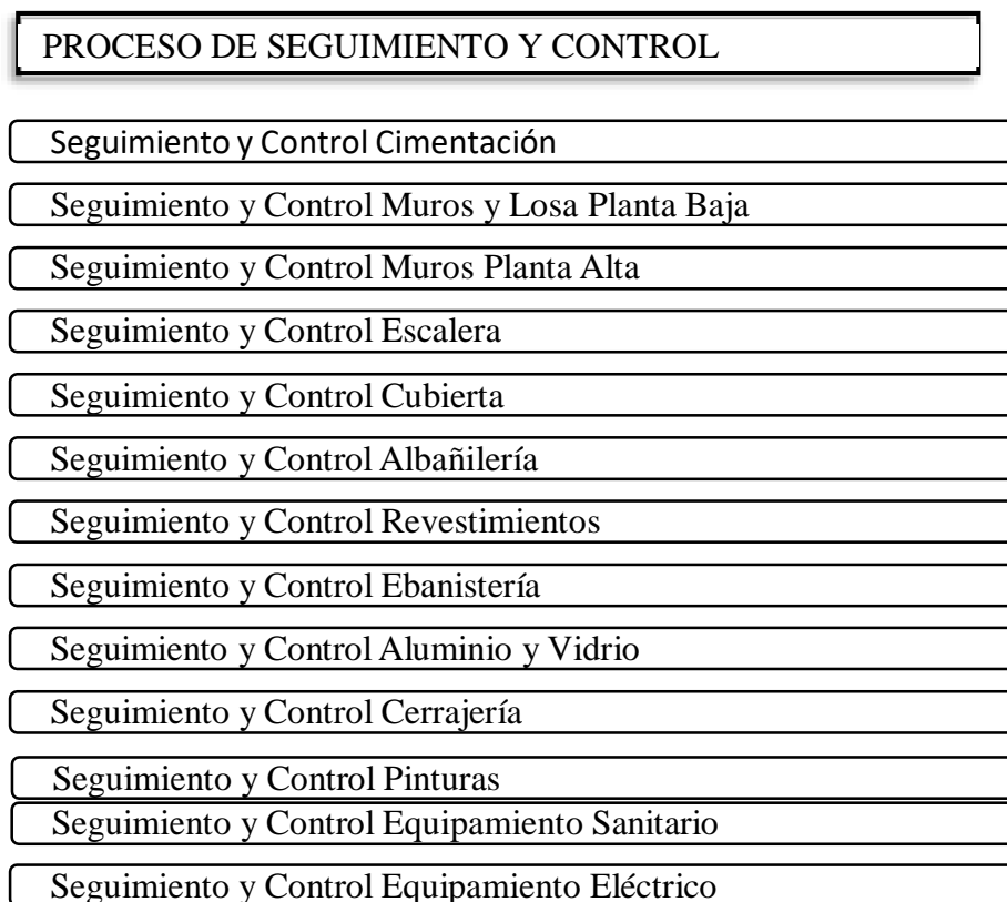
Figura 12. Proceso de seguimiento y control por rubros en construcción de villas de hormigón armado. Elaborado por: Garcés (2021)
