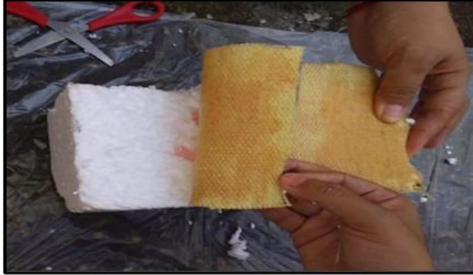
**Figura 17. Corrosión del bloque EPS**
