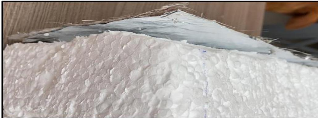
**Figura 22.** *Desprendimiento de la fibra de vidrio del bloque EPS*
