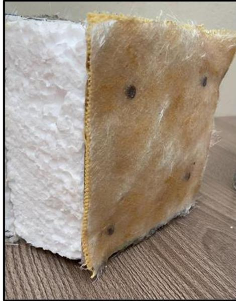
**Figura 41. Puesta de kevlar con engrudo y fibra de vidrio con resina y secante**
