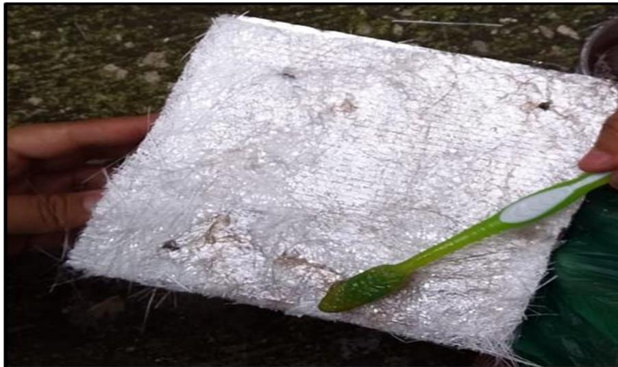
**Figura 27. Aplicación de resina y secante a fibra de vidrio**
