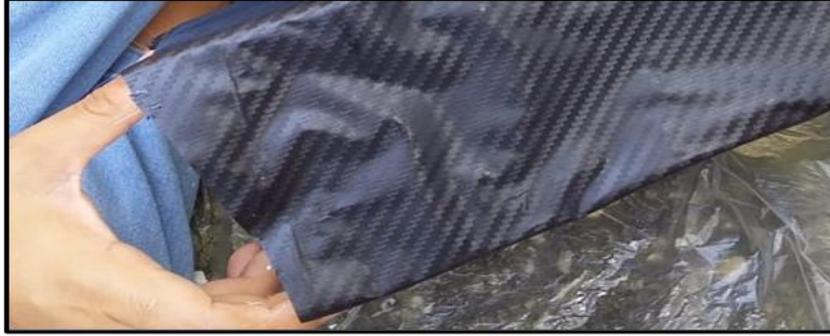
**Figura 25. Desnivel de la fibra de carbono**
