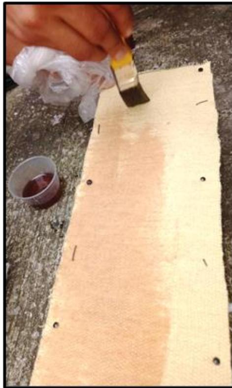
**Figura 44 . Ligero barrido de kevlar con resina y secante**
