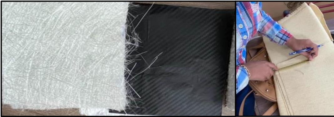
**Figura 15. Recortes de las fibras de vidrio, carbono y kevlar**
