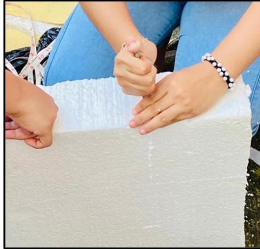
**Figura 34. Corte del bloque EPS**
