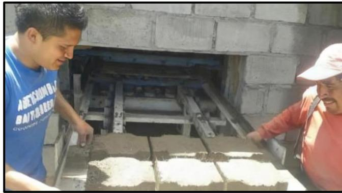
**Figura 5.** *Adoquines con estopa de coco y fibras de vidrio*
