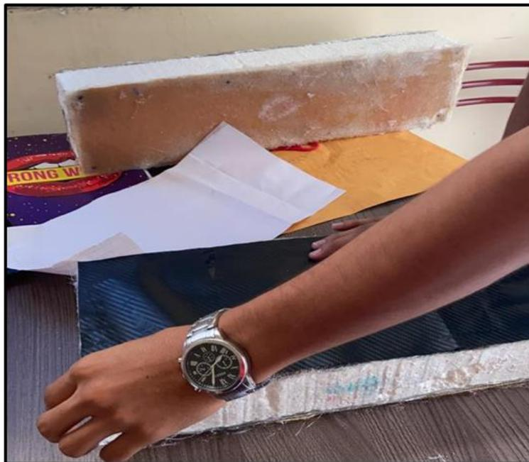
**Figura 42. Implementación de la fibra de carbono encima de las fibras de vidrio y kevlar**
