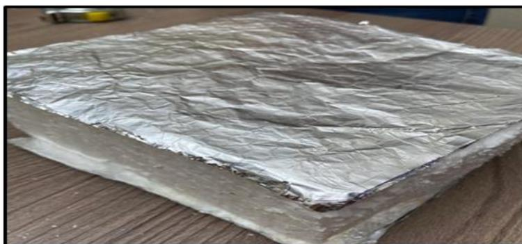
**Figura 19. Lámina de aluminio sobre el bloque EPS**
