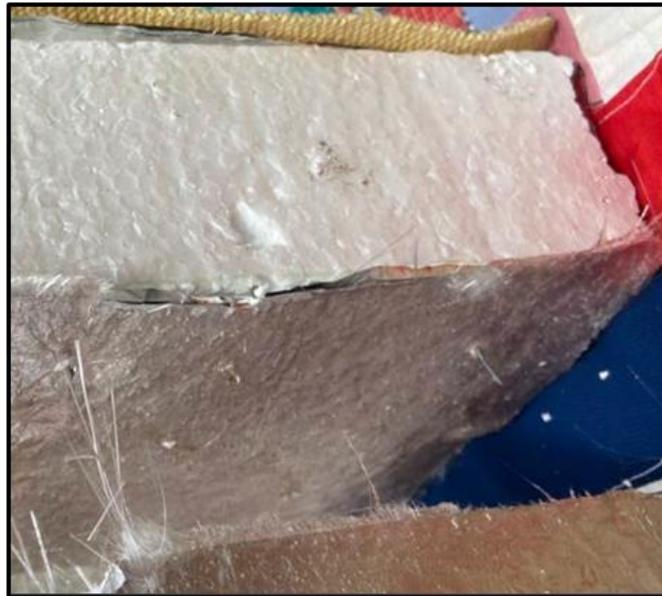
**Figura 28. Hundimiento en bloque EPS**
