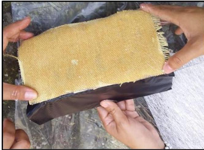
**Figura 18 . Colocación del kevlar**
