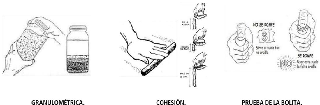
Figura 46. Pruebas granulométricas
