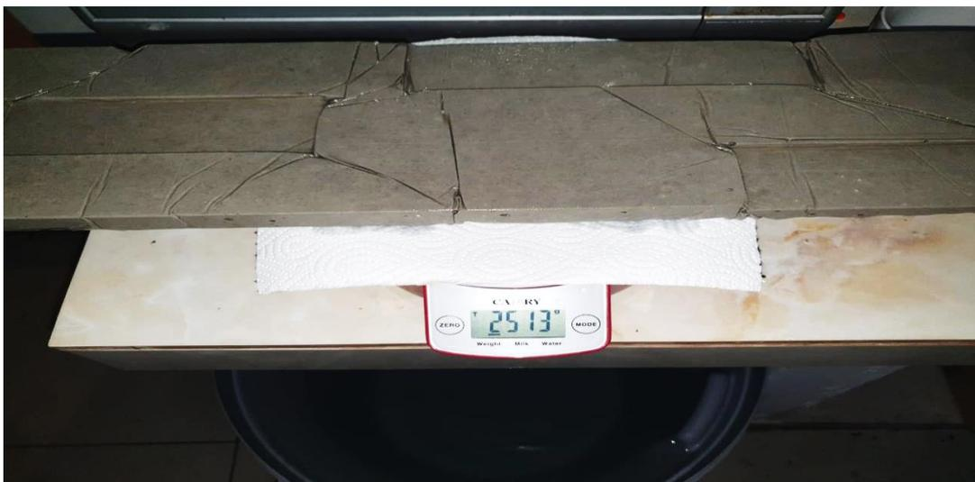
**Ilustración 55** Se pesa la fachaleta en la balanza gramera después de realizarle prueba de sumersión en agua.
