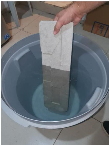
**Ilustración 48** Fachaleta de 60 x 15 x 2 centímetros en proceso de curado y prueba de sumersión
