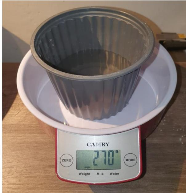
**Ilustración 41** Se pesó el componente del agua para la mezcla del mortero con poliestireno expandido. Según la dosificación calculada se pesó 270 gramos.
