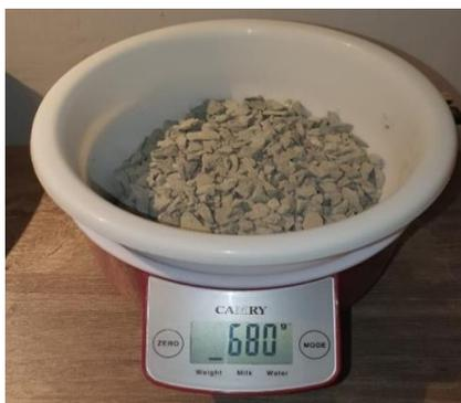
**Ilustración 39** Grava de 3/8 " pesada en la balanza gramera con 680 gramos según la dosificación especificada.
