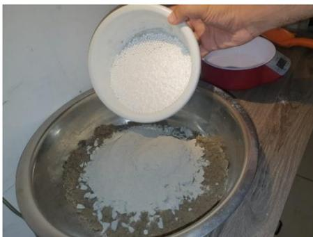
**Ilustración 38** Se coloca la cantidad o volumen del poliestireno (EPS) que representa el 50 % del peso del agregado grueso.
