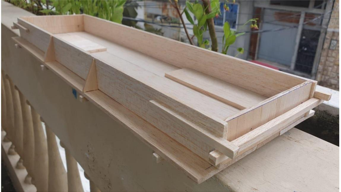
**Ilustración 32** Encofrado base que tiene soportes para cuando el mortero realice el correspondiente fraguado de 60 x 15 x 2 cms.
