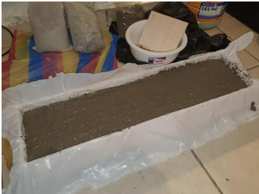
**Ilustración 44** Se varilló la mezcla en el encofrado para eliminar los espacios de vacío en la mezcla y se compacte de la mejor manera y de manera uniforme
