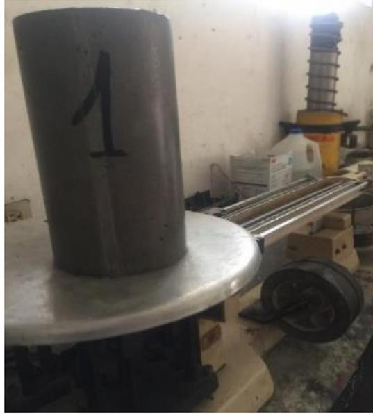
**Ilustración 16** Se procede a obtener pesos y dimensiones de los cilindros.
