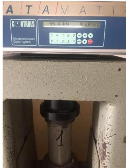
**Ilustración 21** Ensayo de compresión simple de los cilindros.
