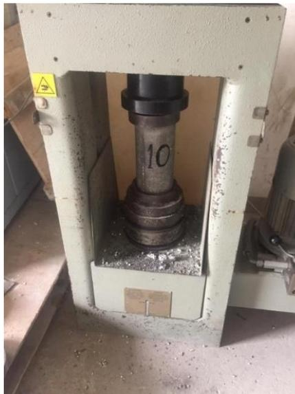
**Ilustración 24** Ensayo del cilindro #10 correspondiente a la muestra (M4) con el 100% de poliestireno (EPS) a los 7 días.
