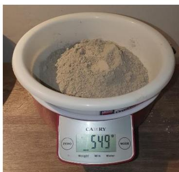
**Ilustración 36** Cantidad de cemento pesada en balanza gramera (549 gramos según dosificación calculada)
