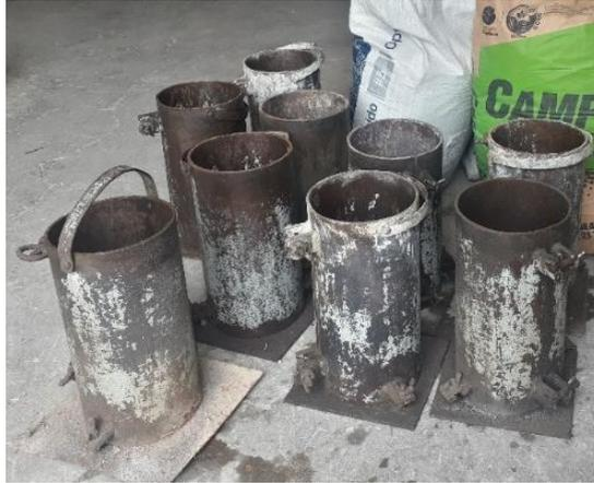
**Ilustración 12** Cilindros normados para la prueba de resistencia a la compresión.
