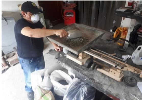
**Ilustración 6** Pesar el agregado grueso en la balanza gramera.
