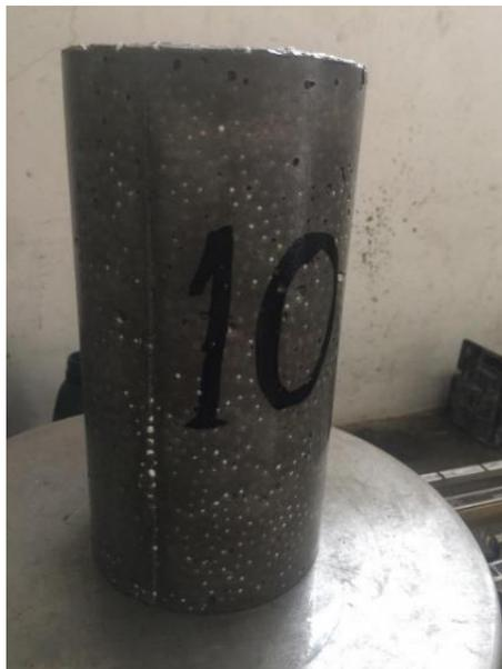
**Ilustración 19** Se pesa el cilindro con Ho normal y 0% EPS.
