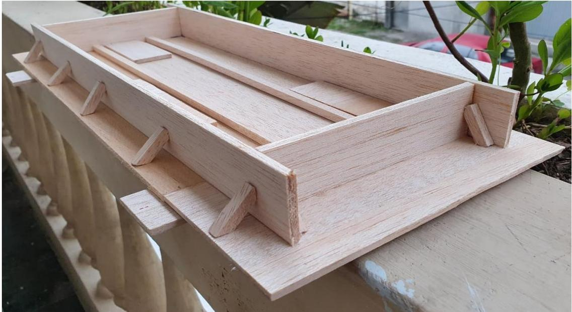
**Ilustración 30** Encofrado de madera con diseños en relieves para la fachaleta de 40 x 15 x 2 cms
