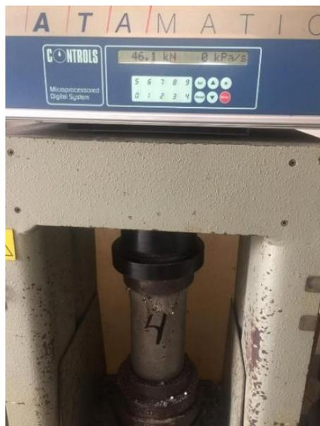
**Ilustración 22** Ensayo del cilindro #4 correspondiente a la muestra (M2) con el 50% de poliestireno (EPS) a los 7 días.
