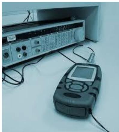
**Ilustración 50** Calibración de Sonómetro
