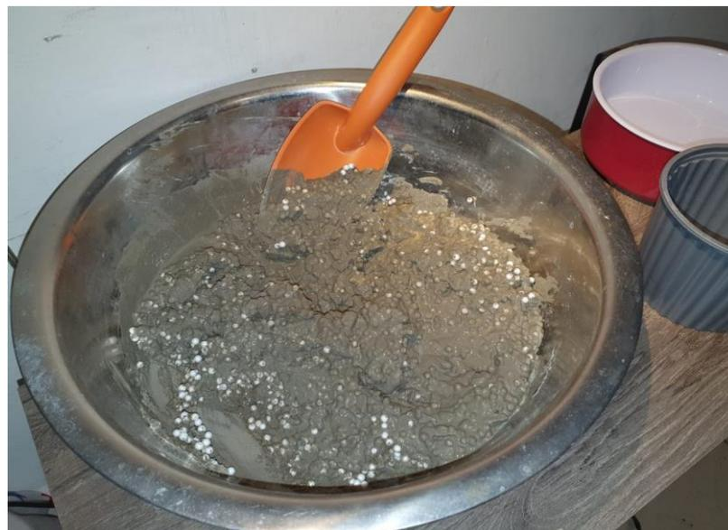
**Ilustración 42** Se mezclaron todos los materiales de la dosificación calculada
