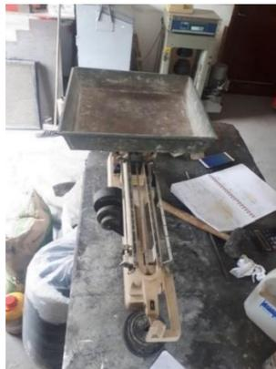
**Ilustración 5** Balanza gramera para medir los materiales con la dosificación a emplear.
