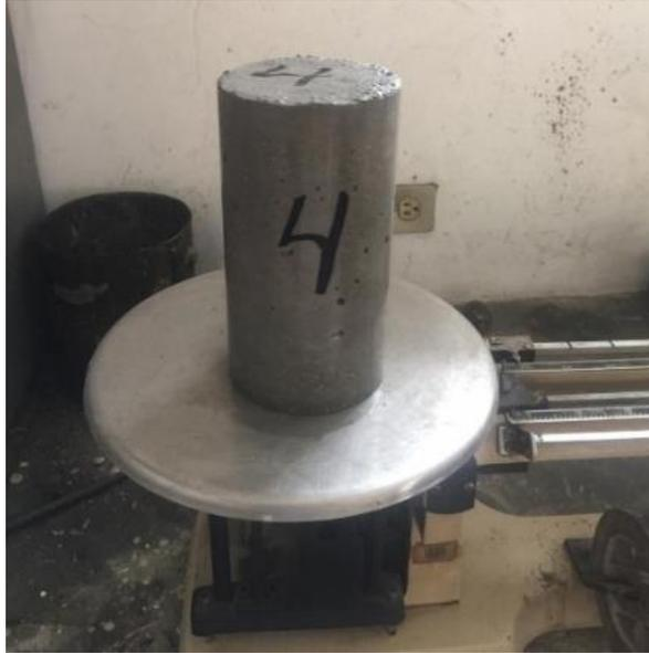
**Ilustración 18** Se pesa en la tara gramera cada cilindro.
