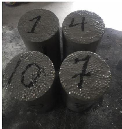
**Ilustración 15** Cilindros marcados según su dosificación antes del curado.
