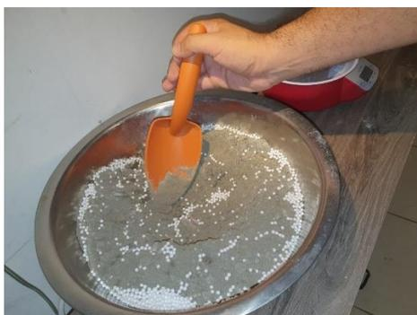
**Ilustración 40** Se colocó en un recipiente todos los materiales debidamente pesados en la balanza gramera según la dosificación previamente calculada.
