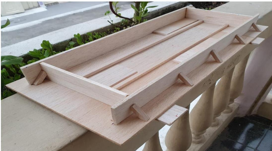
**Ilustración 29** Encofrado con diseño en relieves de 40 x 15 x 2 cms.
