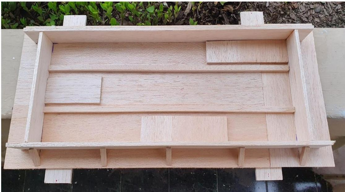
**Ilustración 31** Vista en planta del encofrado con relieve para la fachaleta de las dimensiones especificadas previamente de 40 x 15 x 2 cms.
