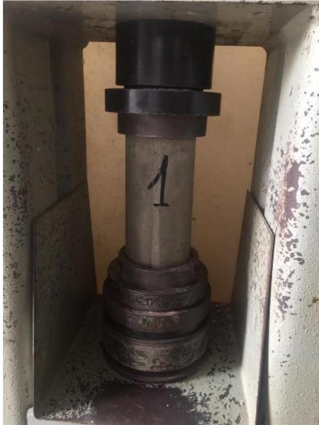
**Ilustración 20** Se procede por tanto a ensayar los cilindros a 7 días, 21 días y 28 días.
