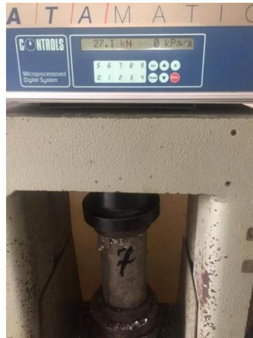
**Ilustración 23** Ensayo del cilindro #7 correspondiente a la muestra (M3) con el 75% de poliestireno (EPS) a los 7 días.
