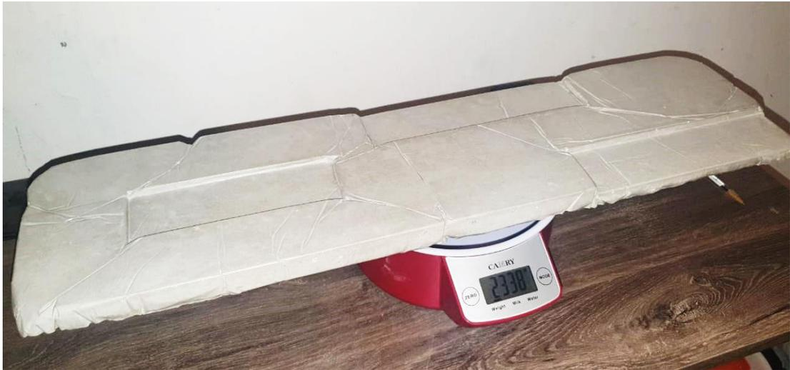
**Ilustración 62** Fachaleta de mortero con poliestireno expandido
