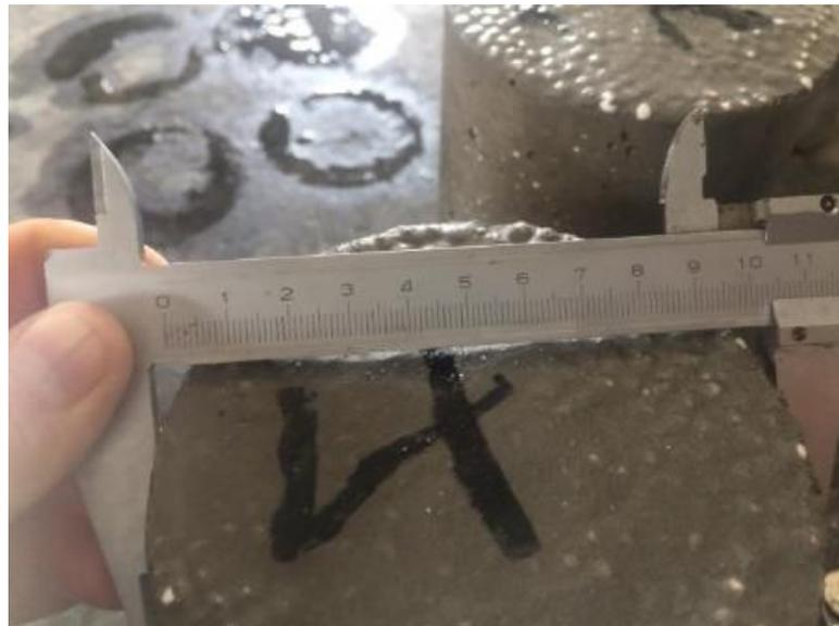
**Ilustración 17** Se mide el diámetro de cada cilindro.
