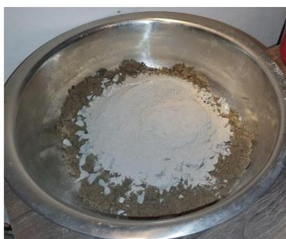
**Ilustración 37** Mezcla de materiales debidamente el peso especificado en la dosificación (Cemento + Arena)
