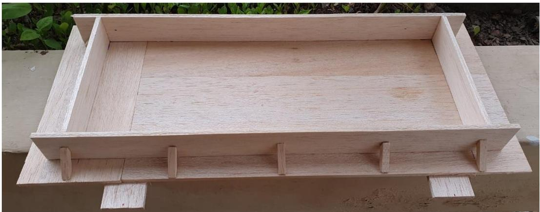
**Ilustración 27** Encofrado base para una fachaleta de 40 cm de base x 15 cm de altura y 2 cm de espesor.
