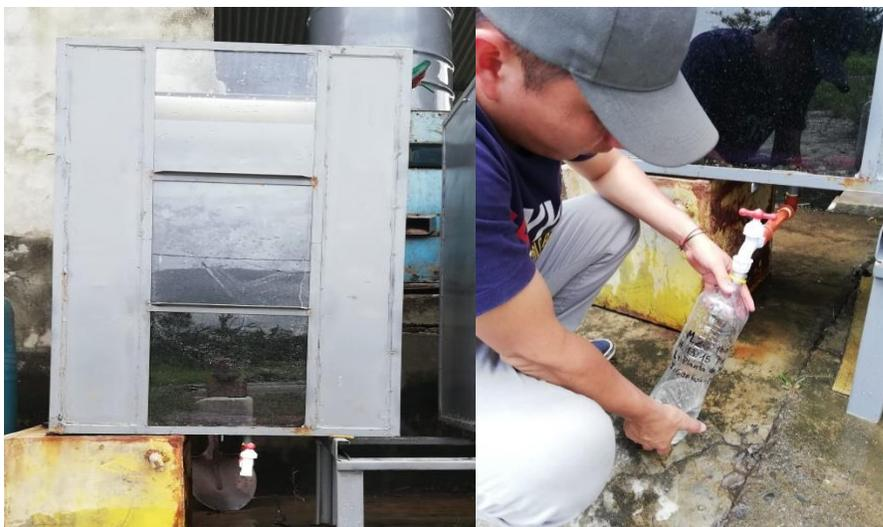
*Figura 33:* Toma de muestra 2 del Prototipo 1 / carbón activo cáscara de coco (0,60m).
