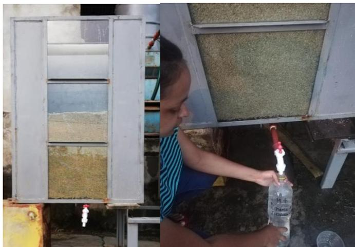
Figura 36: Vista del prototipo 1, caliza (0,60m) y toma de muestra 4, caliza e=0,60m.
