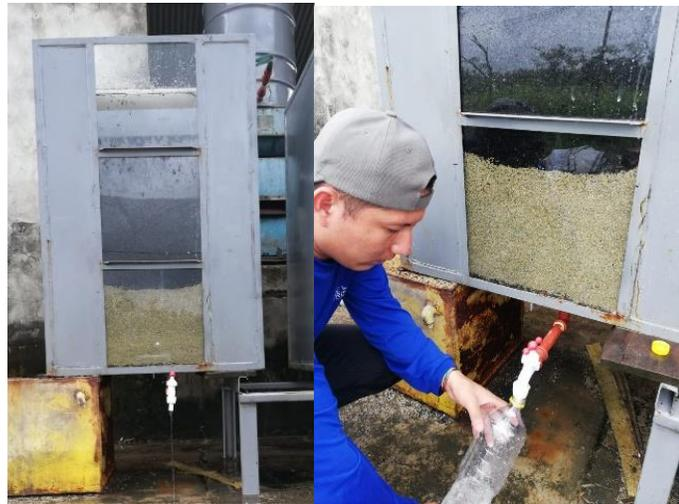
*Figura 39: Prototipo 1 y toma de muestra 6 / carbón activo cáscara de coco (0,30m) y caliza (0,30m).
