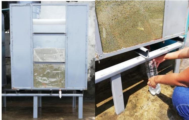
*Figura 34:* Toma de muestra 3 del prototipo 2 / caliza (0,60m).
