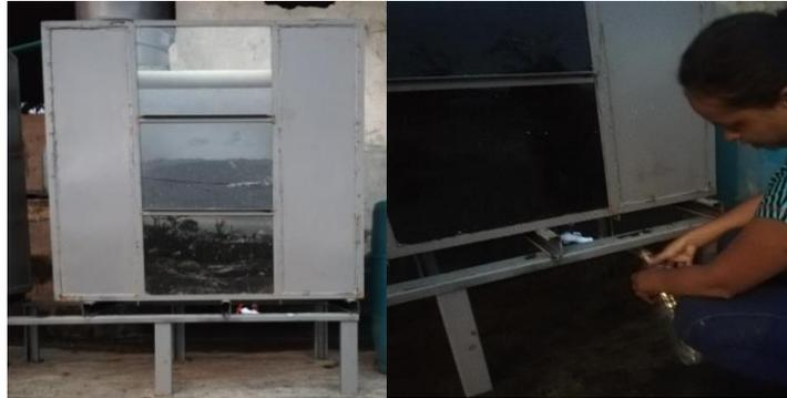
*Figura 37: Prototipo 2 / carbón activo cáscara de coco (0,60m) y la respectiva toma de la muestra 5.
