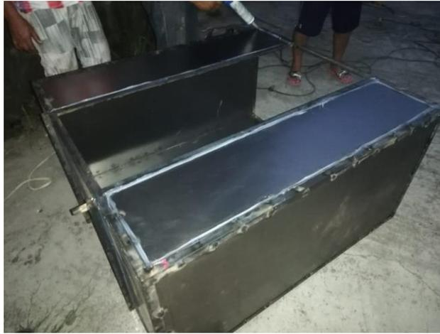
*Figura 25. Soldadura de neplo en las estructuras de los prototipos 1 y 2.*
