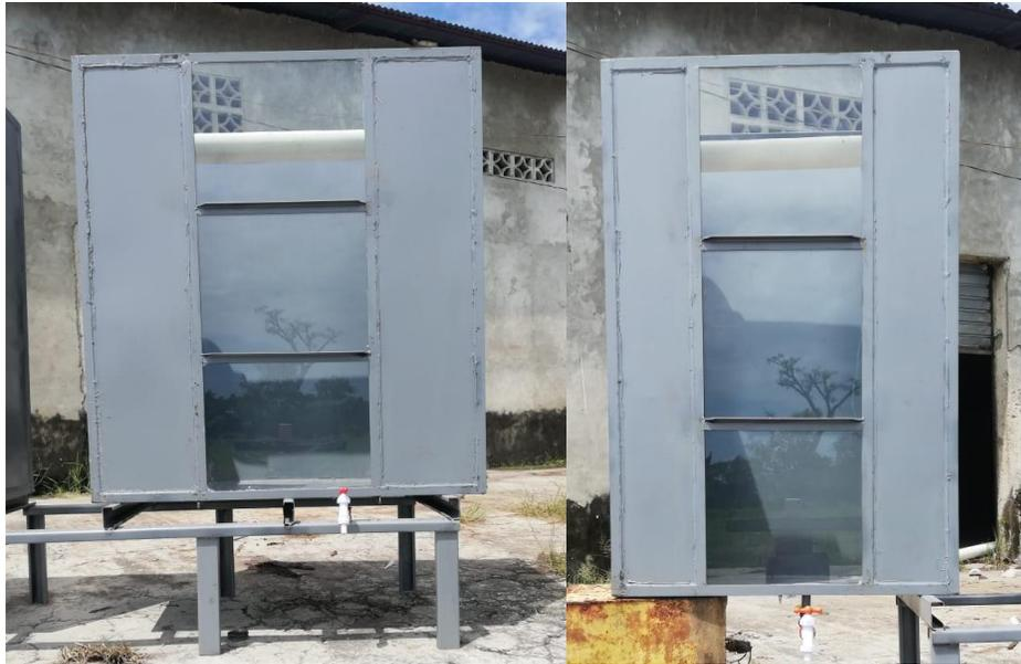
*Figura 29.* Montaje de vidrio en la estructura de los prototipos 1 y 2.
