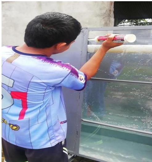
*Figura 30.* Sellado del vidrio en la estructura de los prototipos 1 y 2.
