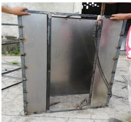
*Figura 24.* Soldadura de la estructura del prototipo 2.
