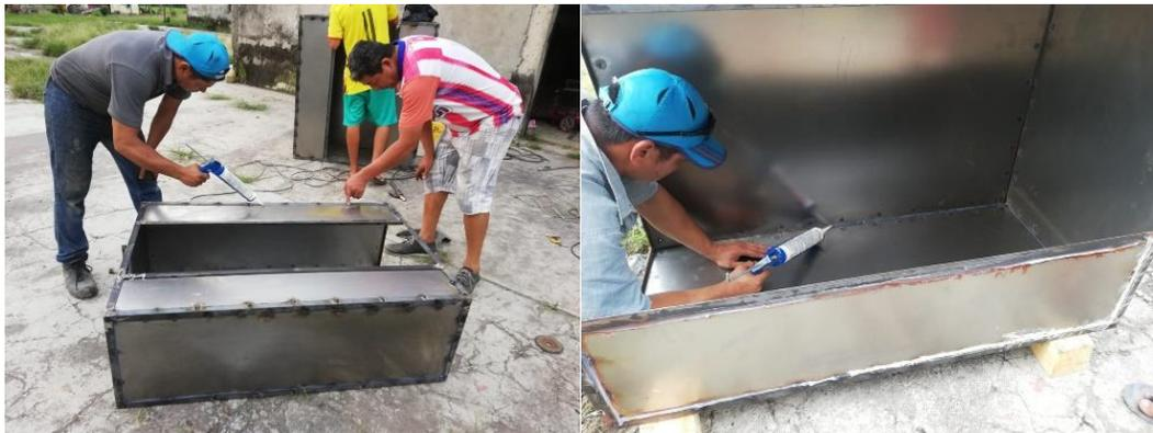
*Figura 26. Sellado de estructuras de los prototipos 1 y 2.*
