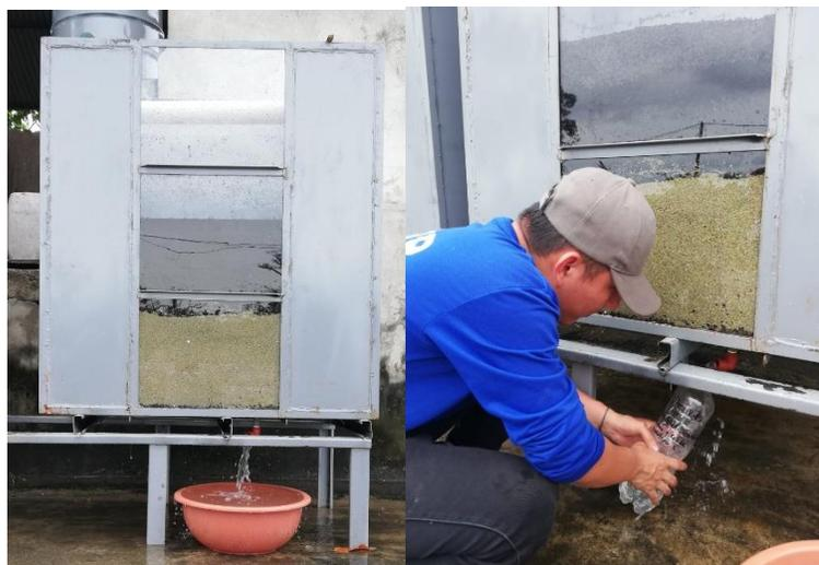
*Figura 40:* Prototipo 2, carbón activo cáscara de coco (0,30m) y caliza (0,30m) y toma de la muestra 7.
