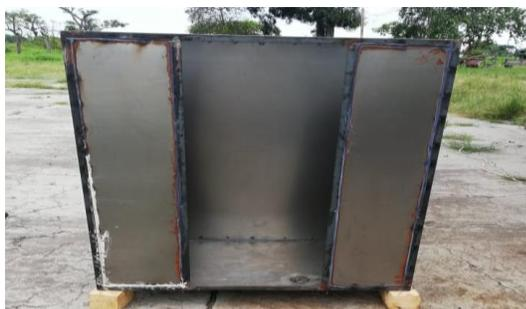
*Figura 23.* Soldadura de las planchas metálicas del prototipo 1.
