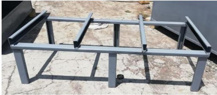
*Figura 19: Ensamble de estructura para los prototipos.
