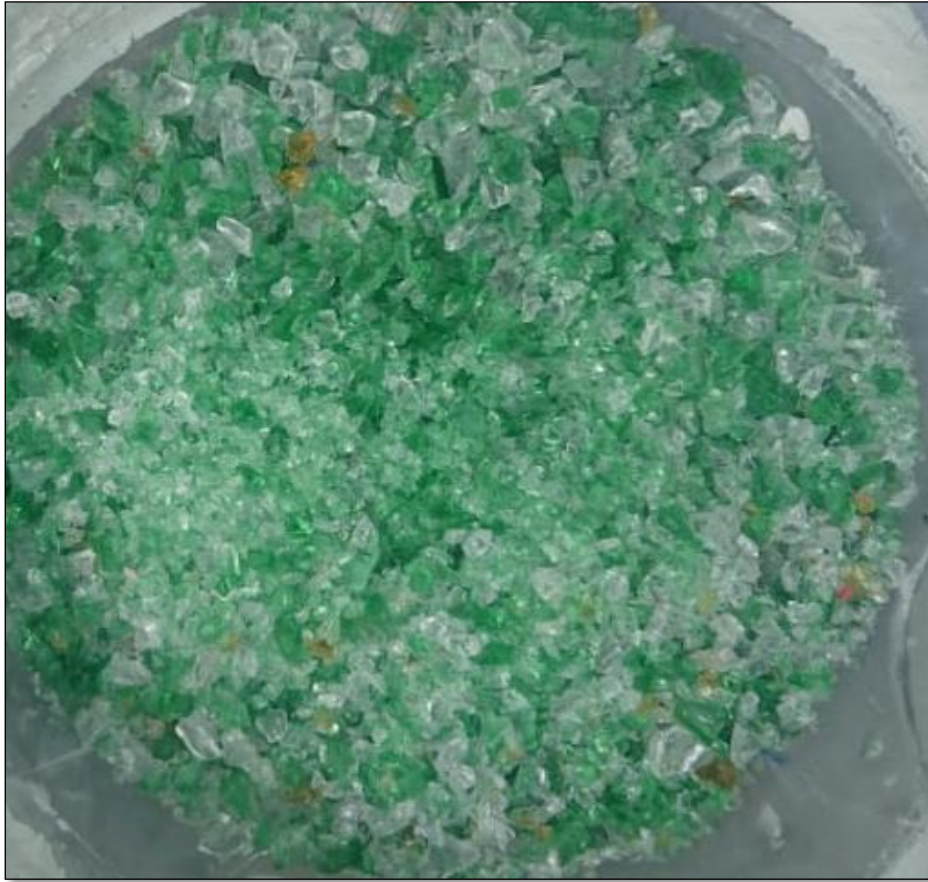
Figura 33: Triturado del vidrio.
