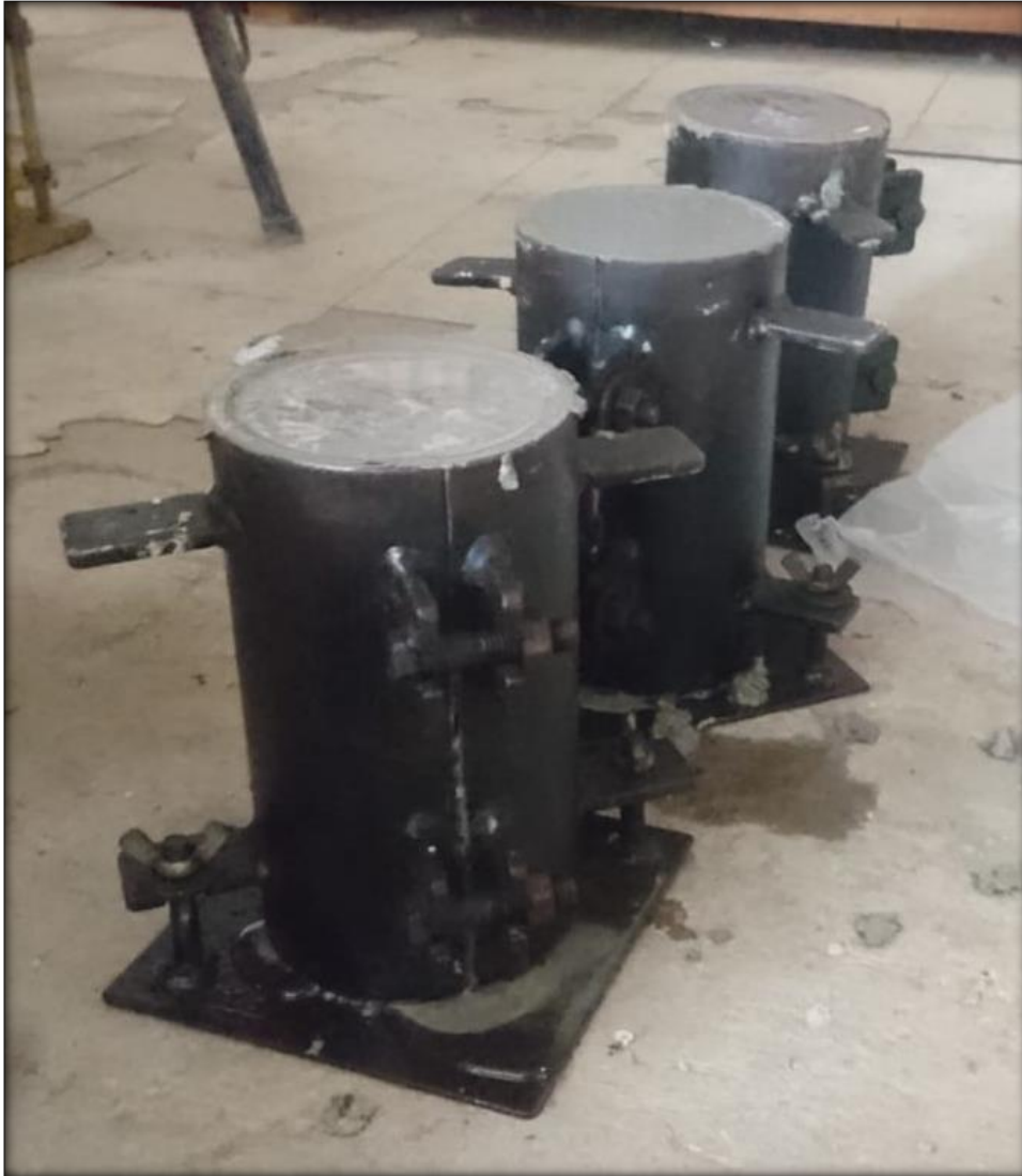
Figura 42: Cilindros para la prueba de rotura.
