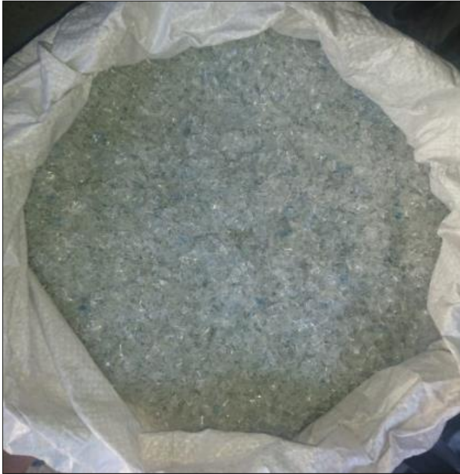
Figura 34: Triturado del plástico.
