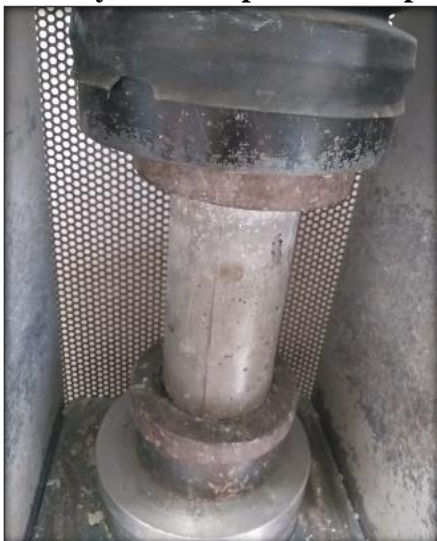
Figura 45: Ensayo de compresión simple.
