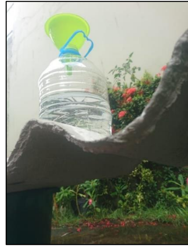
Figura 44: Prueba de permeabilidad.
