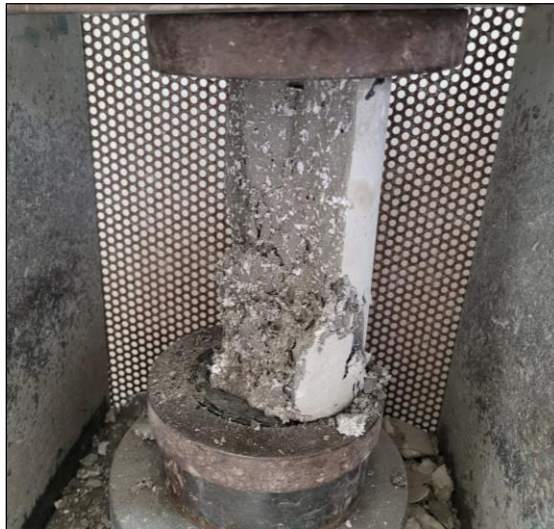
Figura 49: Prototipo 1, rotura a los 7 días.
