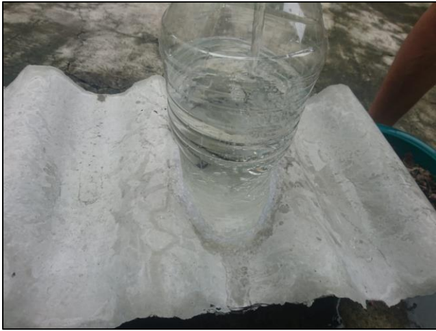
Figura 43: Prueba de permeabilidad.
