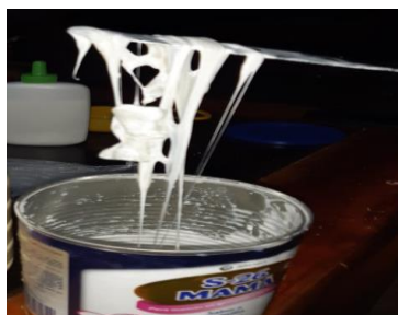
Figura 49. Mezcla de componentes (poliestireno reciclado 5,20 kg, cabuya picada 1 lb, hoja de choclo molida 400gr y entrecruzador 0,1kg ).
