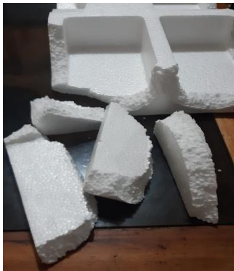
Figura 59. Trituración del poliestireno reciclado.
