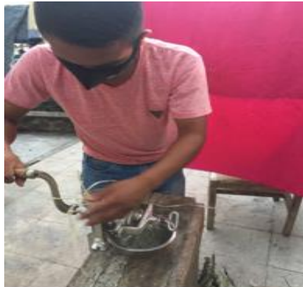
Figura 61. Molienda utilizada para obtener la pulverización de la fibra de choclo.
