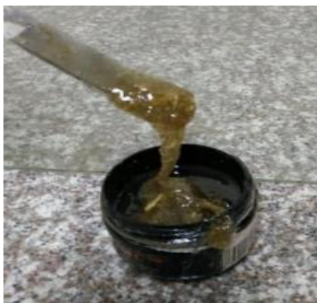
Figura 47. Mezcla de componentes (poliestireno reciclado 5,20 Kg, cabuya picada 0,50 Lb, hoja de choclo molida 200gr y entrecruzador 0,1kg).
