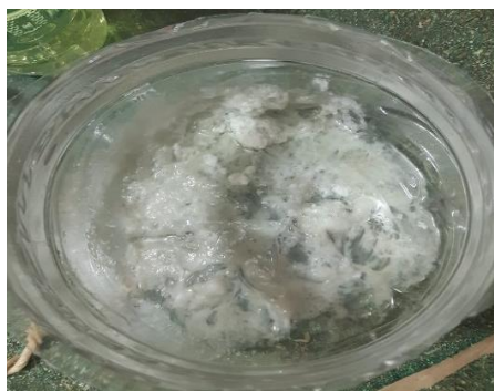
Figura 48. Mezcla de componentes (poliestireno reciclado, hoja de choclo y cabuya).
