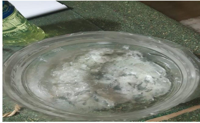
Figura 43. Mezcla de (poliestireno reciclado, fibra de choclo y resina de cabuya).
