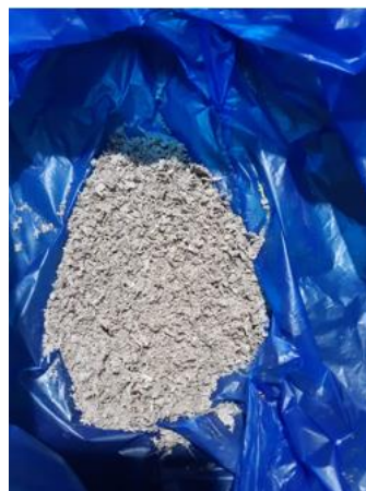
Figura 62. Pulverización de la fibra de choclo.
