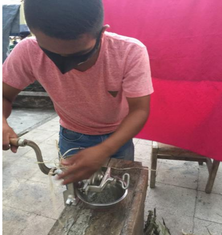
Figura 37. Molienda utilizada para la obtención de fibra de choclo.
