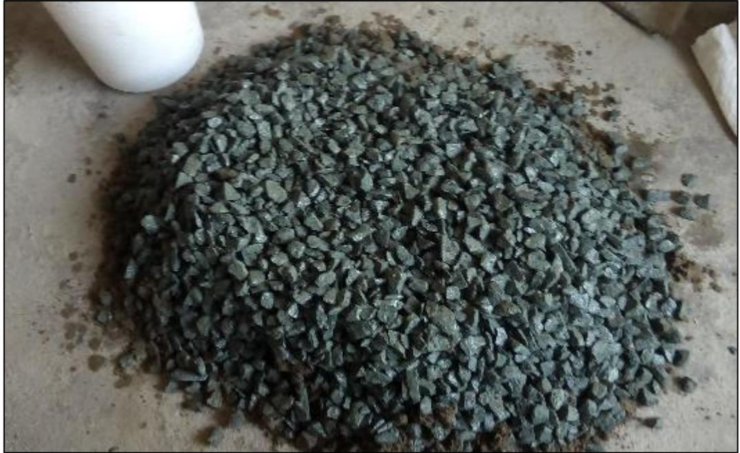
Figura 21 Cama de arena y piedra para producir hormigón no tradicional
