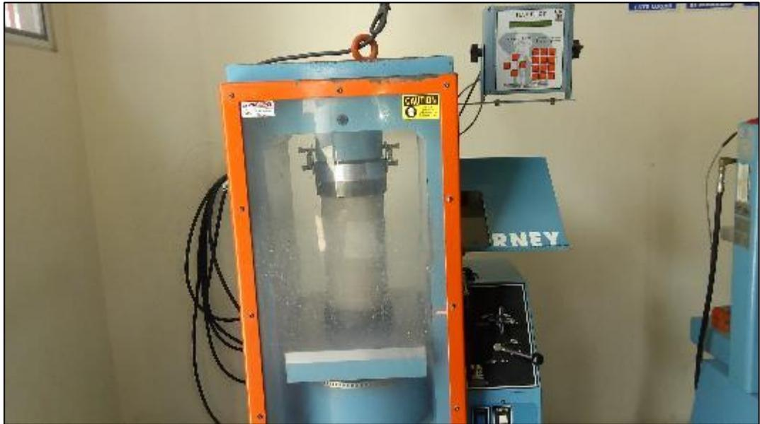
Figura 55 Cuarta rotura hormigón tradicional T-0
