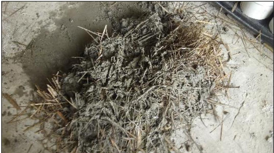
Figura 28 Hormigón no tradicional con la sustitución del 75% del agregado grueso con fibras.
