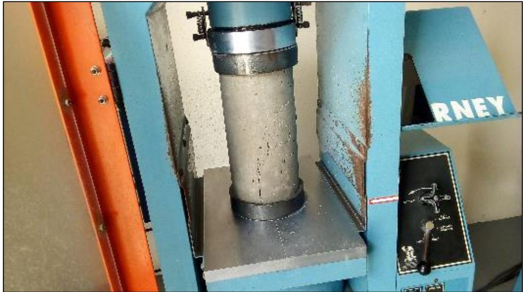
Figura 43 Primera rotura hormigón no tradicional con sustitución del 25% de piedra. T-1
