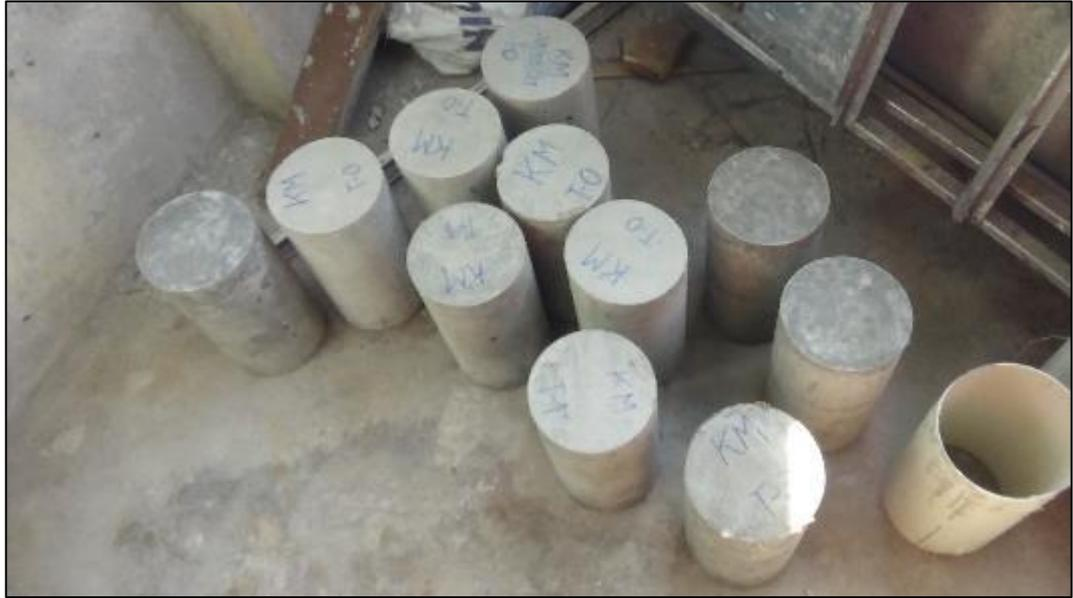
Figura 37. Desmoldado y codificación.
