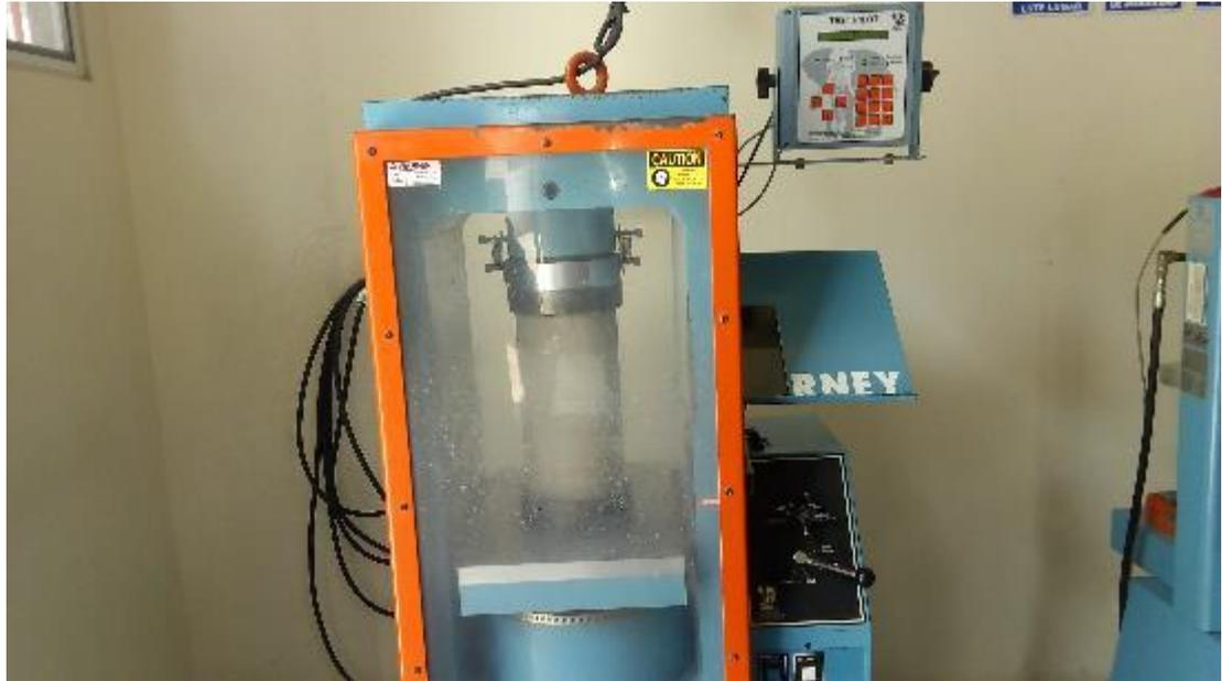
Figura 49 Segunda rotura hormigón no tradicional con sustitución del 50% de piedra. T-2
