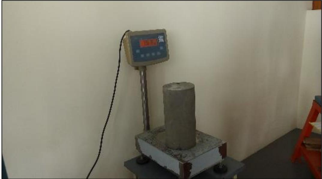
Figura 41 Pesado de cilindros
