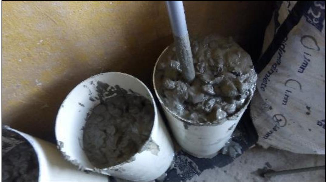
Figura 35 Vaciado de tercera capa.
