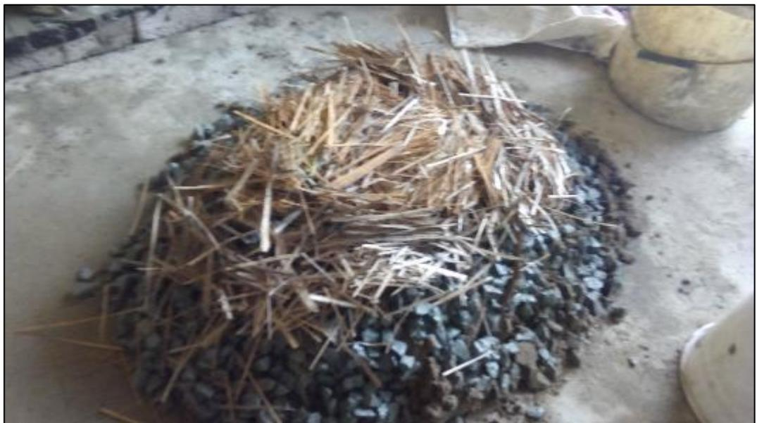
Figura 22 Sustitución del 25% de piedra con fibra de hoja de palma cocotera.
