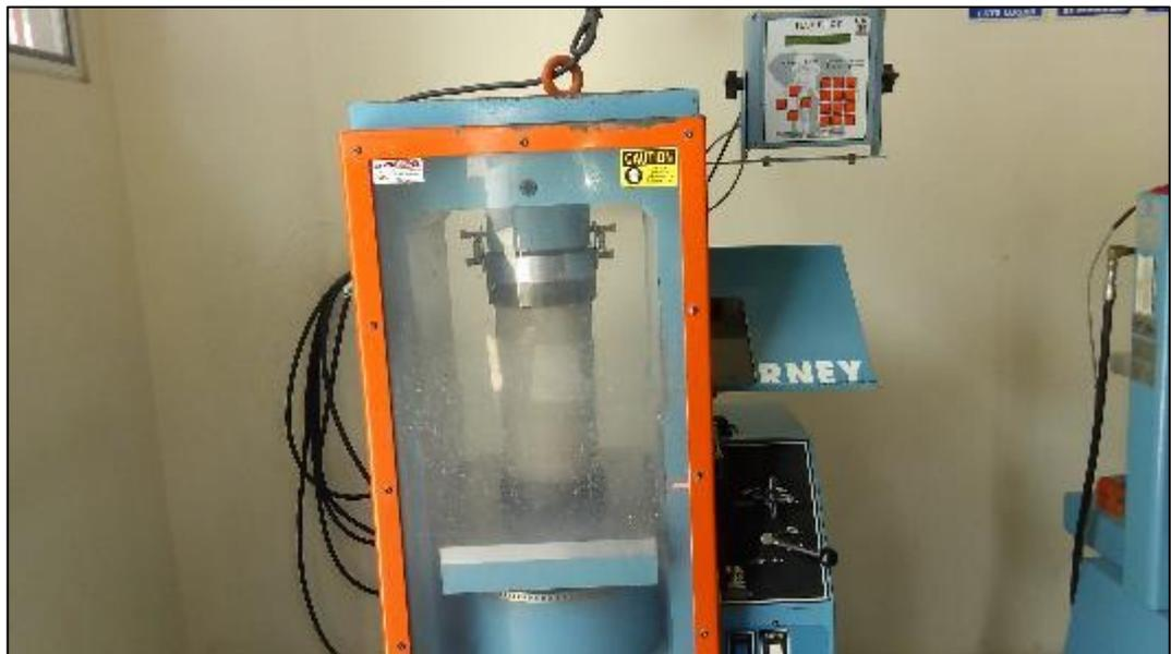
Figura 44 Primera rotura hormigón no tradicional con sustitución del 50% de piedra. T-2
