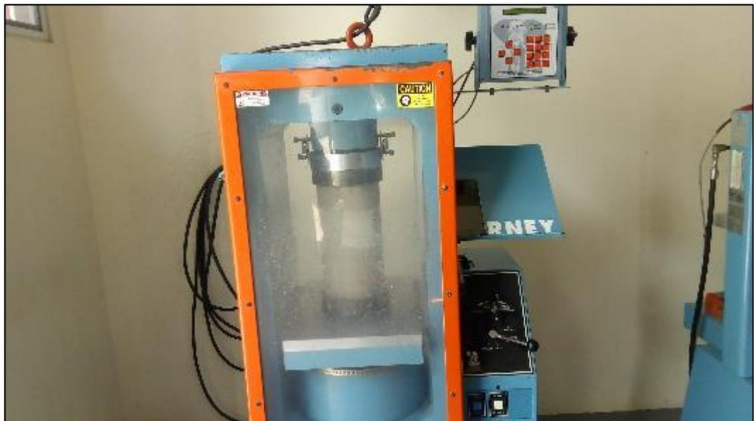
Figura 52 Tercera rotura hormigón no tradicional con sustitución del 25% de piedra. T-1
