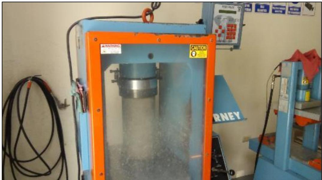
Figura 54 Tercera rotura hormigón no tradicional con sustitución del 55% de piedra. T-3
