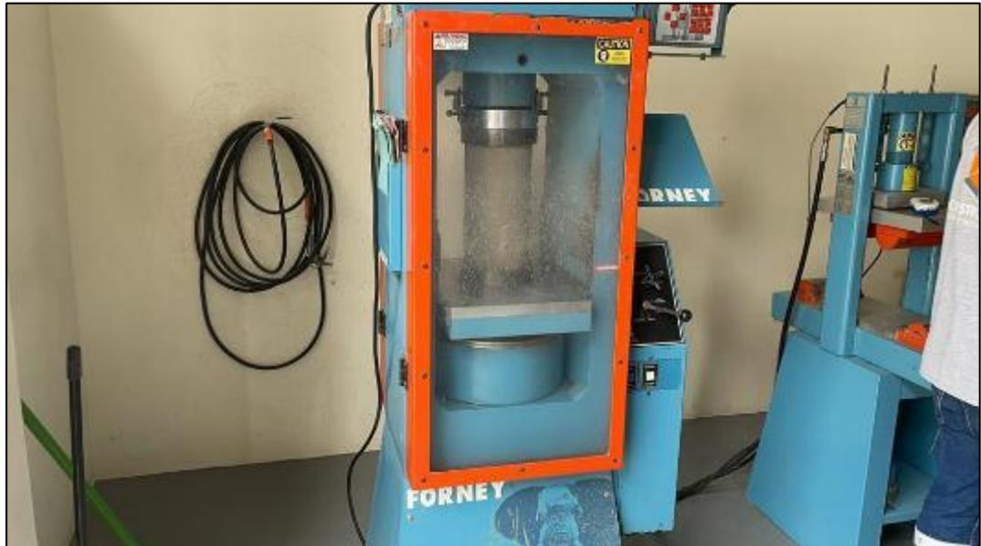
Figura 51 Tercera rotura hormigón tradicional T-0
