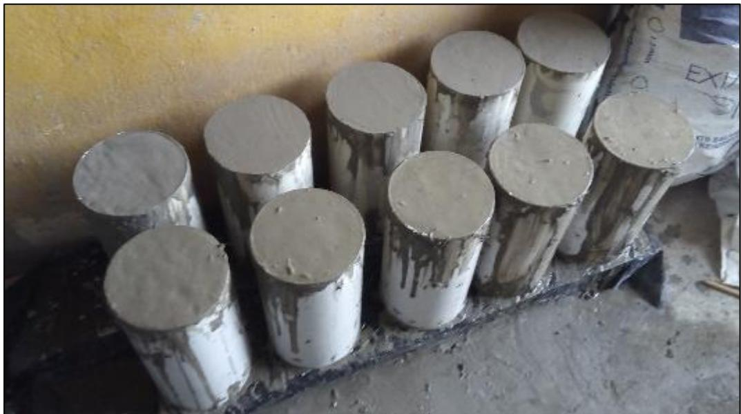
Figura 36 Vaciado de tercera capa y alisado.
