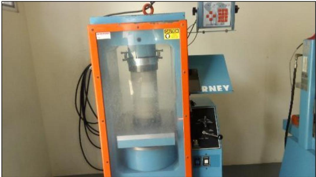
Figura 42 Primera rotura hormigón tradicional T-0
