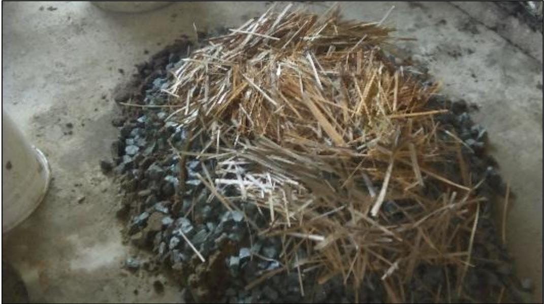
Figura 23 Sustitución del 50% de piedra con fibra de hoja de palma cocotera.
