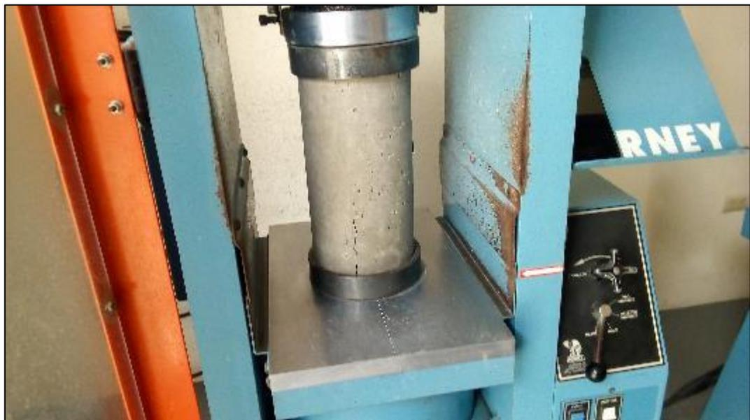
Figura 50 Segunda rotura hormigón no tradicional con sustitución del 75% de piedra. T-3
