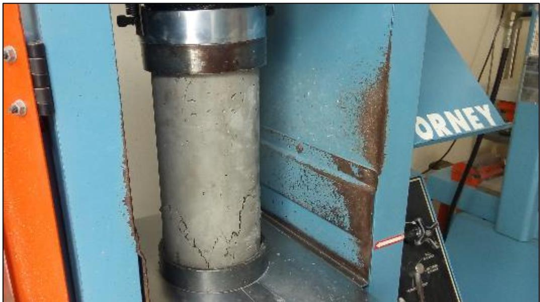
Figura 56 Cuarta rotura hormigón no tradicional con sustitución del 25% de piedra. T-1
