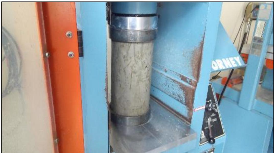
Figura 48 Segunda rotura hormigón no tradicional con sustitución del 25% de piedra. T-1
