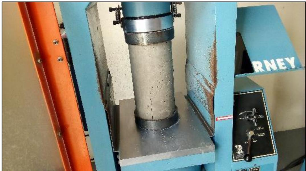
Figura 58 Cuarta rotura hormigón no tradicional con sustitución del 75% de piedra. T-3
