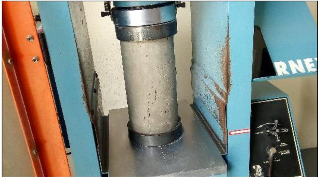
Figura 53 Tercera rotura hormigón no tradicional con sustitución del 50% de piedra. T-2
