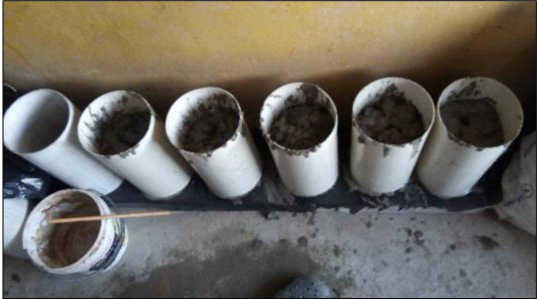
Figura 33 Vaciado de segunda capa.
