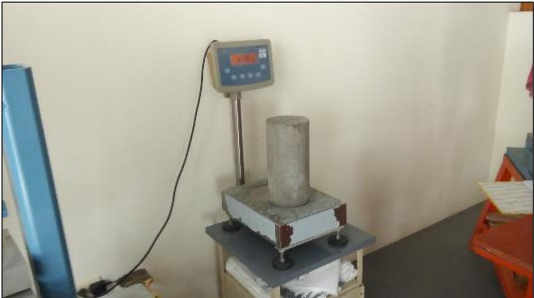
Figura 40 Pesado de cilindros
