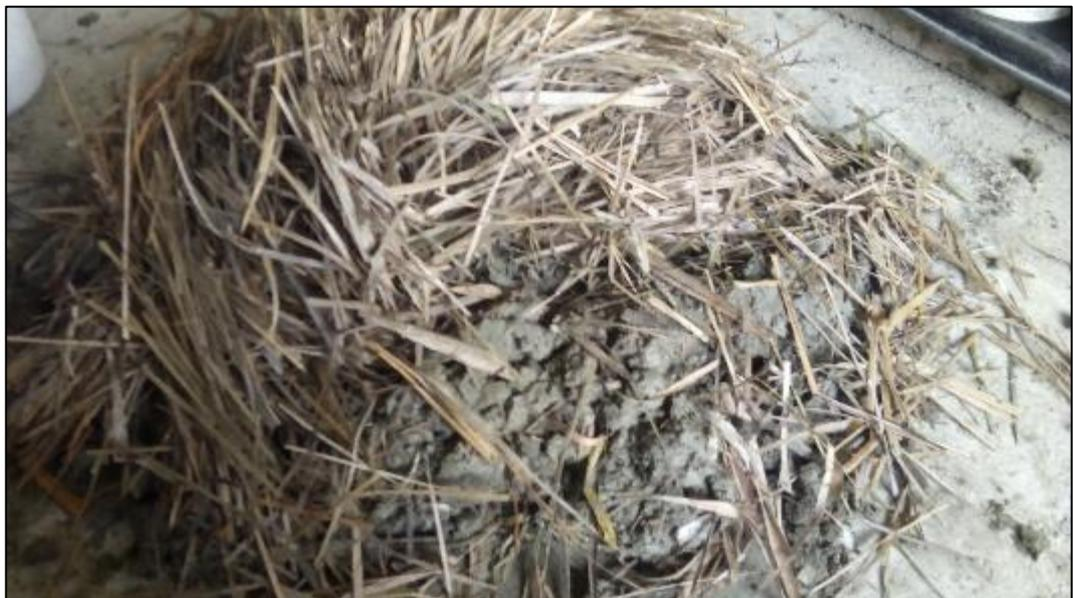
Figura 26 Adición de fibras al hormigón.
