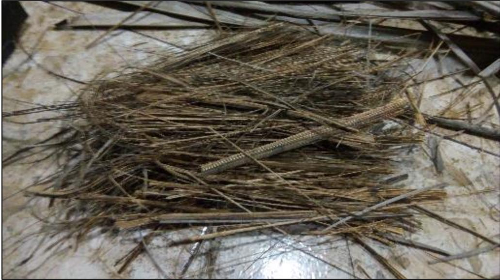
Figura 9 Desfibrado de hoja seca de cocotero
