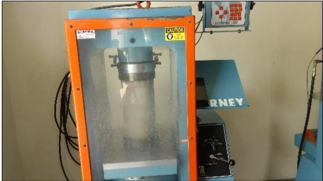
Figura 57 Cuarta rotura hormigón no tradicional con sustitución del 50% de piedra. T-2
