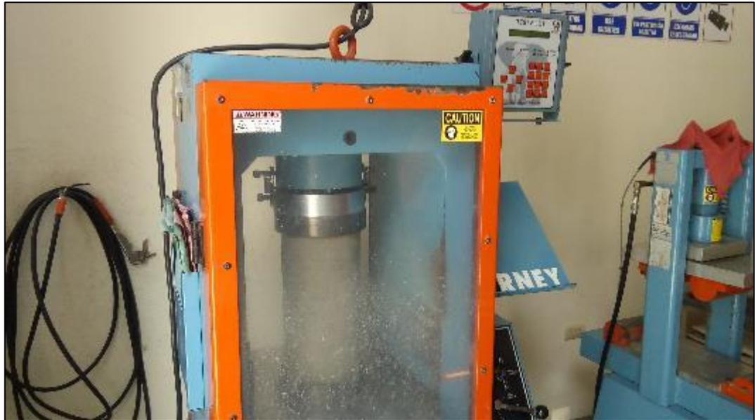
Figura 45 Primera rotura hormigón no tradicional con sustitución del 75% de piedra. T-3
