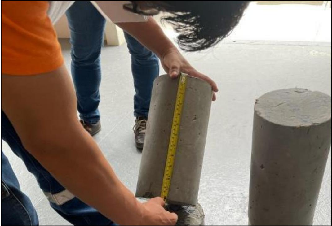
Figura 39 Comprobación de dimensiones de cilindros.
