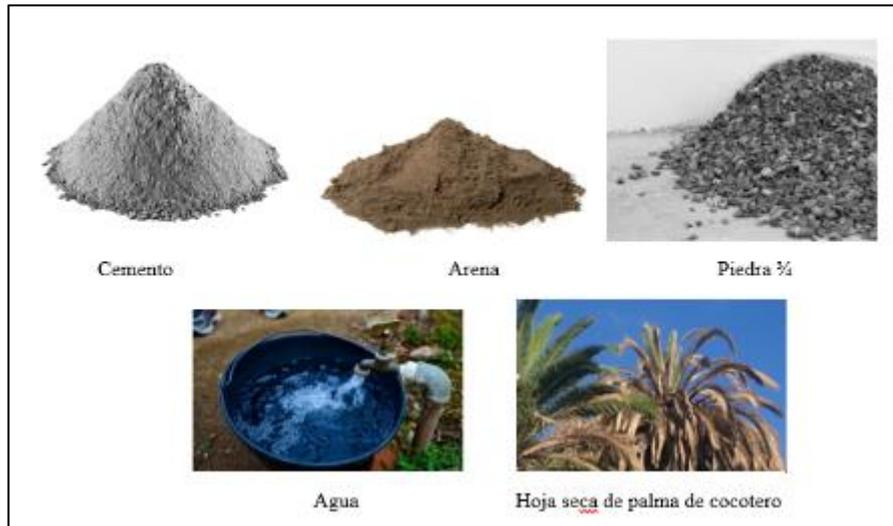
Figura 5. Materia prima para elaborar hormigón no tradicional.
