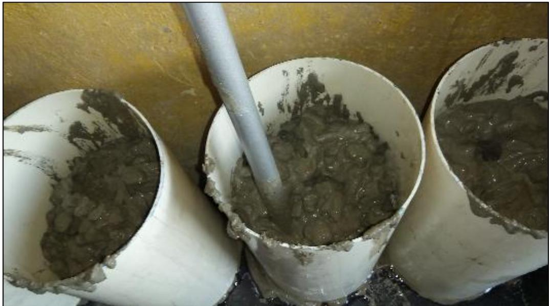
Figura 32 Vaciado de segunda capa
