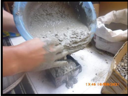
7.- Se coloca la mezcla en el diseño previamente seleccionado.
