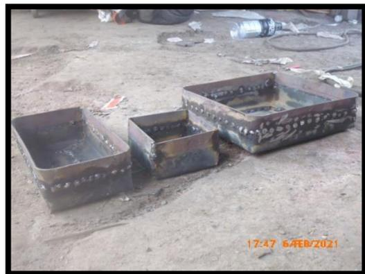
**Figura 46:** Moldes para adoquines, metálicos.
