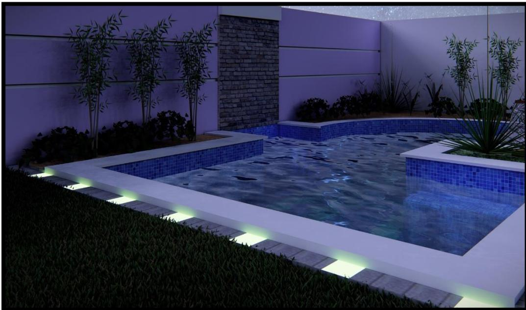
**Figura 67:** Implementación del adoquín PET 3 con goma sintética reflectiva en el borde de piscina como decoración y a su vez iluminación.
