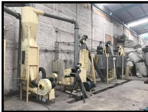
**Figura 29.** Centrifugado y lavado de plástico
