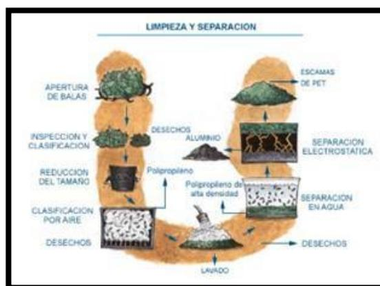
**Figura 21.** Limpieza y separación de los plásticos
