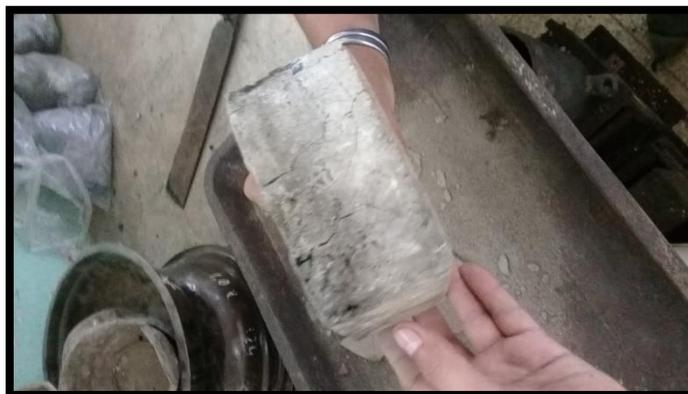
3 Adoquín con fisura.
