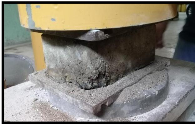
2 Adoquín resistió 50.000 kg de presión antes de agrietarse.
