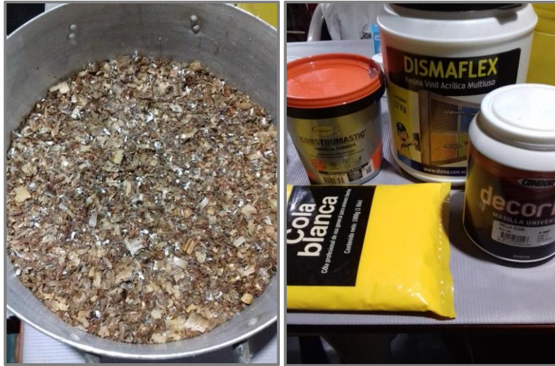
Imagen 35 y 36. Mezcla combinada de tetrabrik y virutas Elaborado por: Gonzáles, R (2021)
