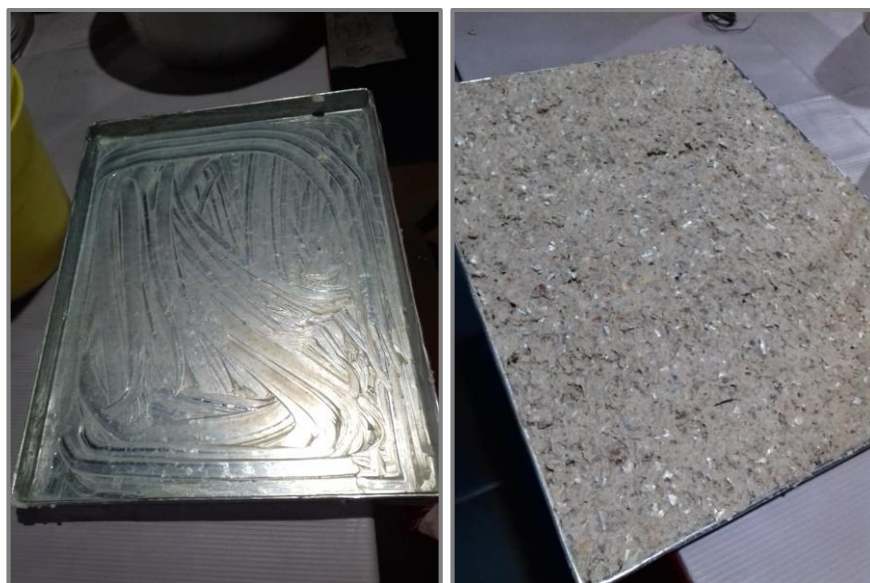
Imagen 24 y 25. Molde engrasado y mezcla lista para el fuego Elaborado por: Gonzáles, R (2021)
