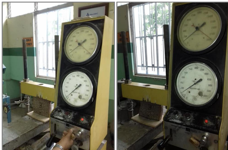
Imagen 42 y 43. Realización de prueba de compresión Elaborado por: Gonzáles, R (2021)
