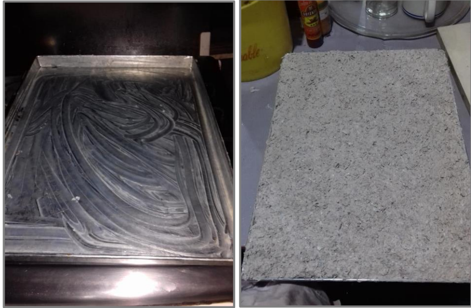
Imagen 31 y 32. Colocación de mezcla compuesta en el molde engrasado Elaborado por: Gonzáles, R (2021)
