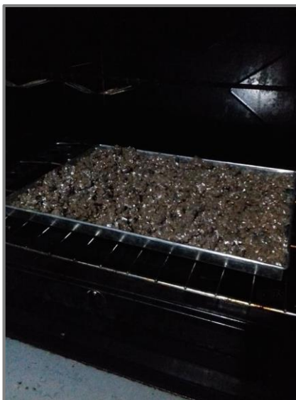
Imagen 34. Masa a fuego lento para descartar agua y humedad. Elaborado por: Gonzáles, R (2021)
