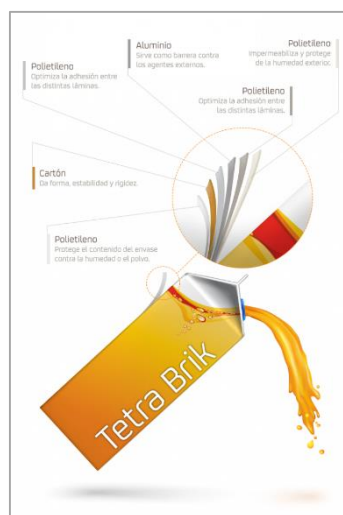
Figura.4. Composición de un envase de tetrabrik Fuente: terra.org (2018)
