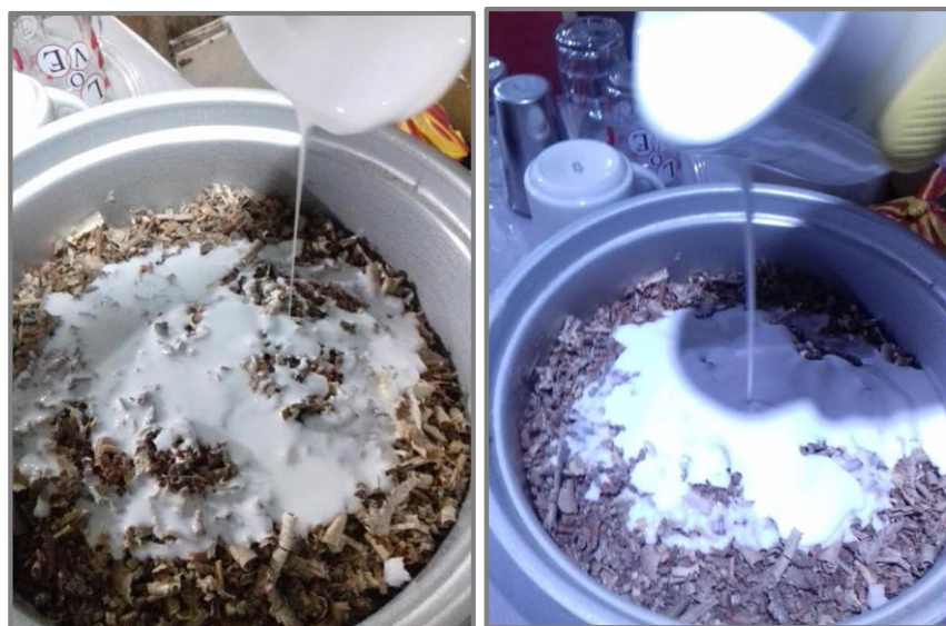
Imagen 21 y 22. Mezcla de Blancola y resina de vinil acrílico (Resaflex) Elaborado por: Gonzáles, R (2021)
