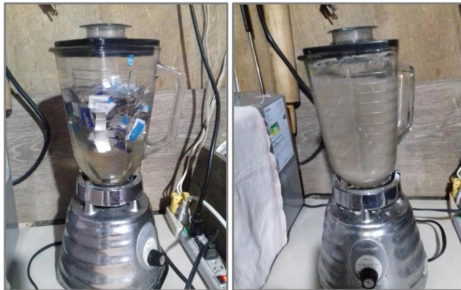
Imagen 14 y 15. Licuado de materia prima “envases de tetrabrik” cortados Elaborado por: Gonzáles, R (2021)
