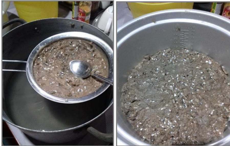
Imagen 16 y 17. Masa post licuado de materia prima “envases de tetrabrik” cortados Elaborado por: Gonzáles, R (2021)
