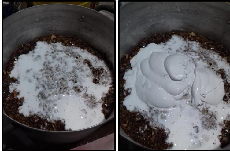
Imagen 28 y 29. Blancola y Masilla elastomérica mezclados Elaborado por: Gonzáles, R (2021)
