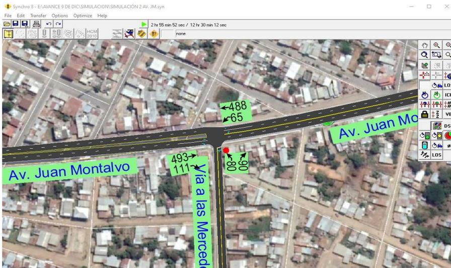
Figura 54 Implantación e ingreso de volúmenes vehiculares de la intersección en el Software Synchro 8.
