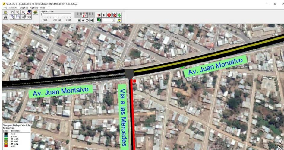
**Figura 56** Detención y demora de vehículos en la intersección Av. Juan Montalvo y vía a las Mercedes.
