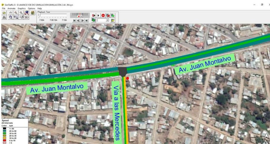
Figura 55 Velocidad promedio de los flujos vehiculares en la intersección.
