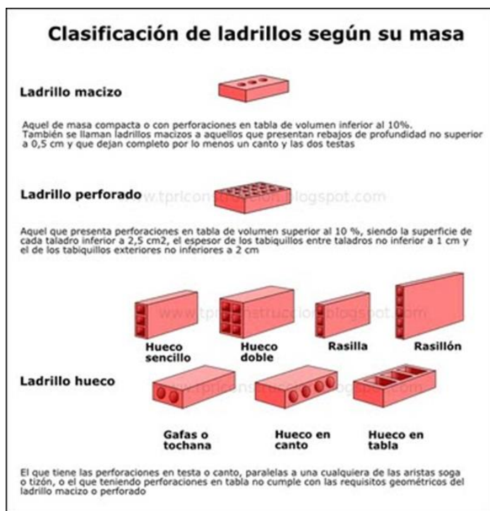
Figura 15: Clasificación de ladrillo según su masa
