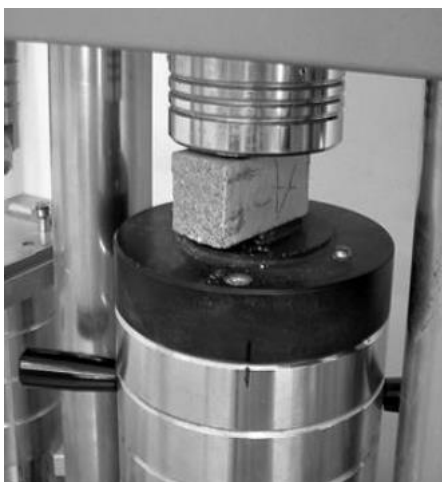
Figura 5: Prensa para ensayo de compresión
