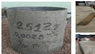
Figura 42: Balde metálico para densidad suelta y varillada Elaborado por; Andrade, O.; Jouve, A. (2021)
