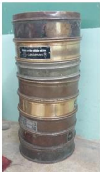
Figura 21: Equipos para ensayos de granulometría Elaborado por: Andrade, O.; Jouve, A. (2021)
