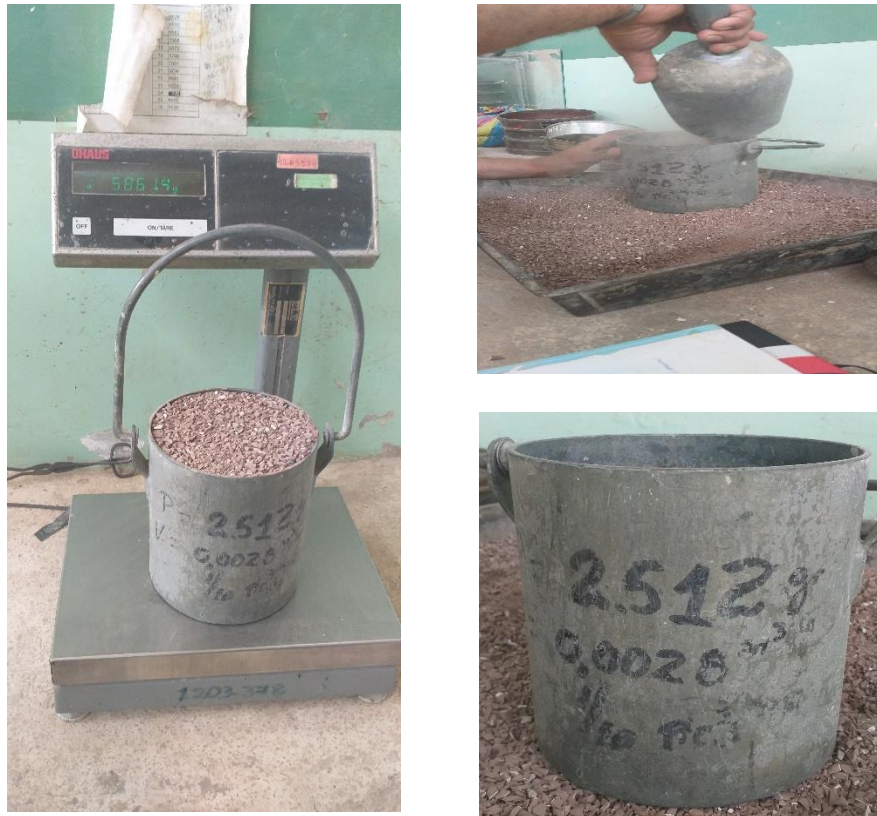
Figura 44: Elaboración del peso volumétrico Elaborado por: Andrade, O.; Jouve, A. (2021)
