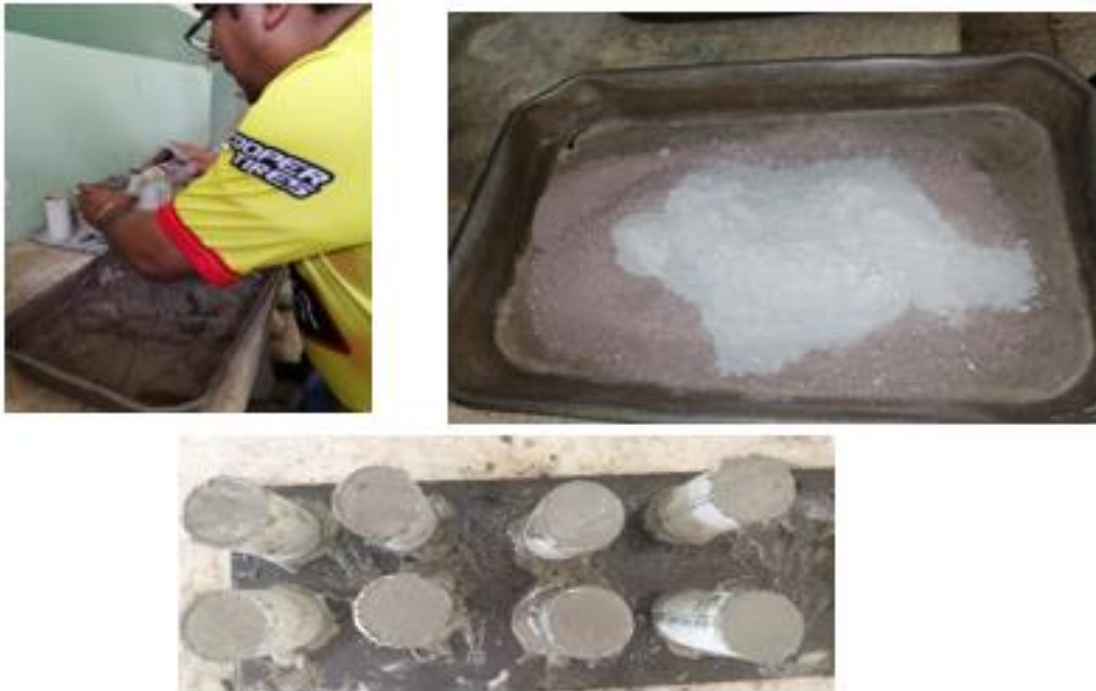
Figura 55: Elaboración de los cilindros Elaborado por: Andrade, O.; Jouve, A. (2021)
