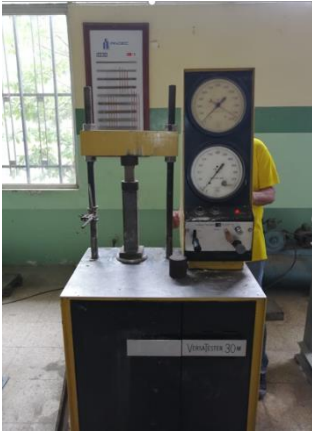
Figura 54: Máquina de rotura de mortero de hormigón Elaborado por: Andrade, O.; Jouve, A. (2021)
