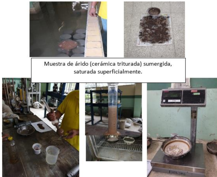
Figura 33: Procedimiento para ensayo de absorción y densidad del agregado fino Elaborado por: Andrade, O.; Jouve, A. (2021)
