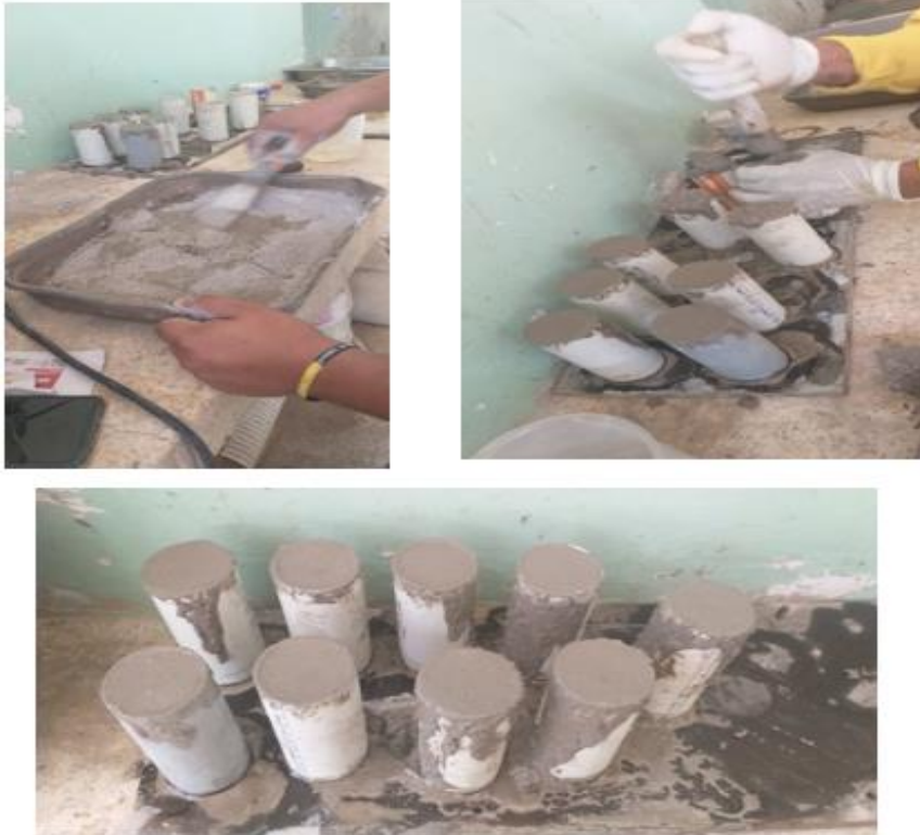
Figura 52: Elaboración de los cilindros Elaborado por: Andrade, O.; Jouve, A. (2021)
