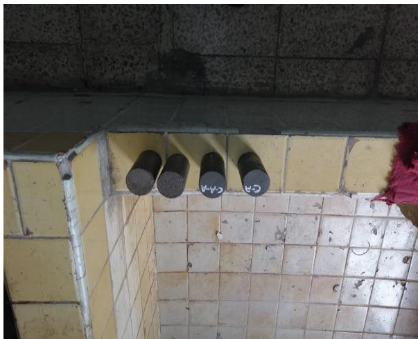
Figura 53: Curado de la muestra Elaborado por: Andrade, O.; Jouve, A. (2021)
