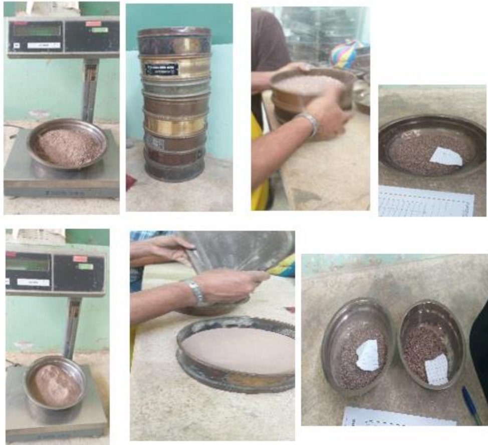
Figura 24: Proceso de la elaboración de la granulometría. Elaborado por: Andrade, O.; Jouve, A. (2021)
