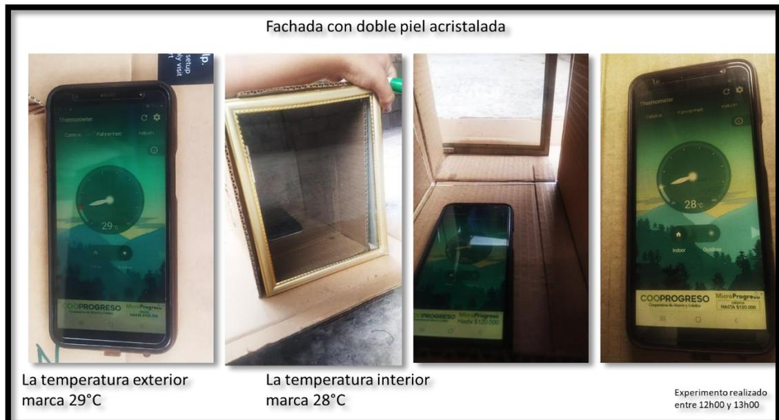
**Figura 74.** Prueba de confort con fachada acristalada doble
