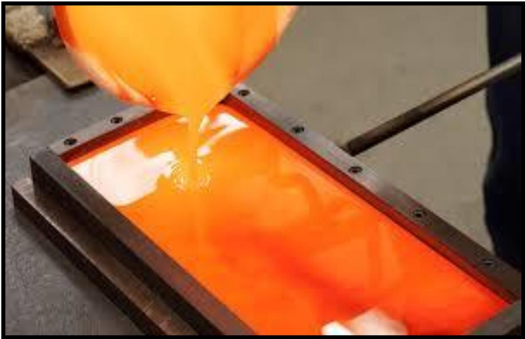
**Figura 27.** Fundición del vidrio
