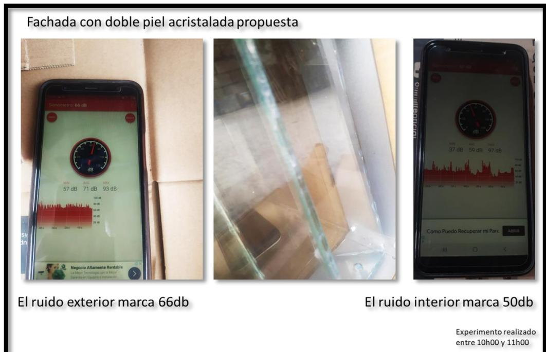
**Figura 78.** Prueba de ruido con fachada acristalada doble propuesta
