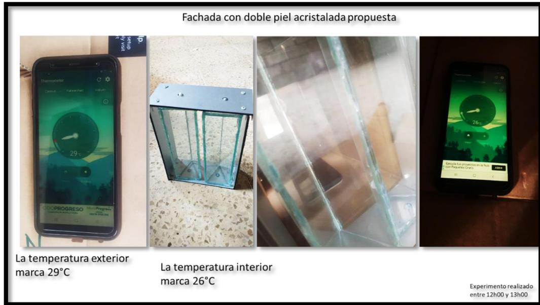
**Figura 75.** Prueba de confort con fachada acristalada doble propuesta
