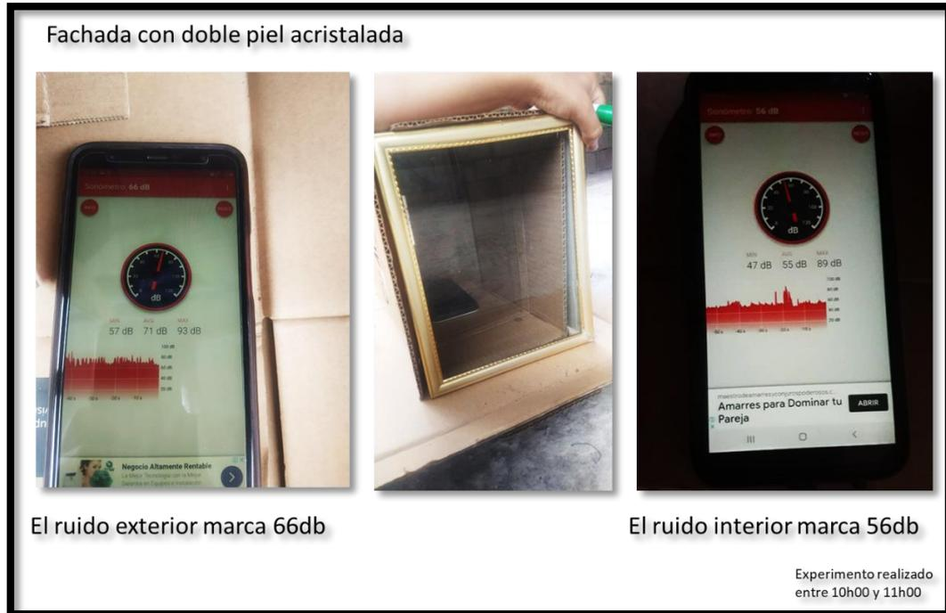
**Figura 77.** Prueba de ruido con fachada acristalada doble
