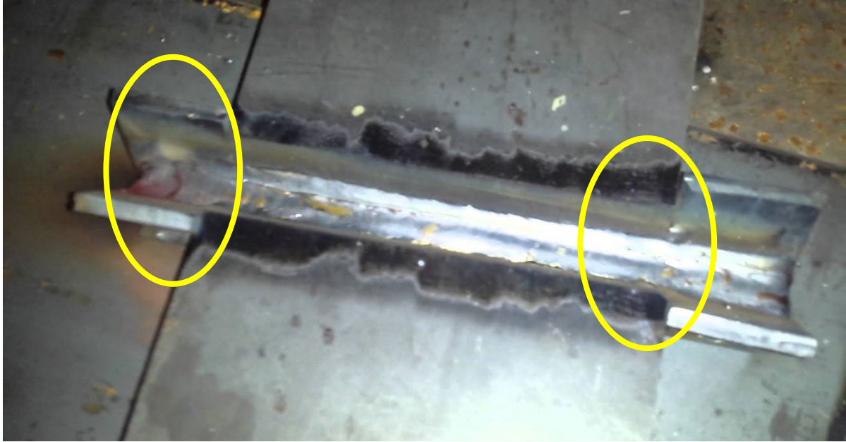
Ilustración 20 Uso de Weld Tabs
