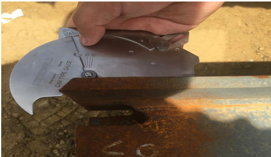
Ilustración 52 bisel incorrecto para el tipo de junta
