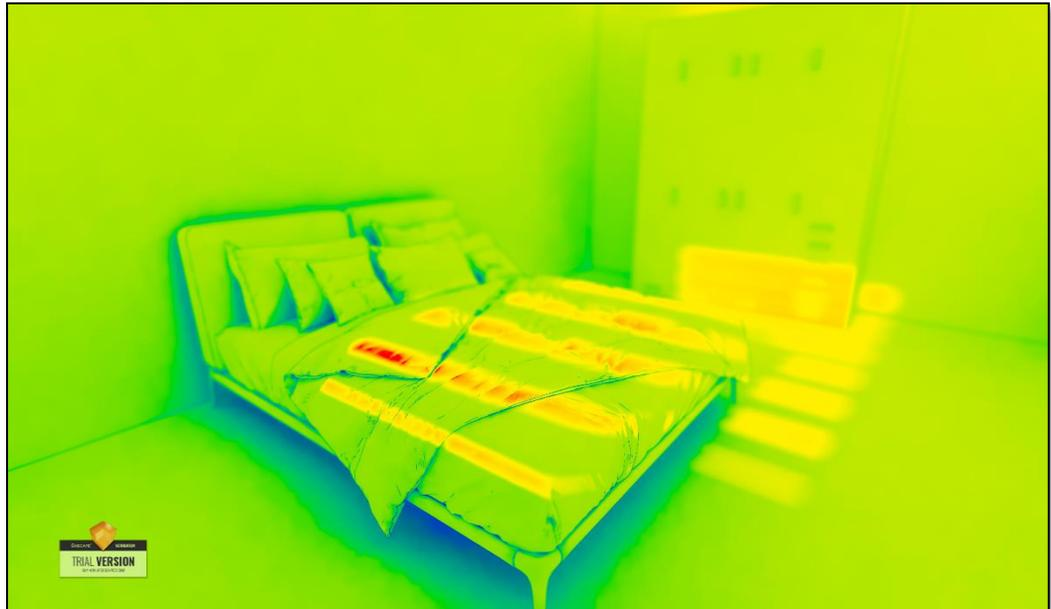
**Figura 68** Análisis de Luz Natural con Clasificación de Lux (sector: Dormitorio 2 – 17:00 hrs)
