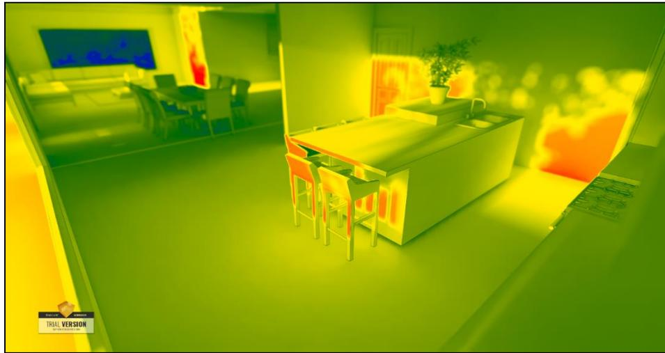
**Figura 63** Análisis de Luz natural con Clasificación de Lux (sectores: sala, comedor, cocina)
