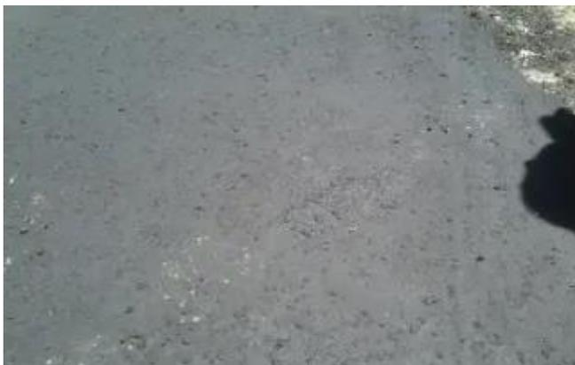
**Figura 6:** Exudación del ligante o asfalto llorado.
