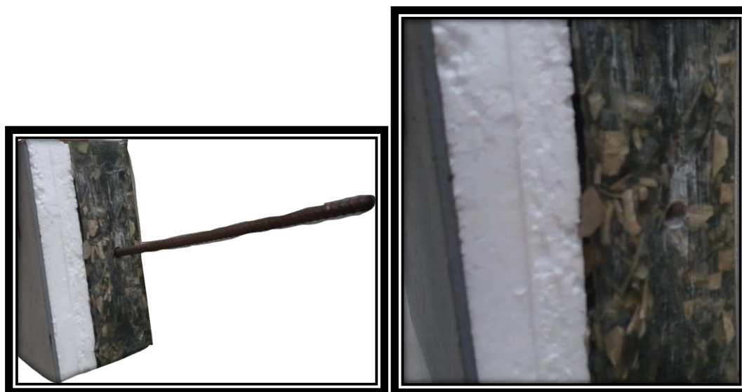
Imagen 64. Instalación del panel modular con varilla de hierro
