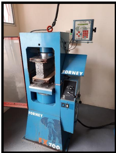
Imagen 77. Prueba a la compresión Elaborado por: Reyes & Villa (2021)
