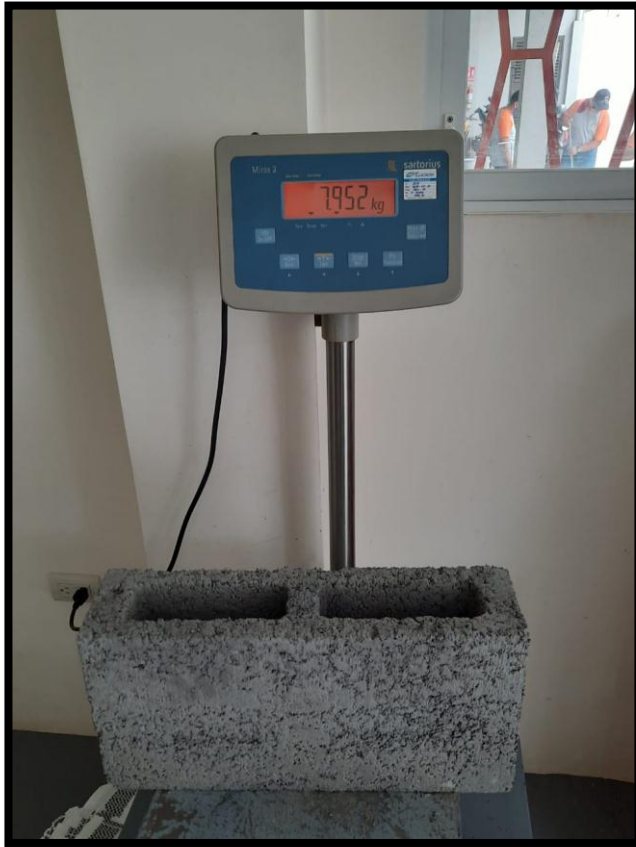
Imagen 86. Toma de peso en bloques Elaborado por: Reyes & Villa (2021)
