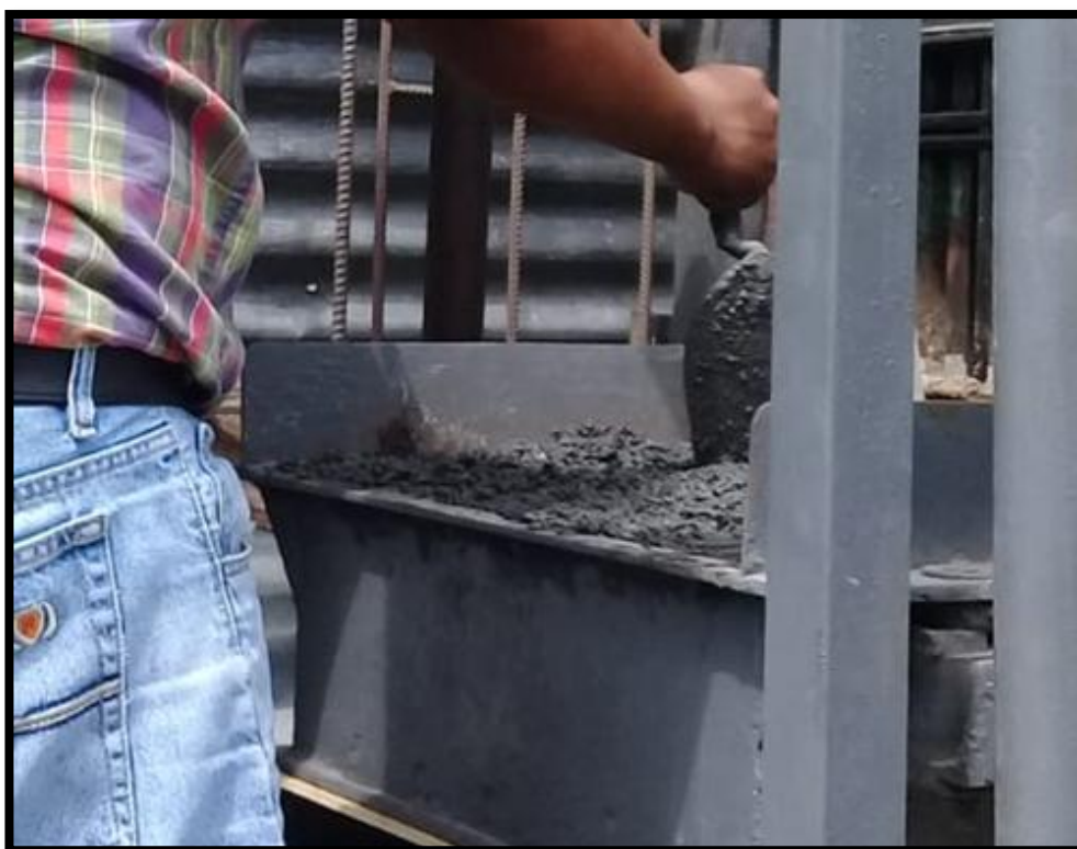
Imagen 67. Inclusión de mezcla en bloquera Elaborado por: Reyes & Villa (2021)
