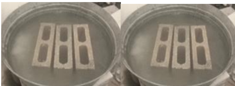
Imagen 85. Curado de bloques Elaborado por: Reyes & Villa (2021)
