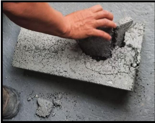
Imagen 68. Obtención de la muestra fallida Elaborado por: Reyes & Villa (2021)
