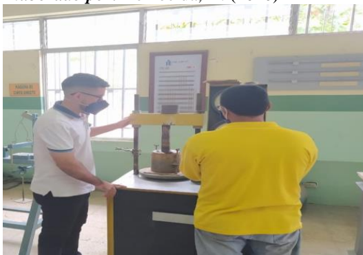
Figura 34. Ensayo de penetración C.B.R. Elaborado por: Lombeida, X. (2020)
