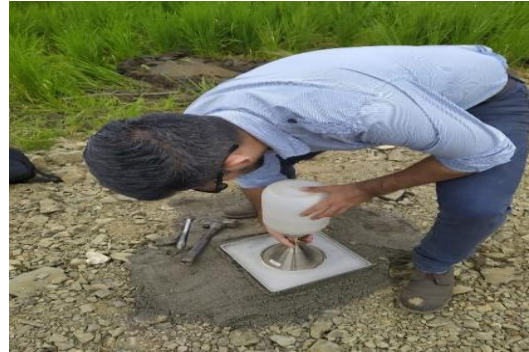
Figura 29. Densidad con cono y arena Elaborado por: Lombeida, X. (2020)
