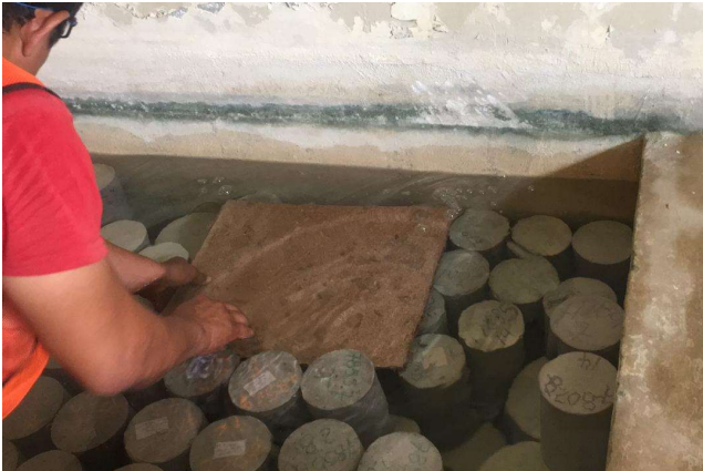
Figura 56. Prueba de absorción Elaborado por: Morales, A & Oviedo, I (2019)
