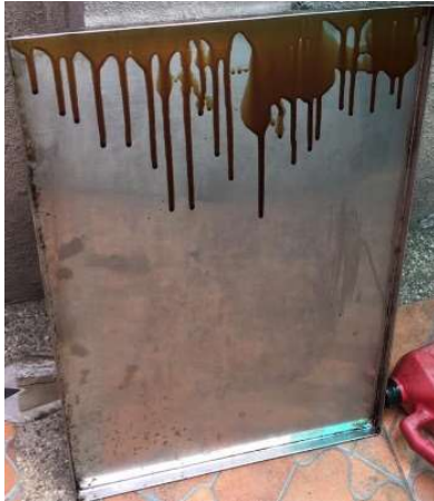
Figura 51. Encofrado metálico aceitoso Elaborado por: Morales, A & Oviedo, I (2019)
