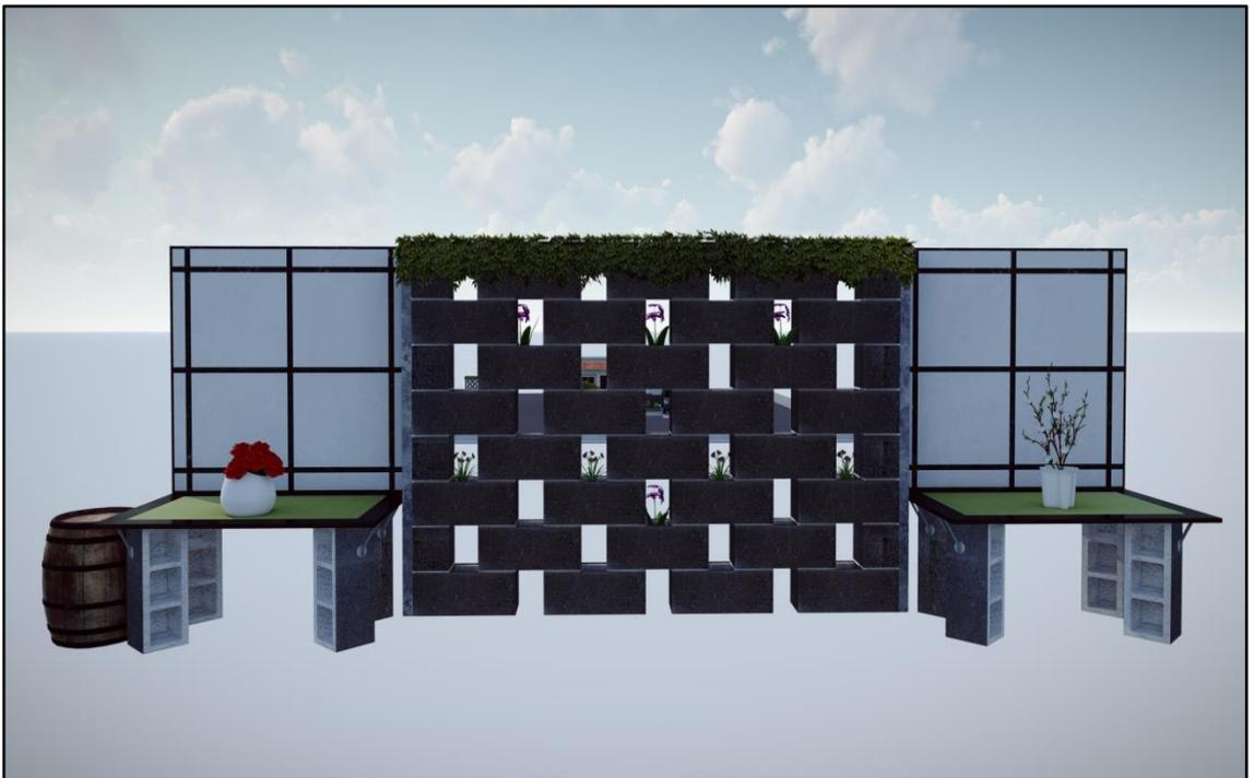
**Figura 93:** Mobiliarios elaborados con los bloques ecológicos (PET – PEAD y Cascarilla de Arroz).
