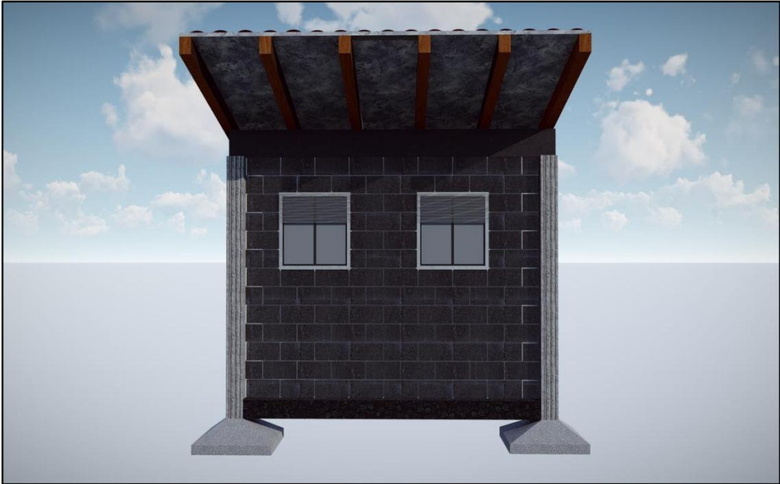
**Figura 86:** Mampostería en paredes con los bloques ecológicos (PET – PEAD y Cascarilla de Arroz).
