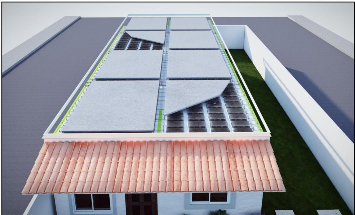
**Figura 89:** Cajonetas de la losa aligerada rellenas con los bloques ecológicos.
