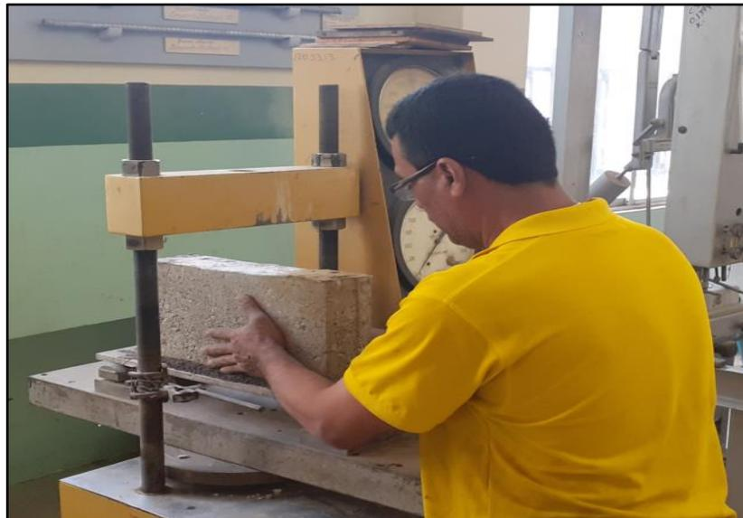
**Figura 82:** Bloques ecológicos ubicados en la máquina de rotura.
