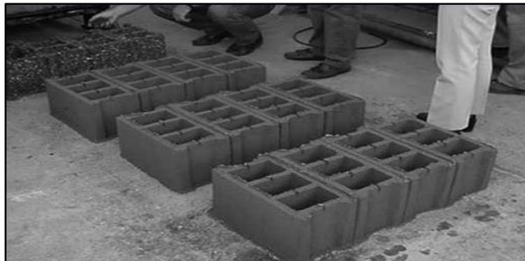
**Figura 1:** *Bloque de plástico reciclado.*
