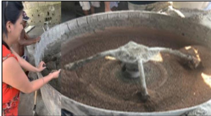
**Figura 61:** Mezcla de los materiales que componen el bloque ecológico.
