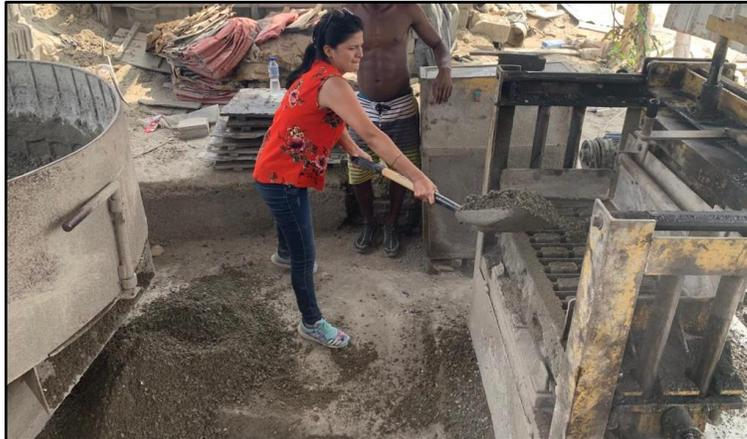
**Figura 63:** Compactación de la mezcla del bloque ecológico.
