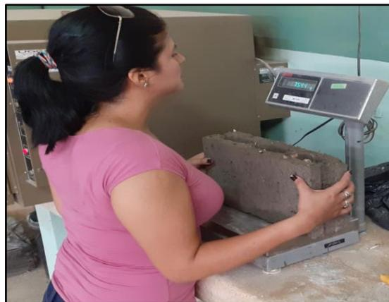
*Figura 78: Bloques húmedos siendo pesados.
