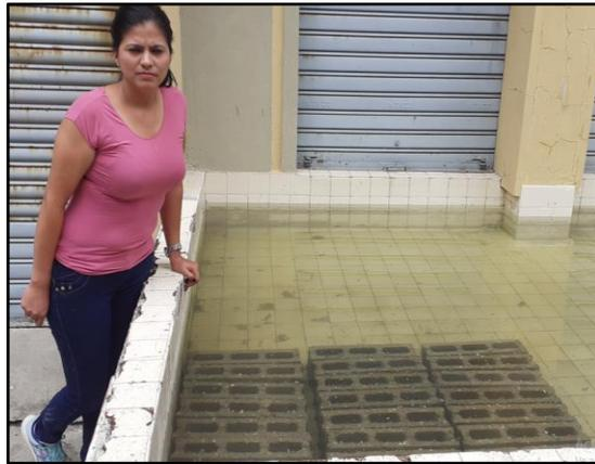
*Figura 77: Bloques ecológicos sumergidos por 24 horas.
