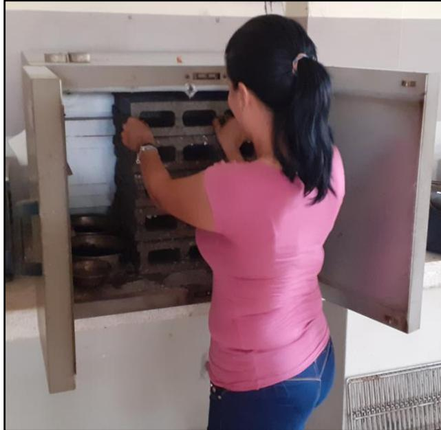
**Figura 79:** Bloques ecológicos secados por 24 horas.
