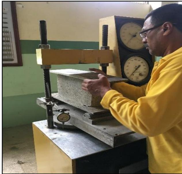
**Figura 83:** Placa metálica ubicada sobre el bloque ecológico.
