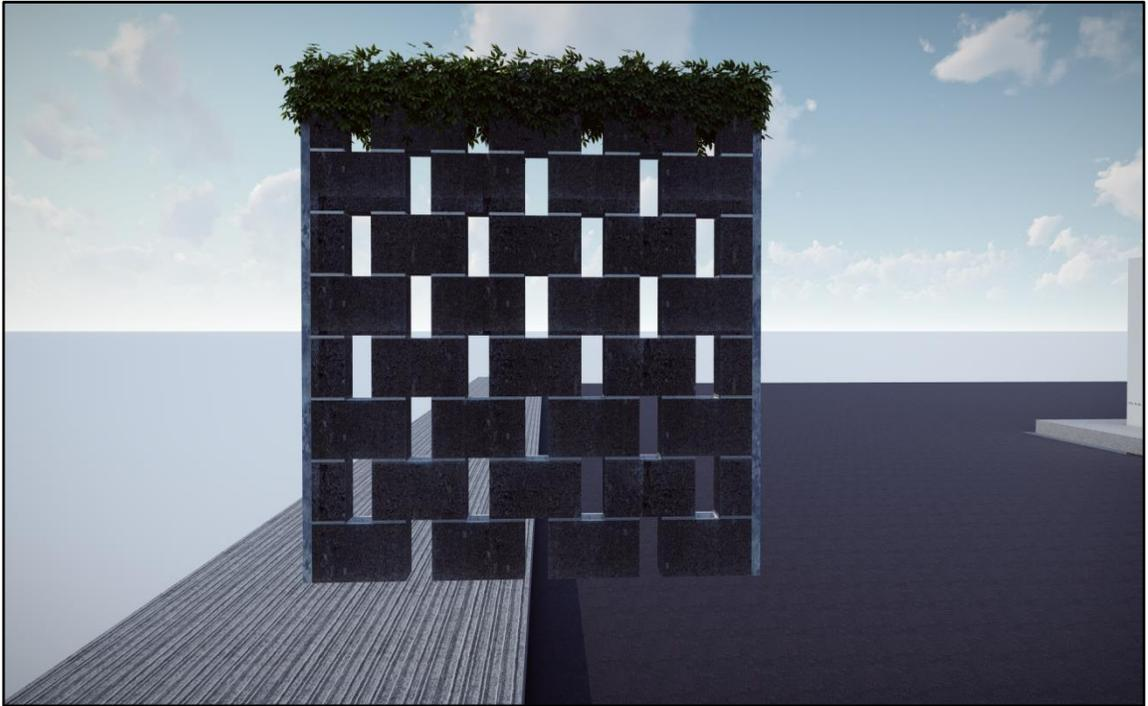
**Figura 92:** Pared ornamental construida con bloques ecológicos (PET – PEAD y Cascarilla de Arroz).
