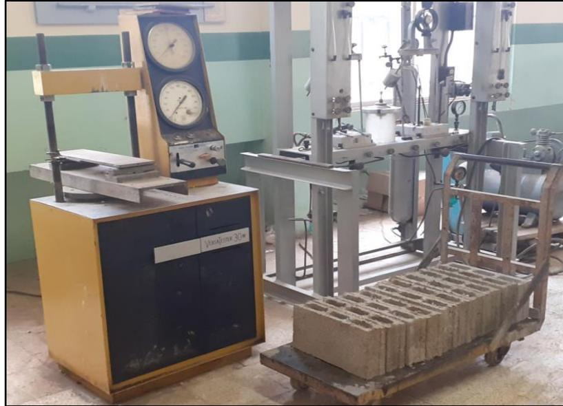
**Figura 81:** Bloques ecológicos y proceso de compresión.
