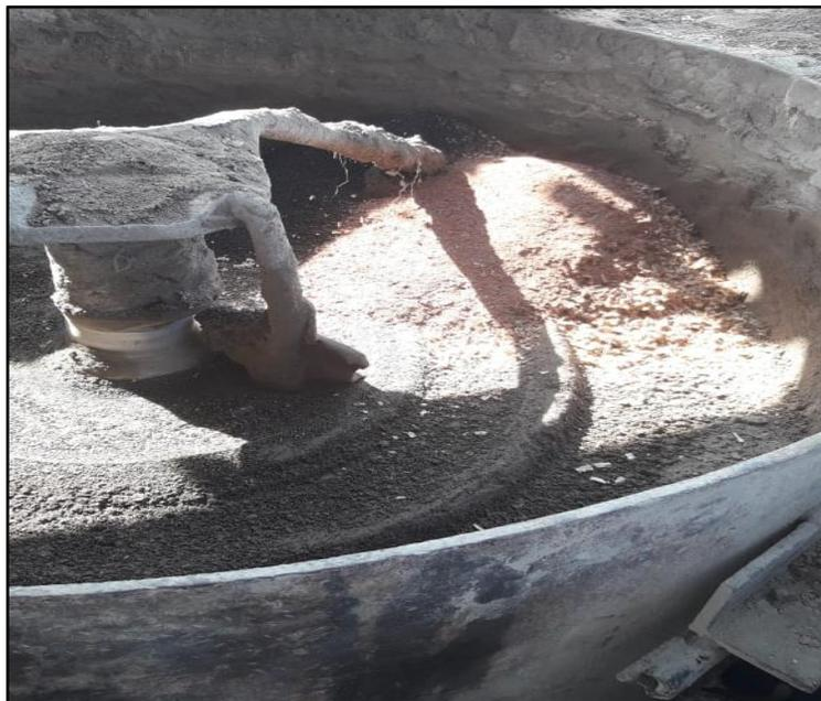
**Figura 56:** Cascarilla de arroz vertida en la mezcladora.
