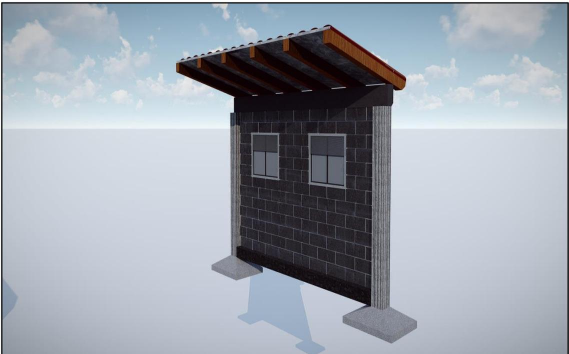
**Figura 87:** Perspectiva de pared construida con los bloques ecológicos (PET – PEAD y Cascarilla Arroz)
