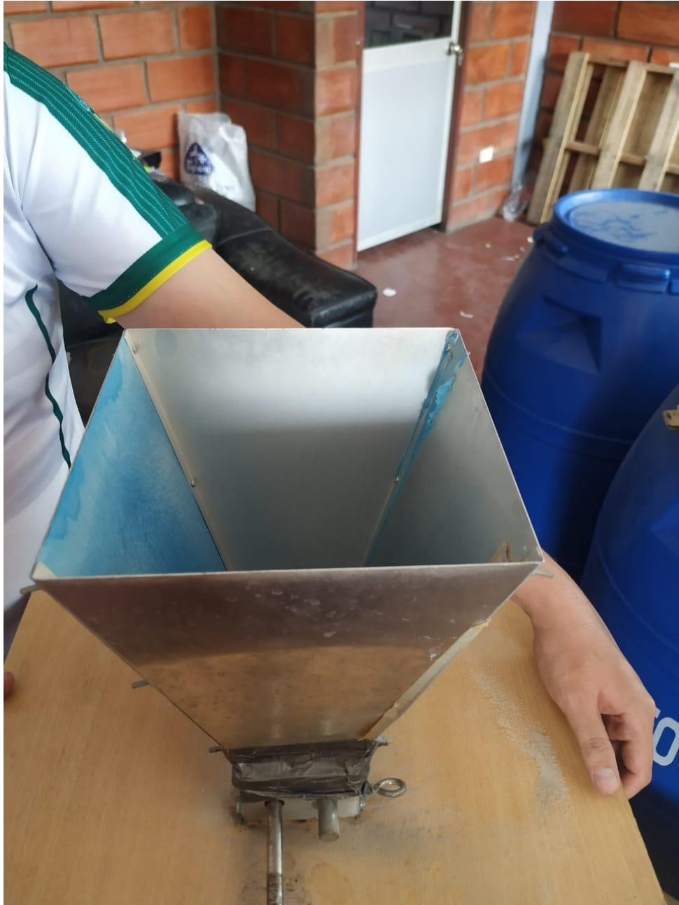
Foto 4. Molino de rodillos para moler la malta
