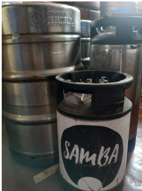
Foto 9. Tanques cornelios y tanques tipo A para cerveza artesanal Fuente: SAMBA Elaborado por: Solano, M. (2020)
