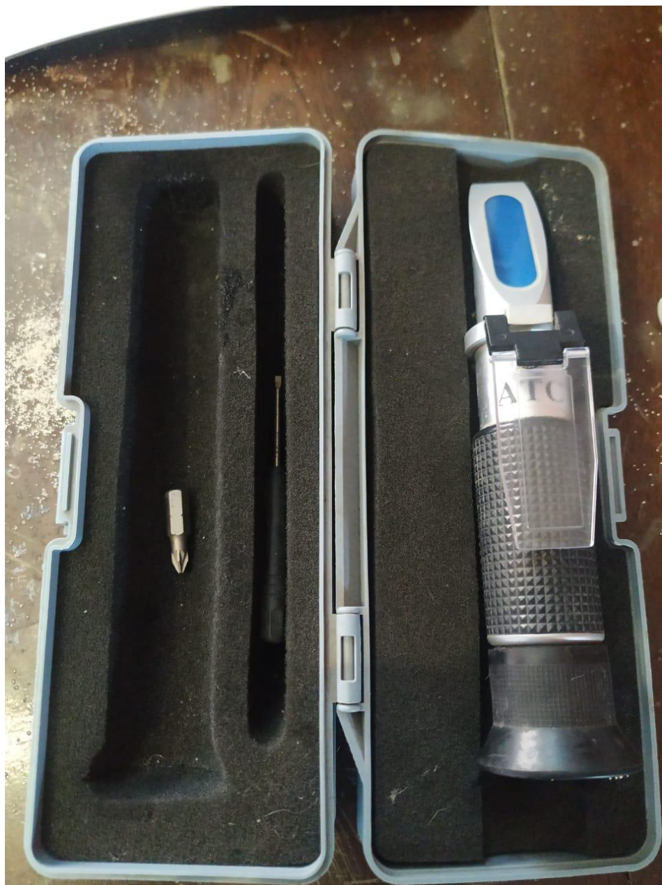
Foto 7. Reflectómetro para medir el alcohol de la elaboración de cerveza artesanal
