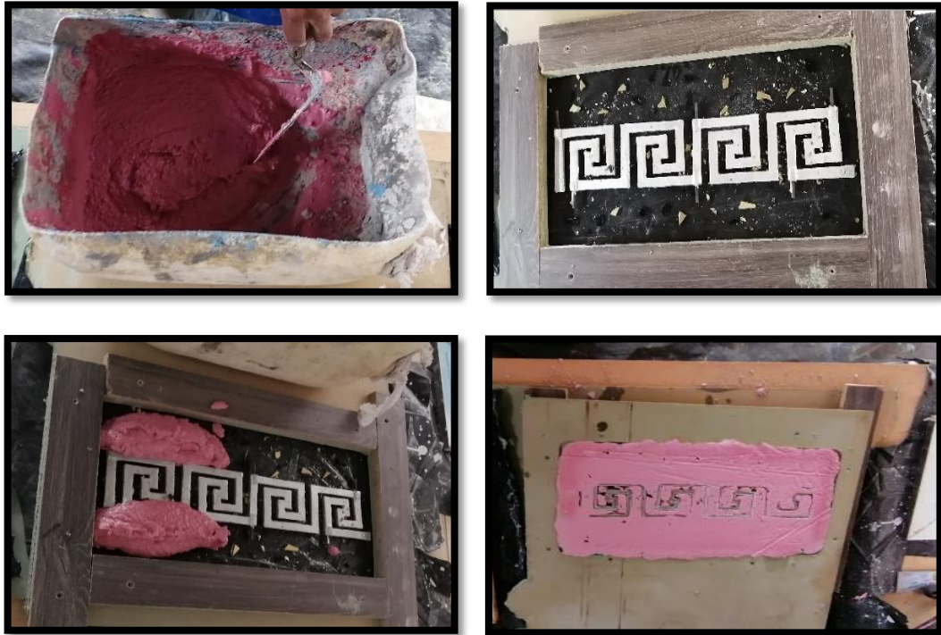
Figura 86. Incorporación de la mezcla del prototipo 3. Elaboración: Alvarado, J. (2019)
