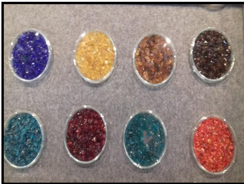
Figura 77. Triturado del vidrio. Elaboración: Alvarado, J. (2019)
