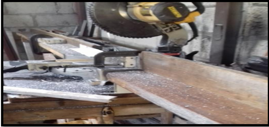
Figura 78. Corte del aluminio. Elaboración: Alvarado, J. (2019)
