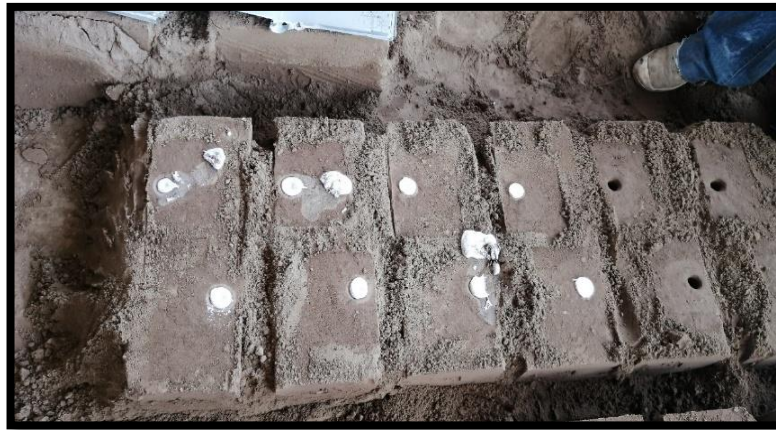
Figura 70. Molde para fundido de aluminio. Elaboración: Alvarado, J. (2019)
