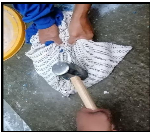
Figura 72. Trituración de vidrio con combo. Elaboración: Alvarado, J. (2019)
