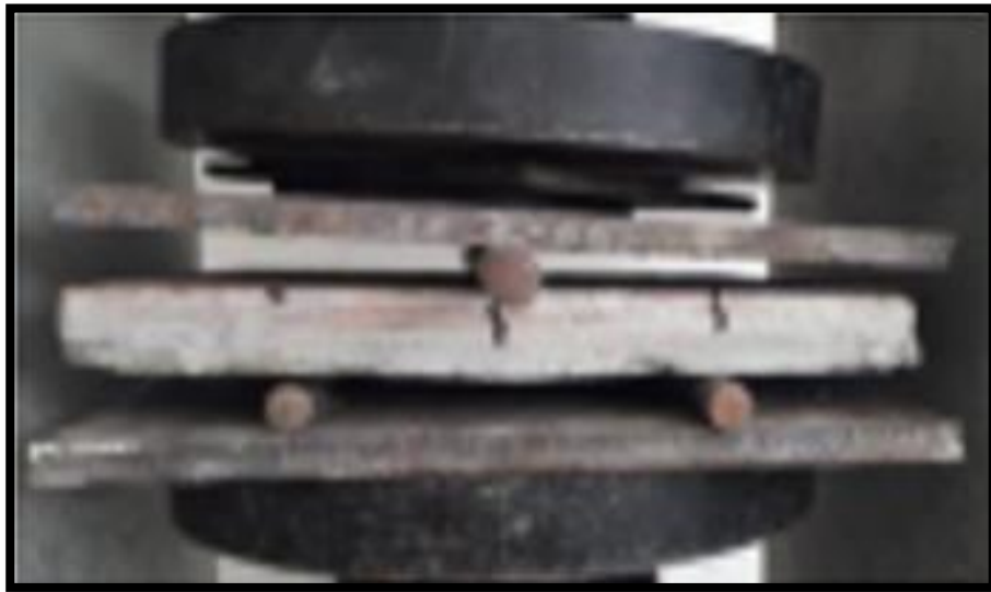
Figura 96. Ensayo de Flexión Elaboración: Alvarado, J. (2019)
