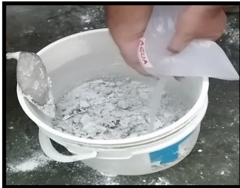
Figura 75. Mezcla de cemento blanco, marmolina, cuarzo, agua, vidrio y aluminio reciclado Elaboración: Alvarado, J. (2019)
