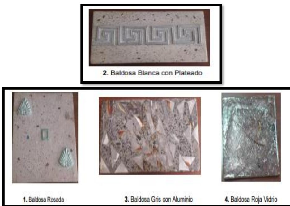
Figura 95. Muestras Ensayos de Absorción. Elaboración: Alvarado, J. (2019)
