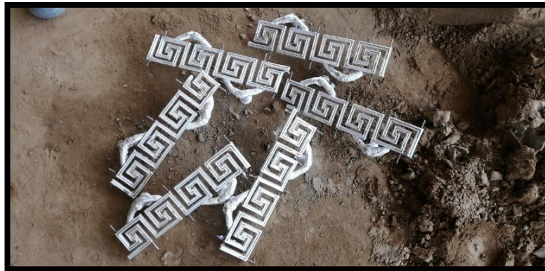
Figura 71. Pieza de aluminio fundido. Elaboración: Alvarado, J. (2019)
