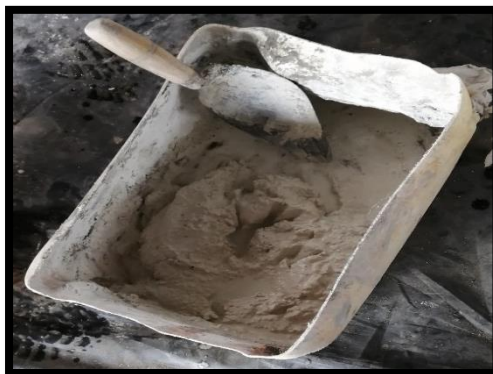
Figura 76. Mezcla de cemento gris, arena, piedra chispa, agua, vidrio y aluminio reciclado Elaboración: Alvarado, J. (2019)
