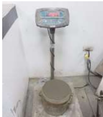
Figura 26 Ensayo de densidad del hormigón en estado fresco
