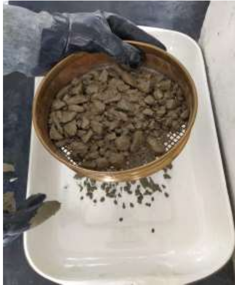
Figura 29 Tamizado en húmedo del concreto por la malla No. 4 (4,75 mm) Tomada por: (Salvatierra, 2020)
