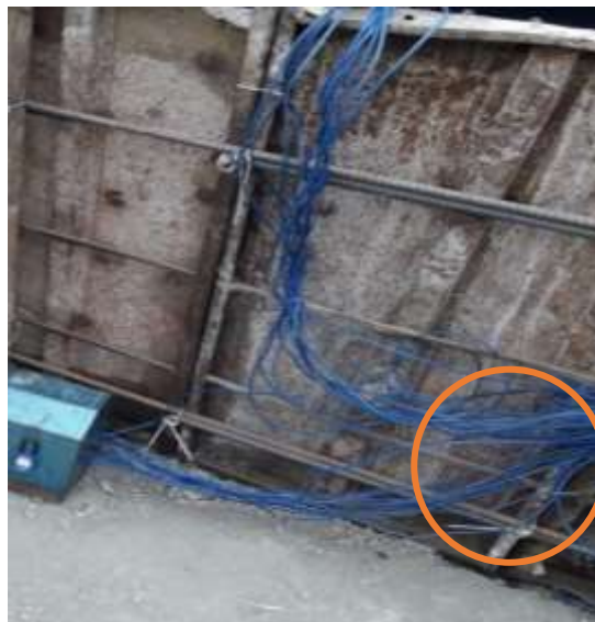
Figura 19 Termocupla para temperatura ambiente Tomada por: (Salvatierra, 2020)
