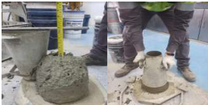
Figura 25 Ensayo de asentamiento Tomada por: (Salvatierra, 2020)
