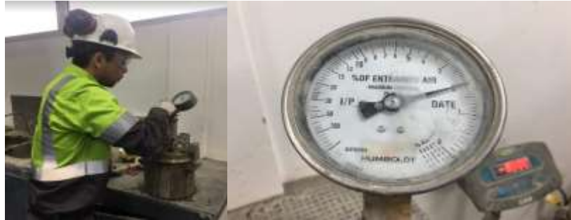
Figura 27 Ensayo de contenido de aire del hormigón en estado fresco Tomada por: (Salvatierra, 2020)
