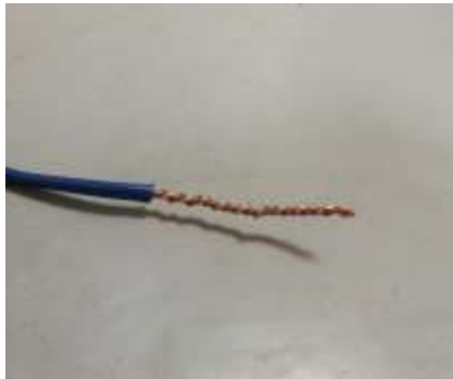
Figura 11 Extremo de Cable Termocupla colocada en Hormigón Tomada por: (Salvatierra, 2020)
