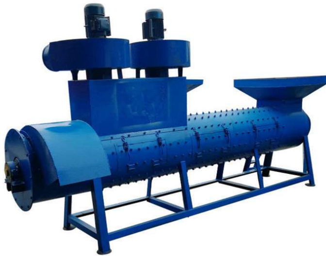
Figura 3: Máquina removedor de etiquetas. Fuente: (HUIAO, s.f.)
